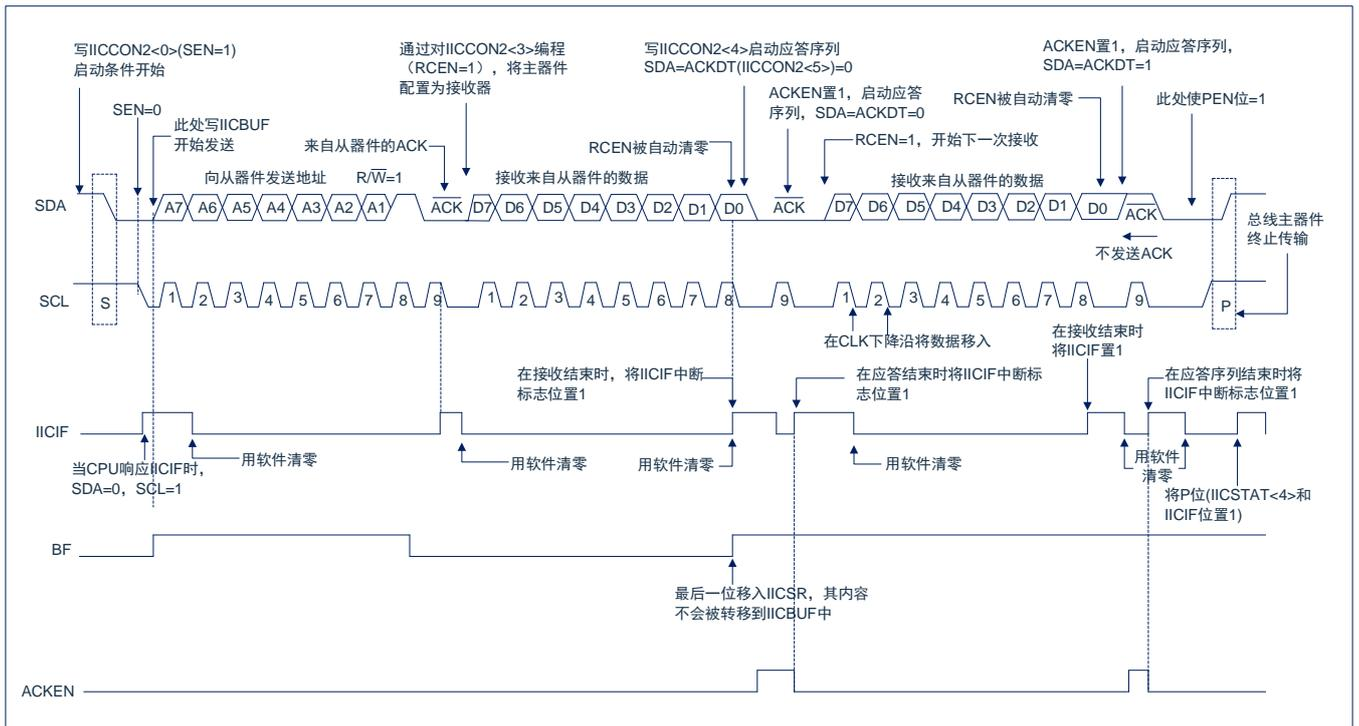
图20-6: I<sup>2</sup>C™主控模式接收时序
