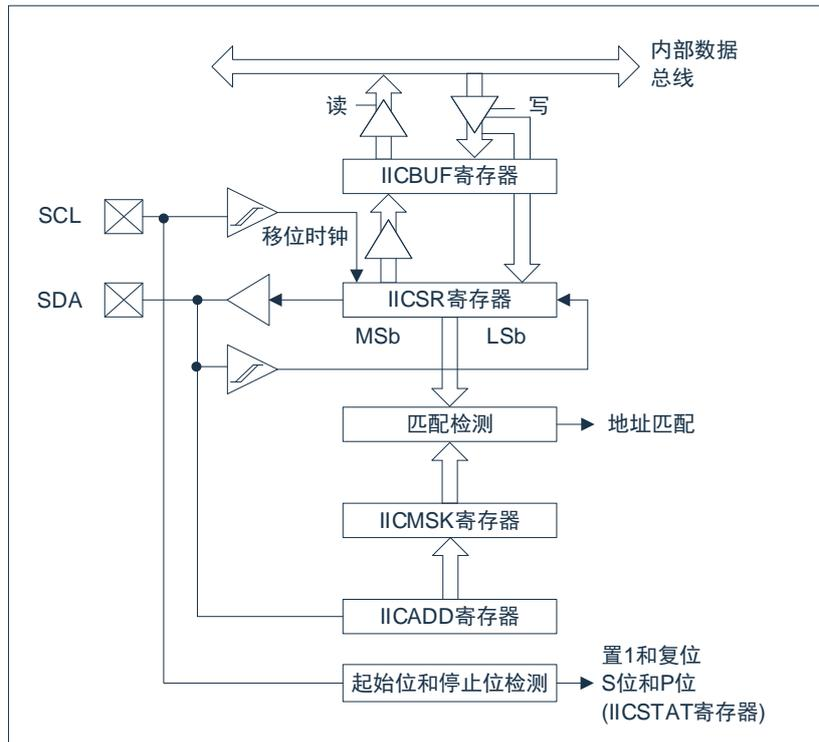
图 20-1: IIC 框图 (I<sup>2</sup>C 模式)
