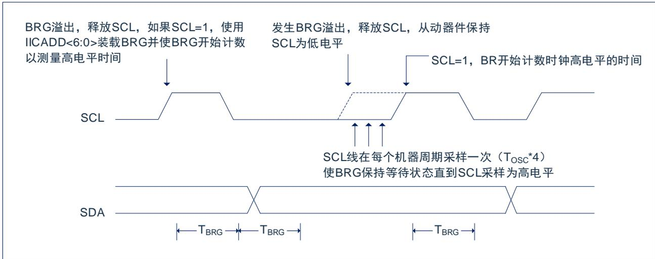
图 20-11：主控发送模式下的时钟仲裁时序
