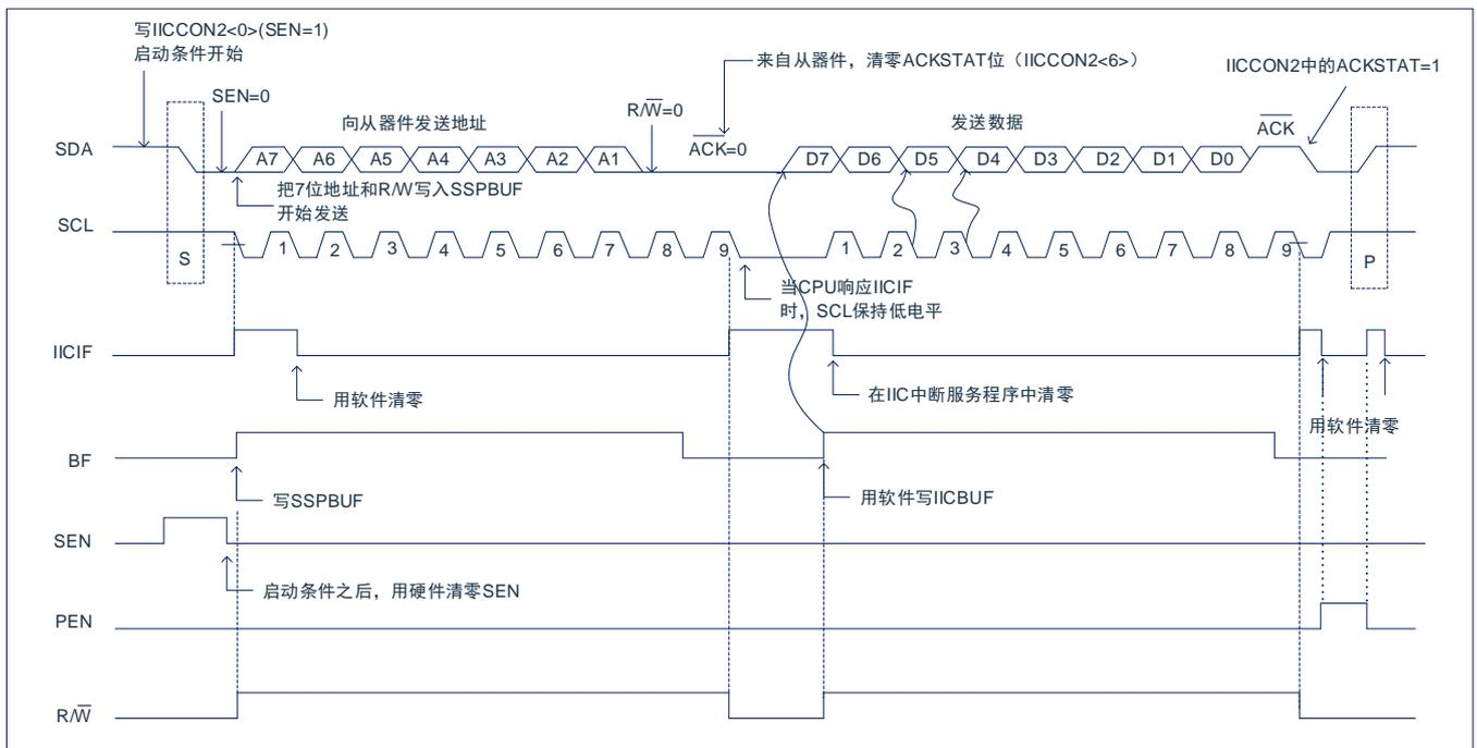
图20-5: I<sup>2</sup>C™主控模式发送时序
