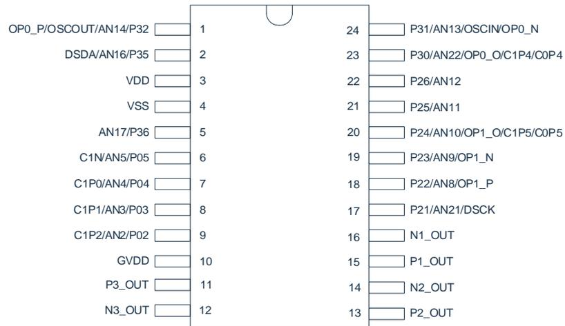
**3.1.2 CMS8M3524 引脚图 (SSOP24)**
