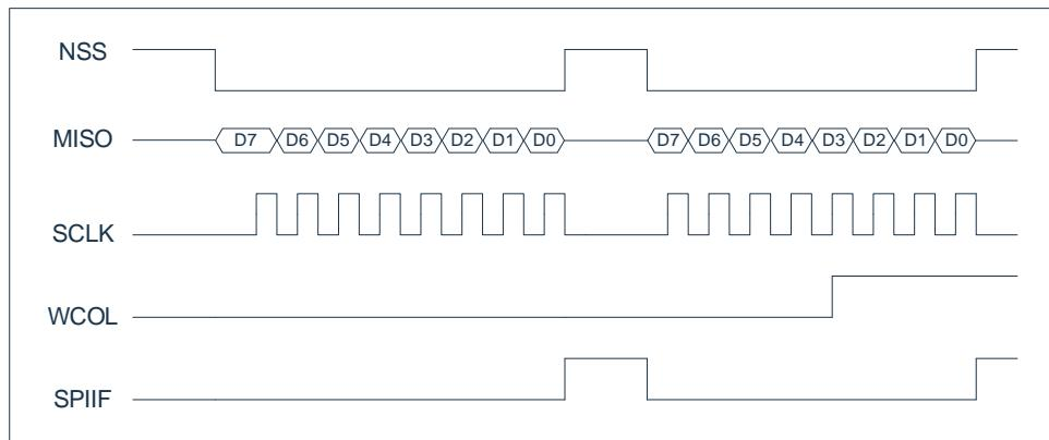
以防 CPHA 被清除，WCOL 生成也可由任一 NSS 线清零时 SPDR 寄存器写入引起，此时 SPI 主机没有生成串行时钟 SCLK 也可以完成。这是因为没有明确指定传输开始，并且在全字节传输后 NSS 被驱动为低电平可能指示下一个字节传输的开始。当 NSS 传输线为低电平、时钟相位 CPHA = 0 时，写 SPDR 导致写冲突错误如下图所示：
