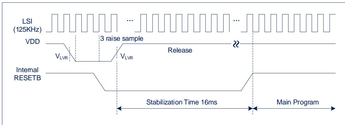
稳定时间（Stabilization Time）内芯片重新进行配置过程，与上电复位配置过程相同。
