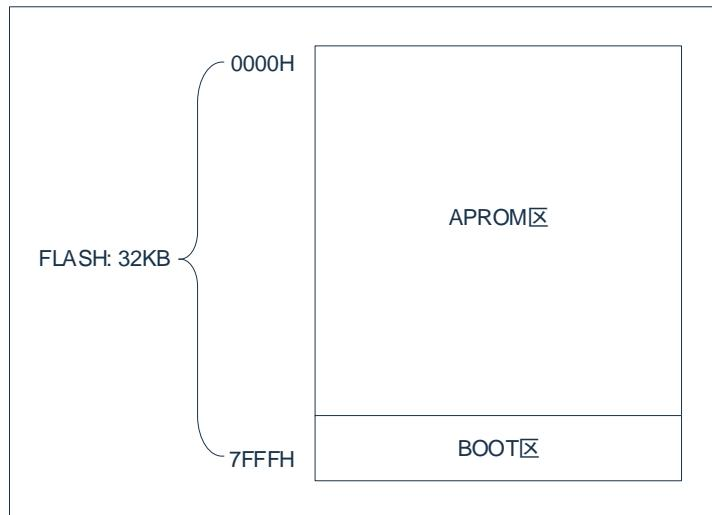
芯片复位后，CPU 从 0000H 开始执行。每个中断在程序存储器中都分配有固定的地址，中断使 CPU 跳到该地址开始执行服务程序。
