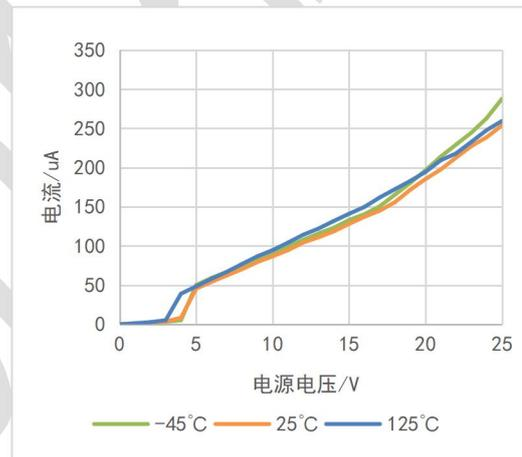
图 7-4: VBS 动态电流随电源电压变化曲线
