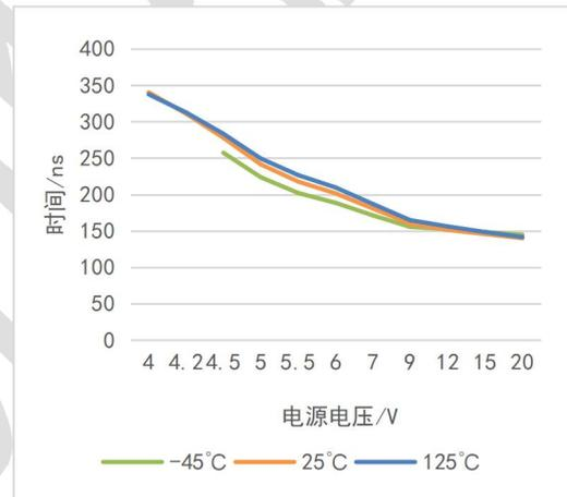
图 7-10：低边开启传输时间随电源电压变化曲线
