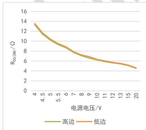
图 7-5: PMOS  $R_{DS(ON)}$  随电源电压变化曲线
