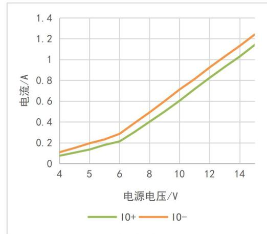
图 7-8：低边短路脉冲电流随电源电压变化曲线
