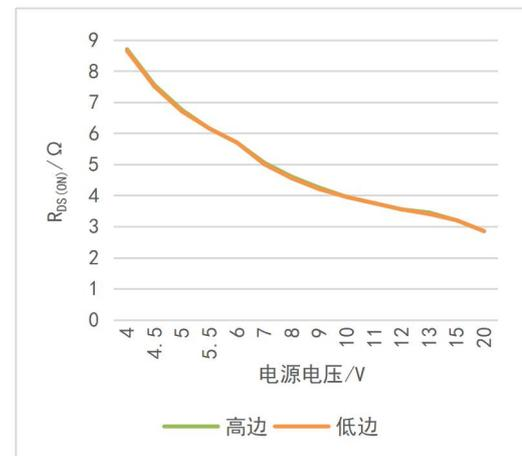
图 7-6: NMOS  $R_{DS(ON)}$  随电源电压变化曲线
