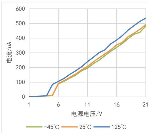
图 7-3: VCC 动态电流随电源电压变化曲线
