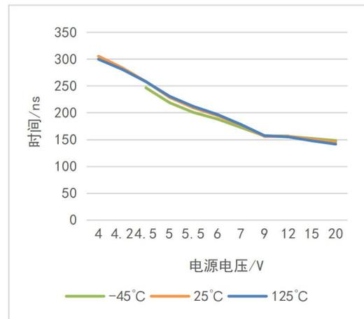
图 7-12：低边关闭传输时间随电源电压变化曲线
