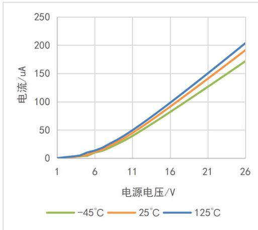
图 7-1: VCC 静态电流随电源电压变化曲线
