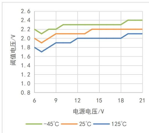
图 7-15: 输入正阈值随电源电压变化曲线
