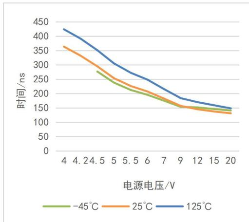
图 7-9：高边开启传输时间随电源电压变化曲线
