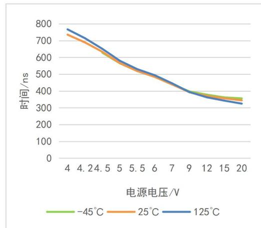
图 7-14: 死区时间 (L0-H0) 随电源电压变化曲线
