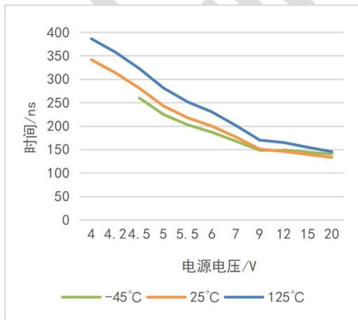
图 7-11：高边关闭传输时间随电源电压变化曲线
