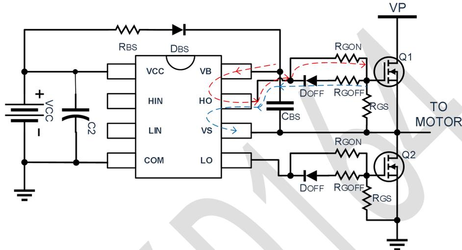
图 9-2：栅极输出驱动电路示意图
