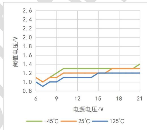
图 7-16: 输入负阈值随电源电压变化曲线
