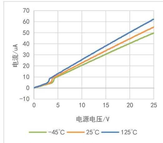
图 7-2: VBS 静态电流随电源电压变化曲线
