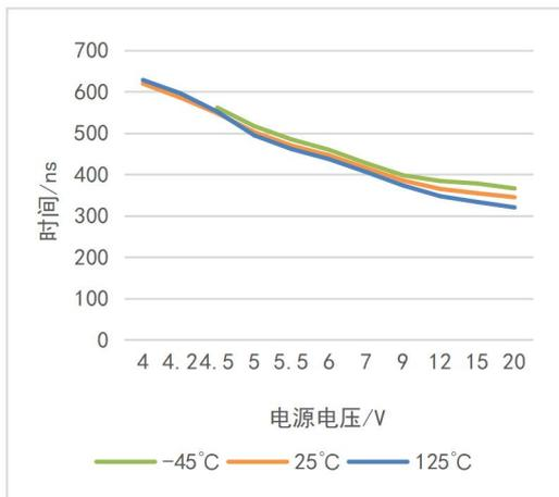
图 7-13: 死区时间 (H0-L0) 随电源电压变化曲线
