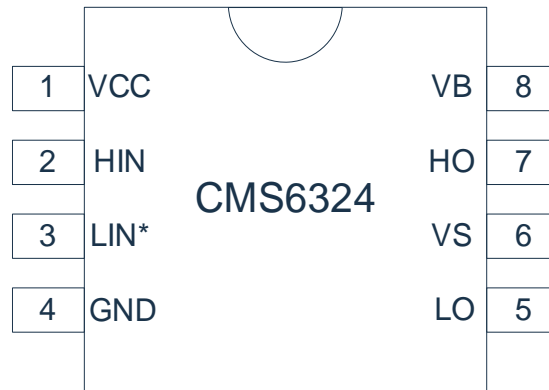
图 2-1: CMS6324 引脚示意
