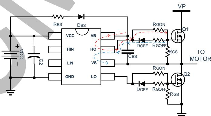
图 8-2：棚极输出驱动电路示意
