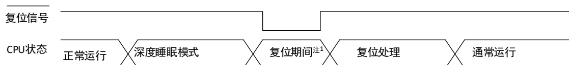
图25-5 通过复位解除部分掉电的深度睡眠模式
