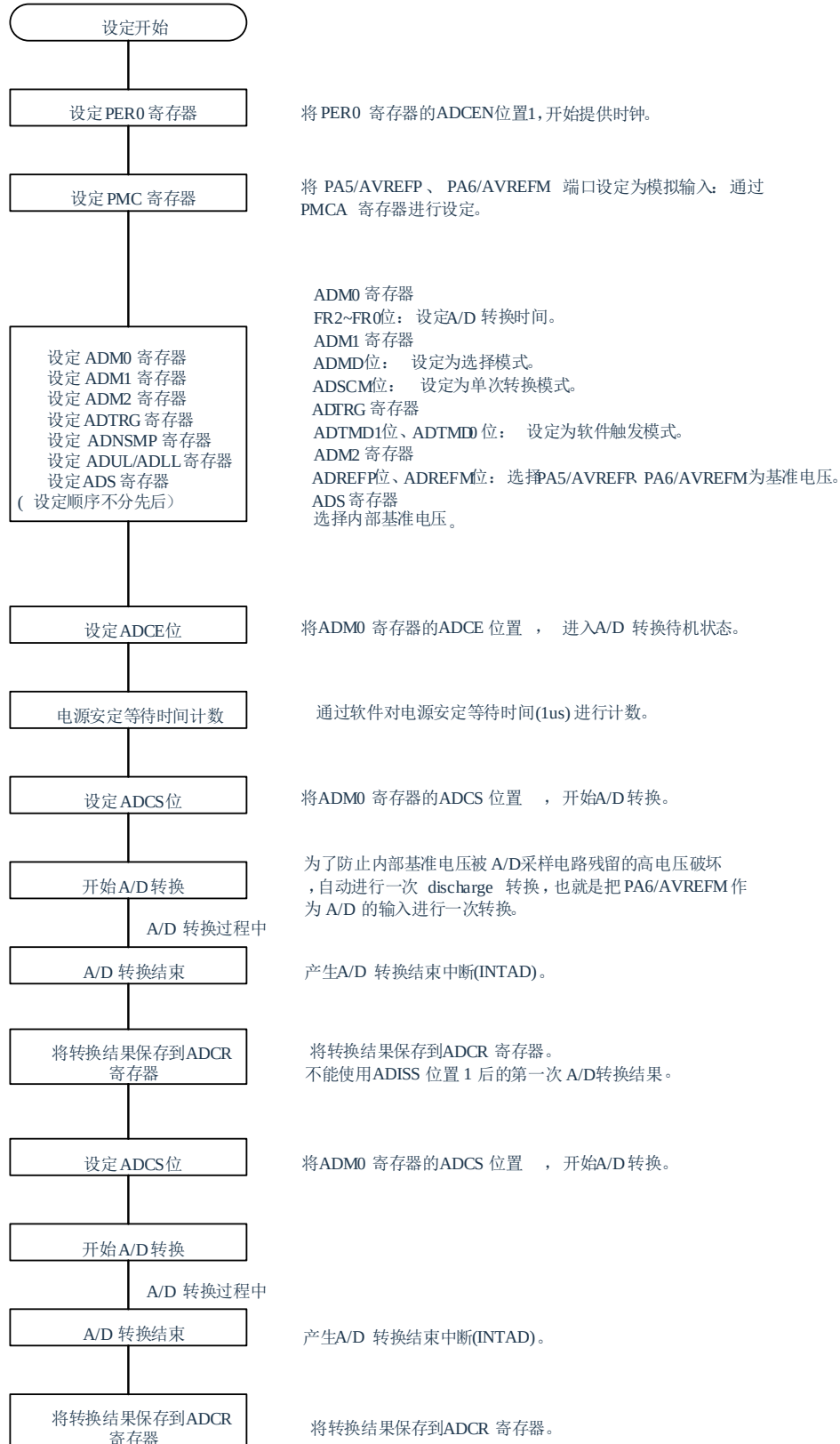
图16-21 选择内部基准电压时的设置
