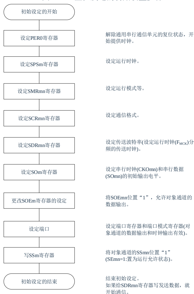
图 13-5: 主控发送的初始设置步骤
