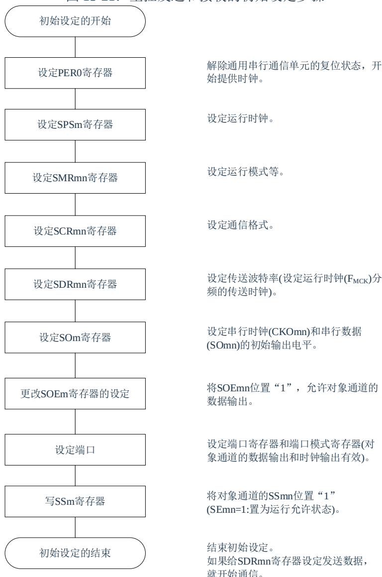
图 13-21: 主控发送和接收的初始设定步骤
