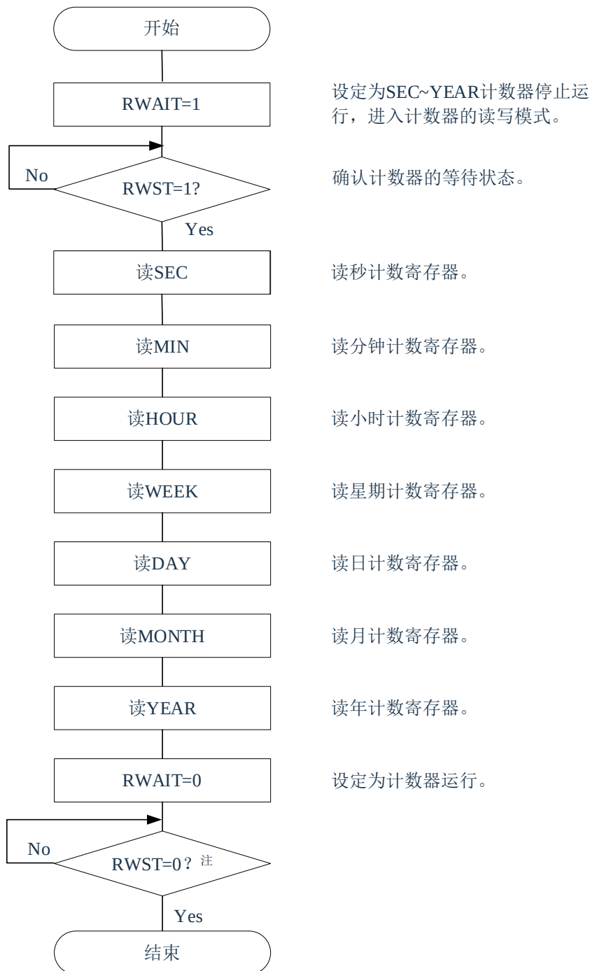
图8-4 实时时钟计数器的读操作步骤
