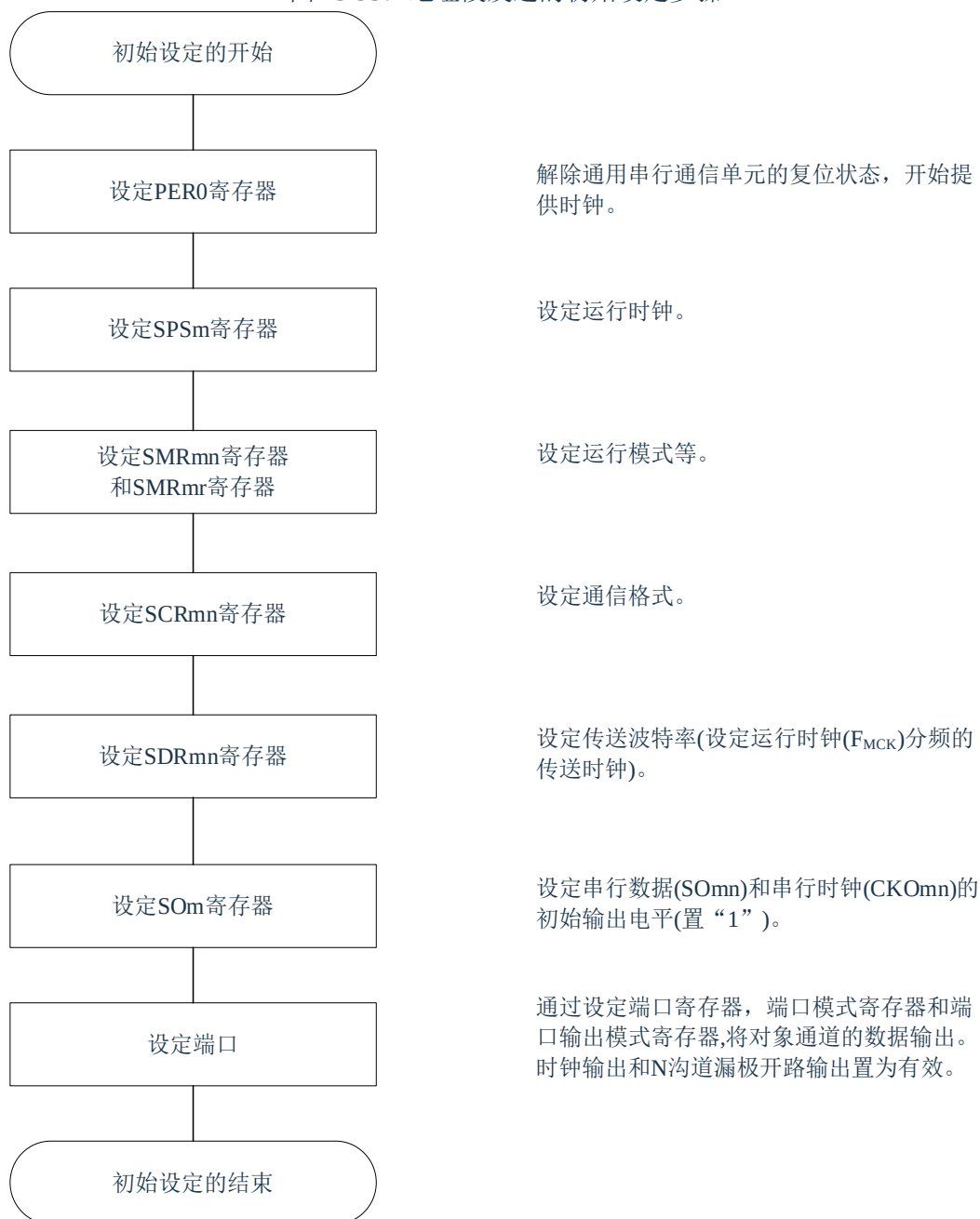
图 13-95: 地址段发送的初始设定步骤
