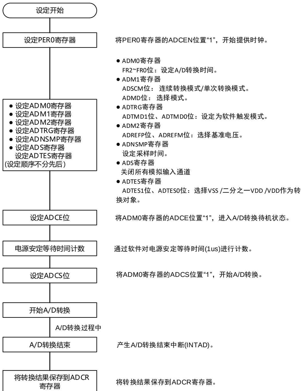
图16-22 测试模式的设置(VSS/half_VDD/VDD作为转换对象)
