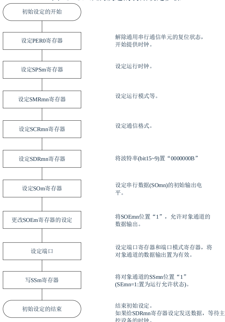
图 13-29: 从属发送的初始设定步骤
