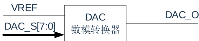
图 18-1: DAC 结构框图
