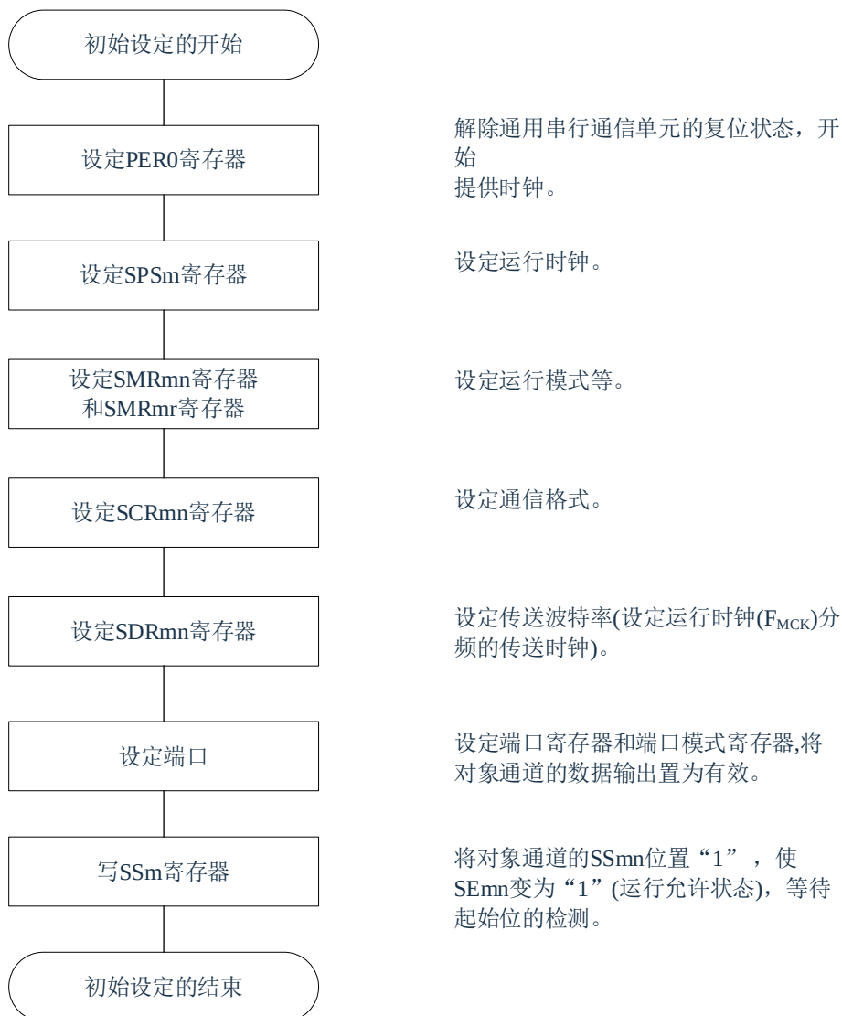
图 13-83: UART 接收的初始设定步骤
