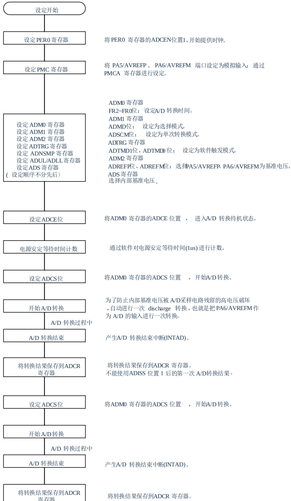
图16-21 选择内部基准电压时的设置
