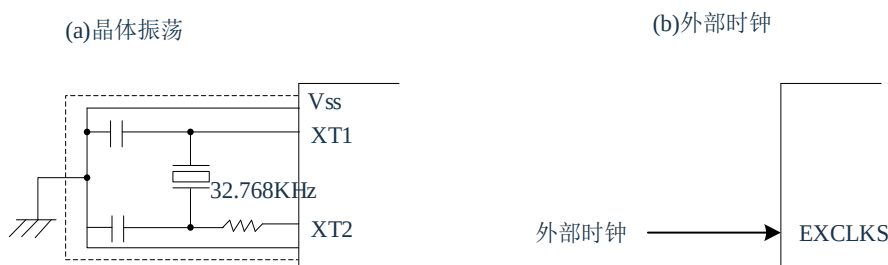
图4-3XT1振荡电路的外接电路例子
