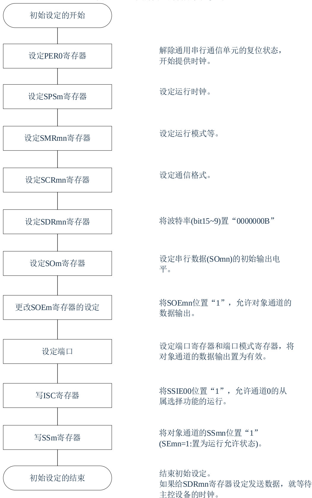
图 13-53: 从属发送的初始设定步骤
