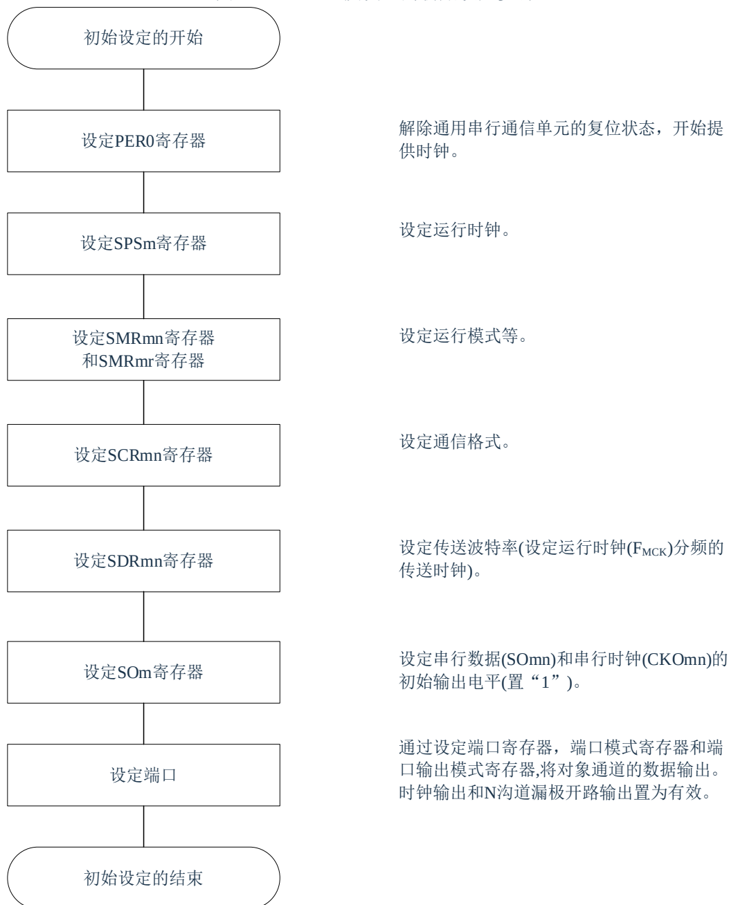
图 13-95: 地址段发送的初始设定步骤
