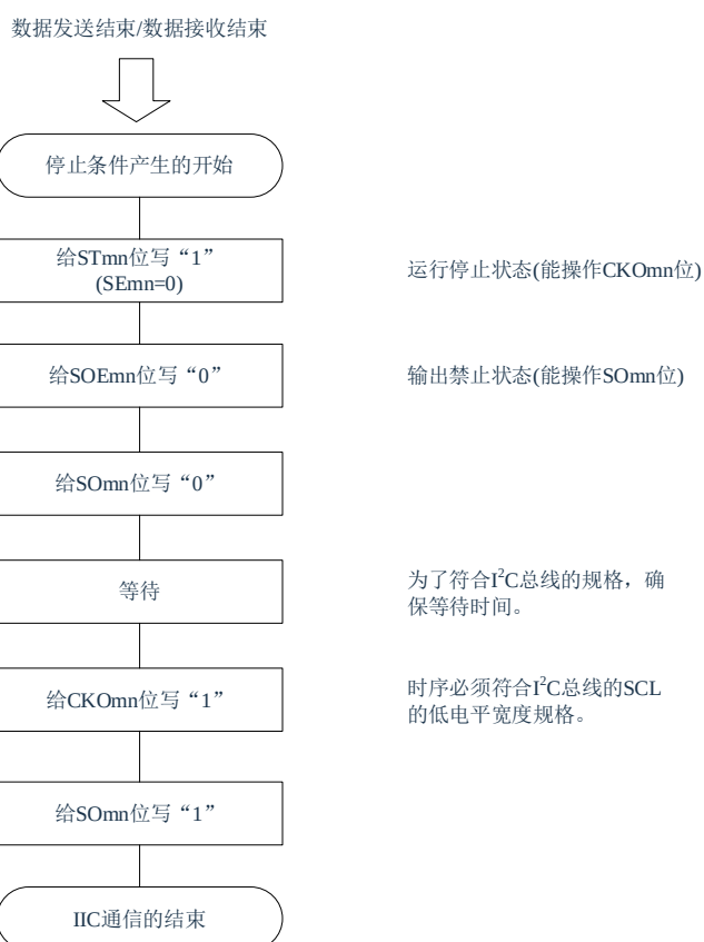
图 13-105：产生停止条件的流程图
