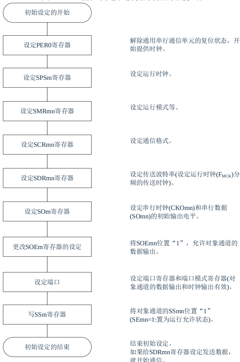
图 13-21: 主控发送和接收的初始设定步骤
