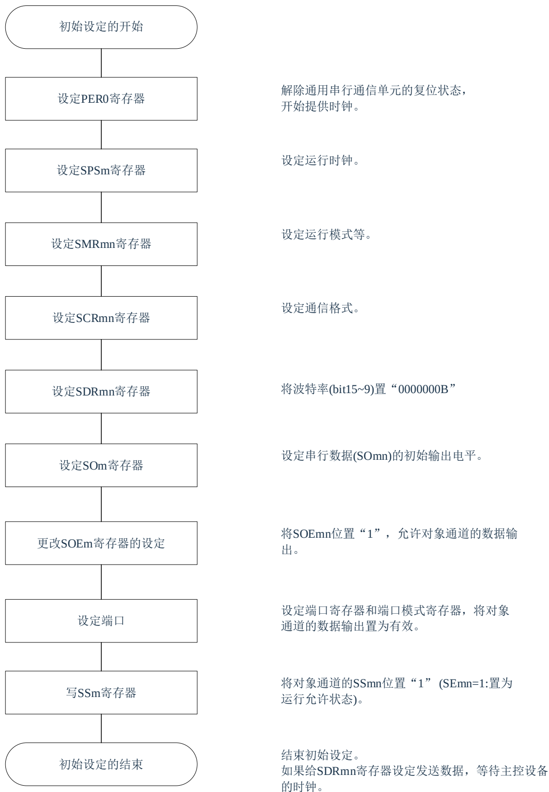
图 13-43: 从属发送和接收的初始设定步骤
