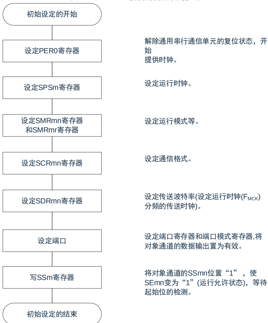
图12-83: UART 接收的初始设定步骤
