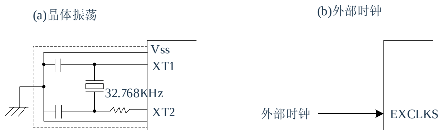
图 4-2 XT1 振荡电路的外接电路例子
