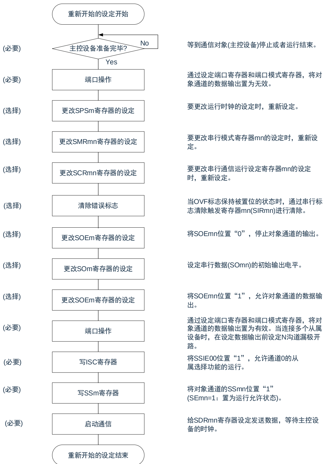
图12-69：重新开始从属发送和接收的设定步骤
