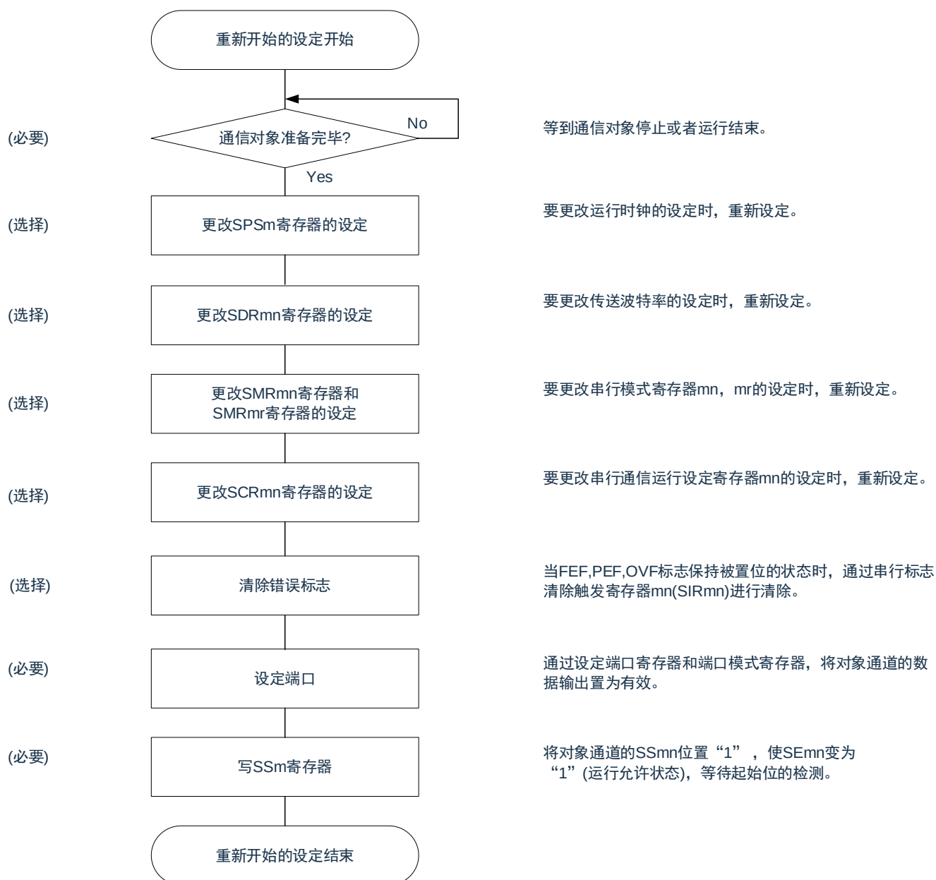
图12-85：重新开始 UART 接收的设定步骤
