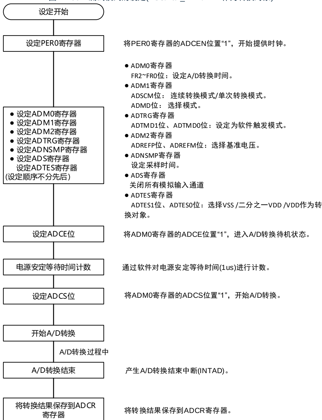
图 11-36 测试模式的设定(VSS/half_VDD/VDD作为转换对象)
