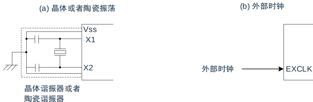
图4-13：X1振荡电路的外接电路例子
