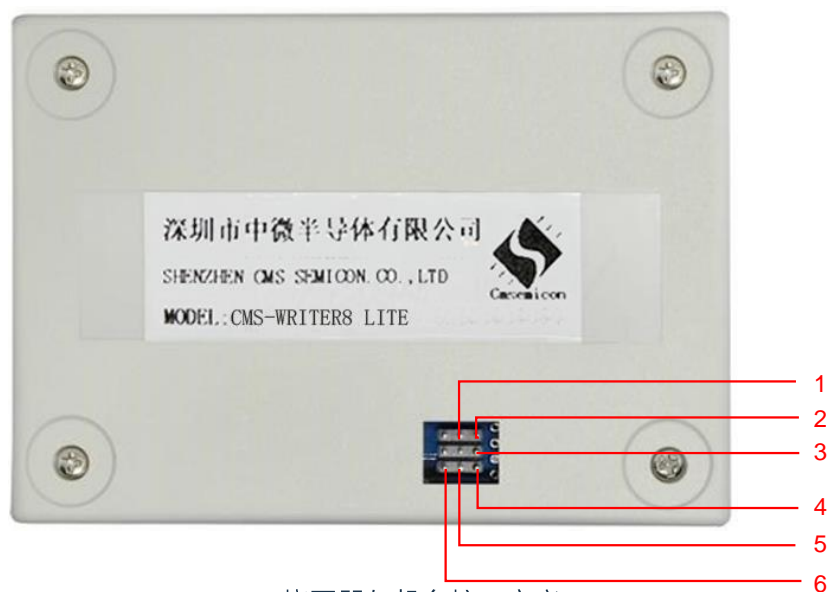
图 4-1：烧写器与机台接口定义
