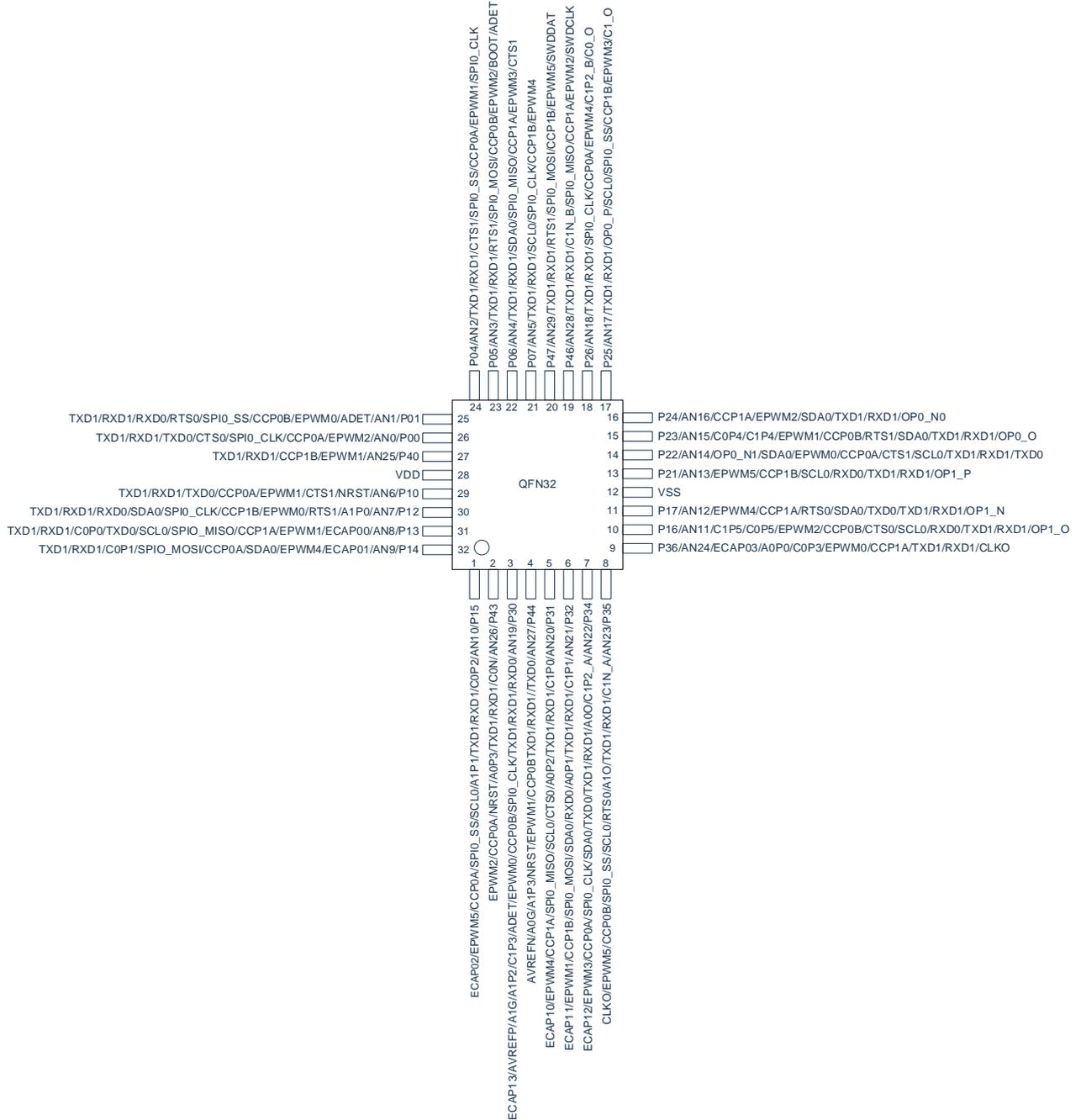
注：引脚图中所有引脚都可以映射为 TXD1 和 RXD1 功能。
