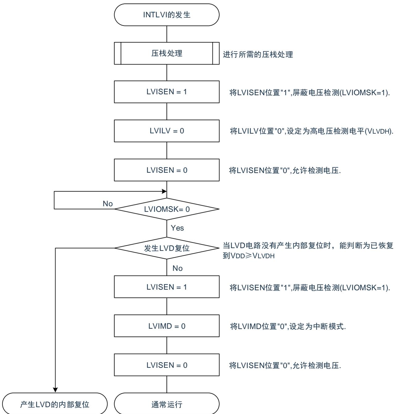
如果设定中断&复位模式 (LVIMDS1、LVIMDS0=1、0)，就在解除 LVD 复位 (LVIRF=1) 后需要 400us 或者 5 个 FIL 时钟的电压检测稳定等待时间。必须在等待电压检测稳定后将 LVIMD 位清“0”进行初始化。在电压检测稳定等待时间的计数过程中以及在改写 LVIMD 位时，必须将 LVISEN 位置“1”，屏蔽 LVD 产生的复位或者中断的产生。
