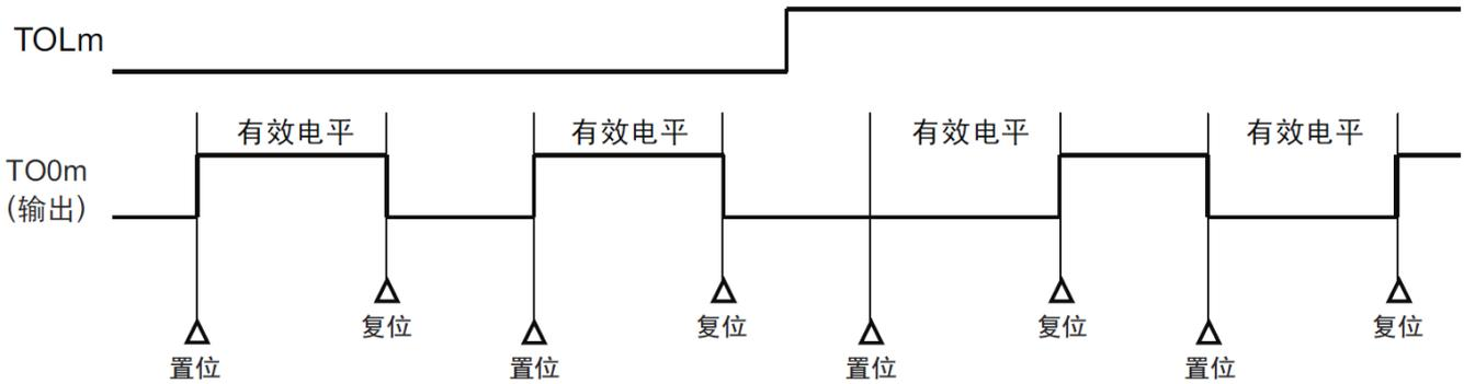
注1: 置位: TOMn引脚的输出信号从无效电平变为有效电平。
