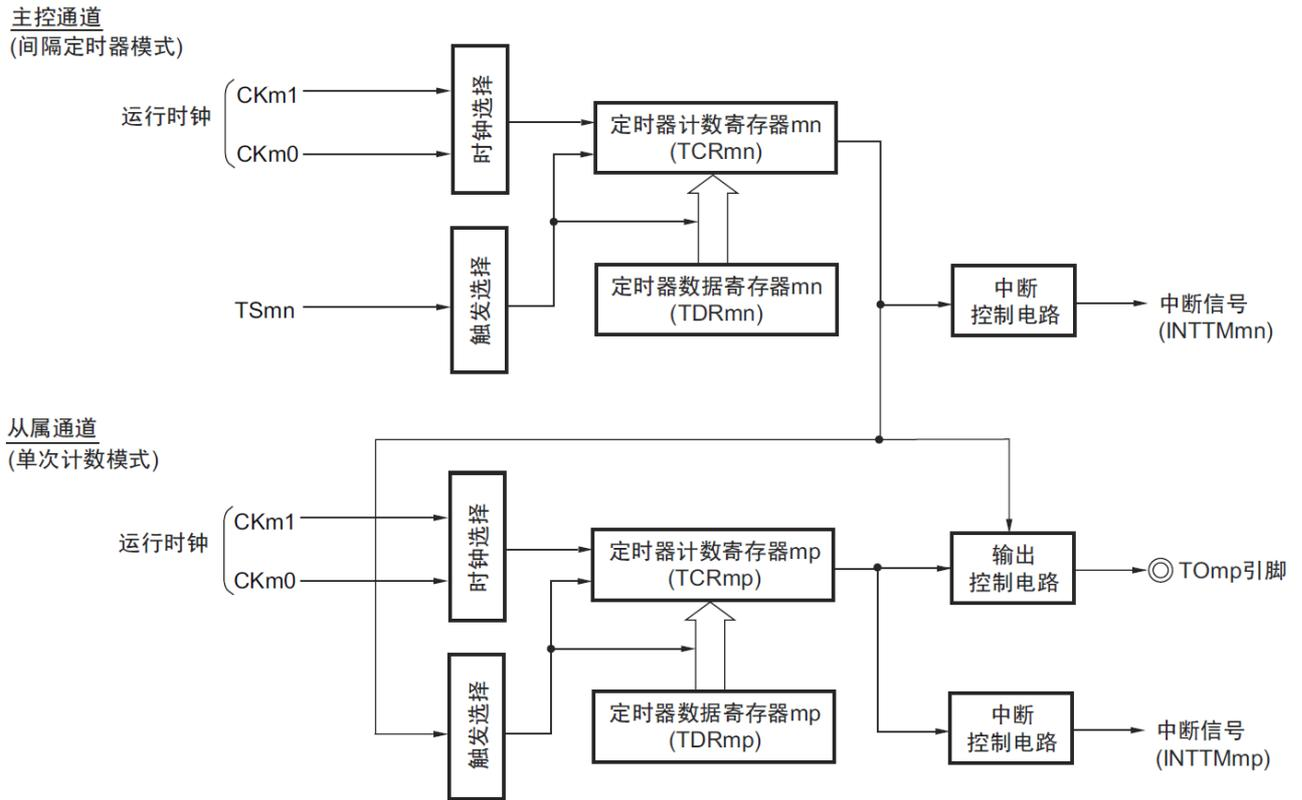
注：m：单元号 (m=0) n：主控通道号 (n=0、2) p：从属通道号 (n=0: p=1、2、3, n=2: p=3)
