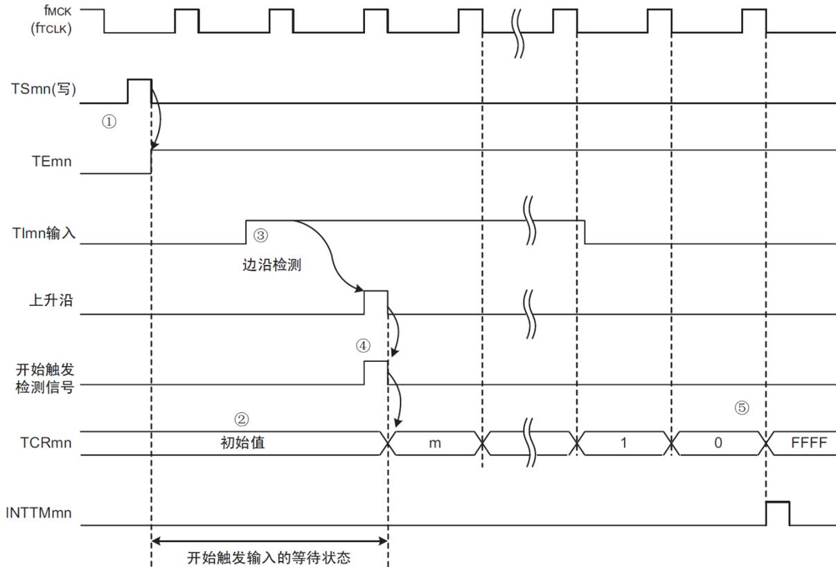
注1：不使用噪声滤波器时的时序。如果使用噪声滤波器，边沿检测就从TImn输入开始再延迟2个fMCK周期（合计3~4个周期）。1个周期的误差是因为TImn输入与计数时钟（fMCK）不同步。
