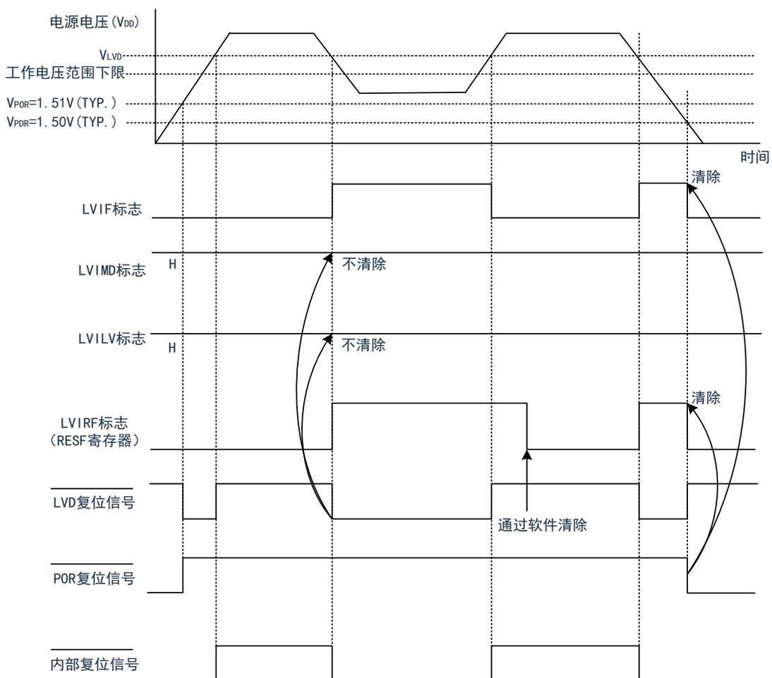
注：VPOR：POR电源电压上升检测电压
