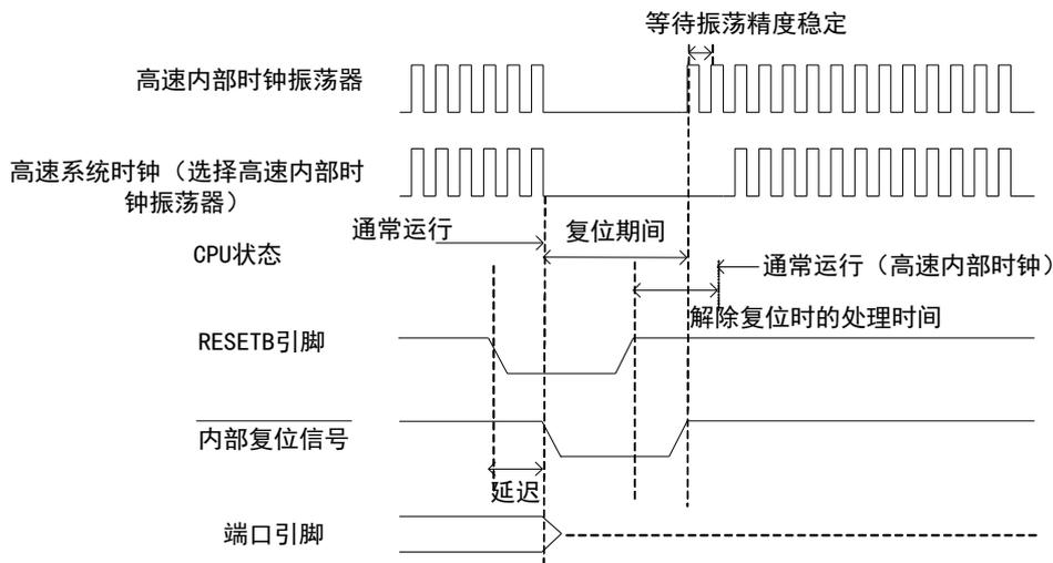
对于因看门狗定时器的上溢、系统复位请求位的置位或者非法存储器存取检测而产生的复位，自动解除复位状态，在复位处理结束后以高速内部振荡器时钟开始执行程序。
