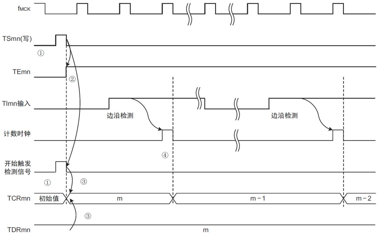
注: 这是不使用噪声滤波器时的时序。如果使用噪声滤波器, 边沿检测就从 TI<sub>mn</sub> 输入开始再延迟 2 个 fMCK 周期 (合计 3~4 个周期)。1 个周期的误差是因为 TI<sub>mn</sub> 输入与计数时钟 (fMCK) 不同步。
