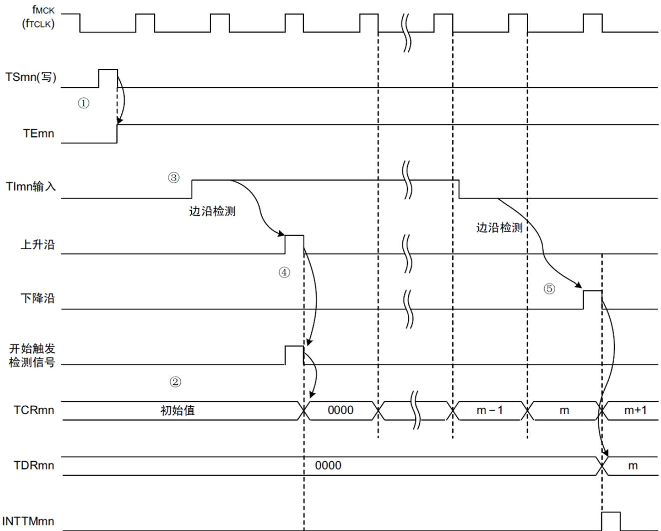
注：不使用噪声滤波器时的时序。如果使用噪声滤波器，边沿检测就从TImn输入开始再延迟2个fMCK周期（合计3~4个周期）。1个周期的误差是因为TImn输入和计数时钟（fMCK）不同步。
