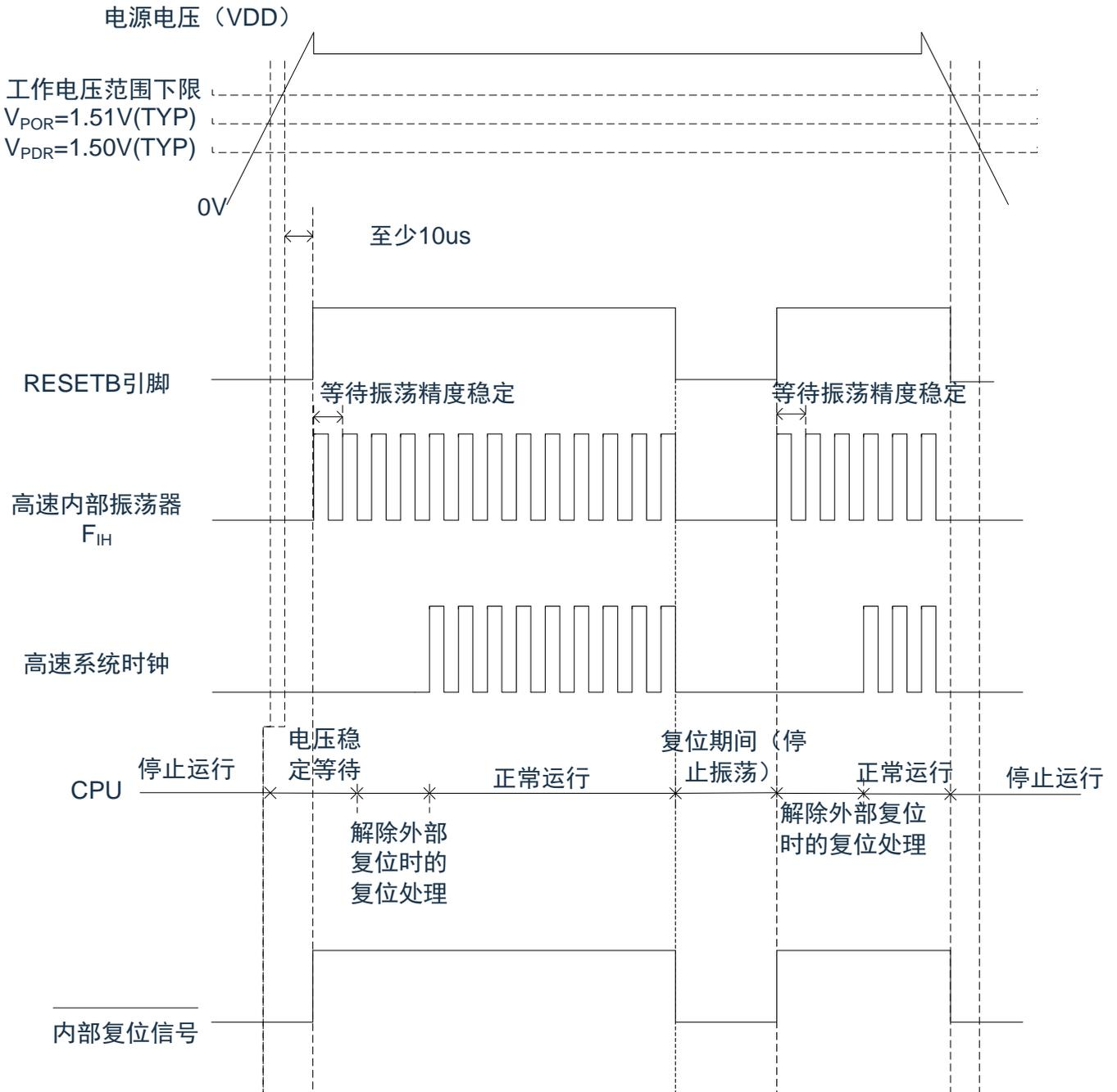
注1：内部复位处理时间包含高速内部振荡器时钟的振荡精度稳定等待时间。
