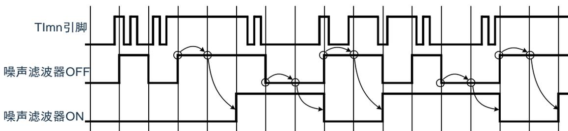
注：TImn引脚的输入波形用于说明噪声滤波器ON或者OFF的运行。实际使用时，必须按照数据手册的AC特性所示的TImn输入高低电平宽度进行输入。
