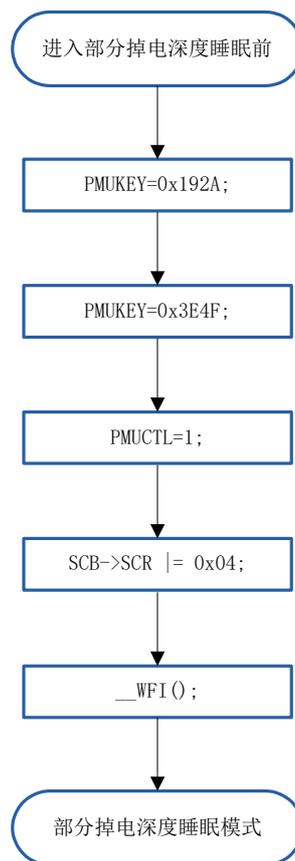
注：当中断请求标志为“1”（产生中断请求信号）时，中断请求信号用于解除深度睡眠模式。因此，如果在此情况下执行WFI指令，就在一旦进入深度睡眠模式后立即被解除，此种情况下不会部分掉电模式。在执行WFI指令并且经过深度睡眠模式解除时间后返回到运行模式。
