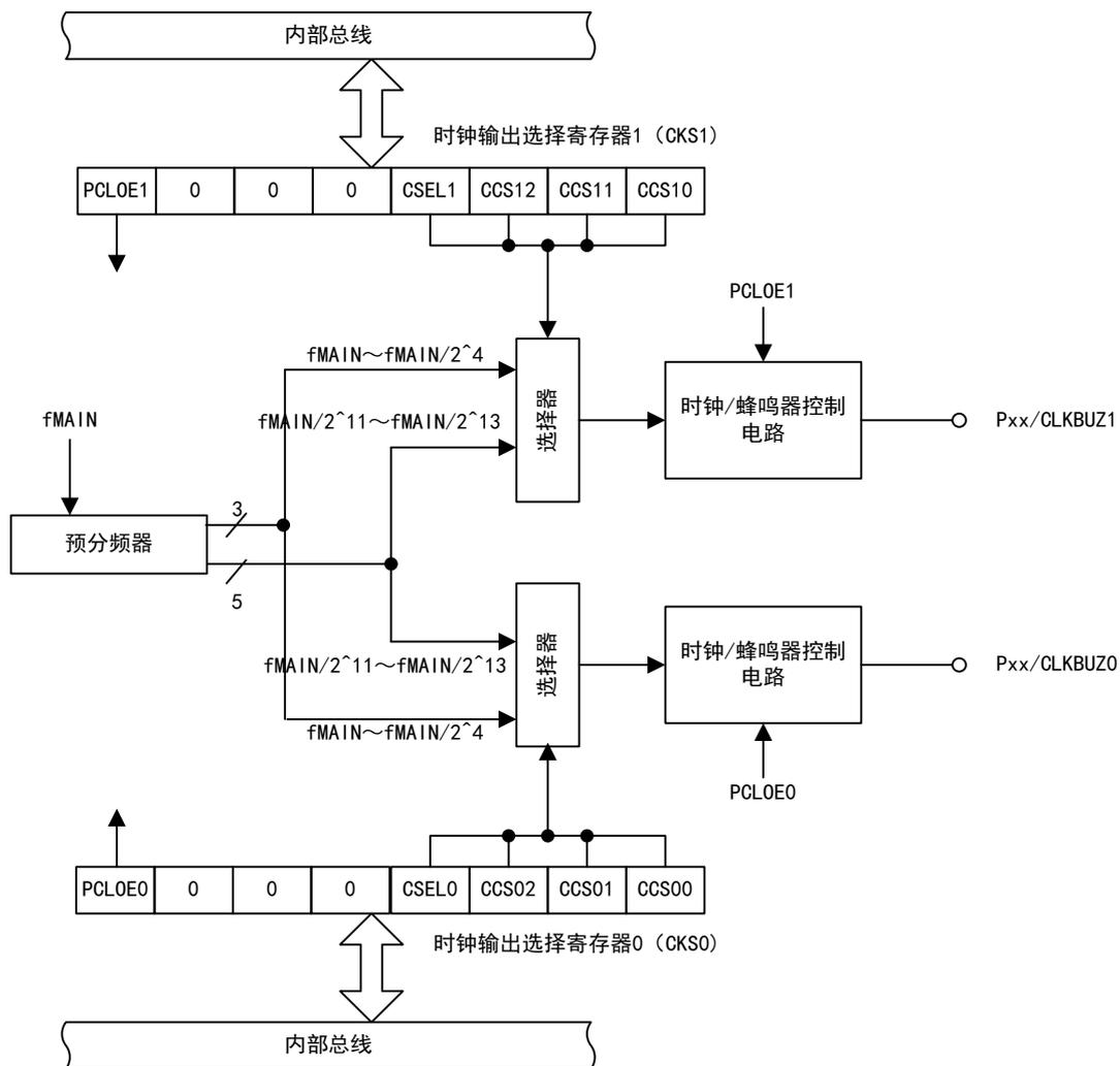
注：有关能从CLKBUZ0引脚和CLKBUZ1引脚输出的频率，请参照“数据手册的AC特性”。
