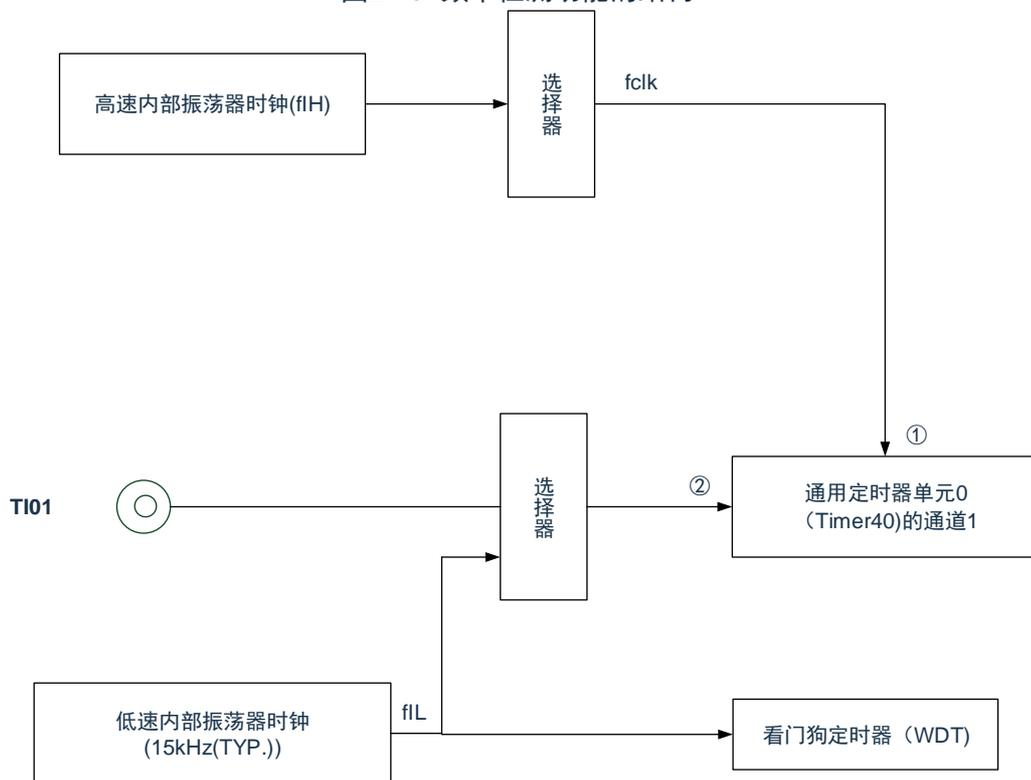
当输入脉冲间隔的测量结果为异常值时，能判断为“时钟频率异常”。有关输入脉冲间隔的测量方法，请参照“5.7.4 为输入脉冲间隔测量的运行”。
