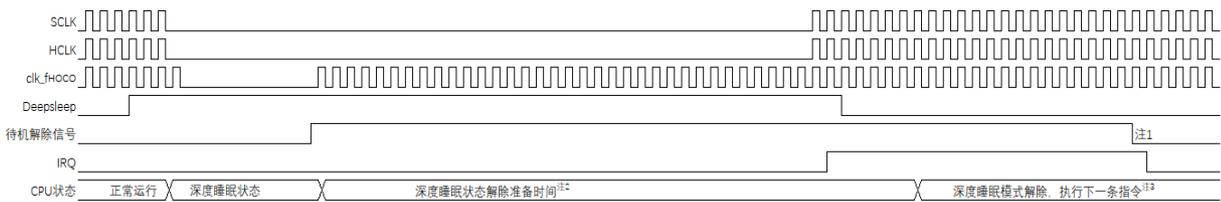
注 1：待机解除信号：INTP0-3、LSITIMER 定时器中断、LVI 中断及 WDT 中断请求信号。
