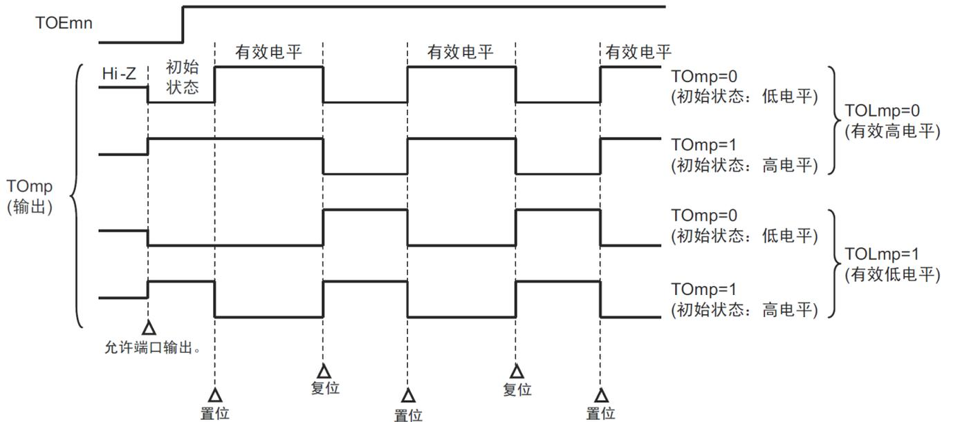
注1: 置位: TOMP引脚的输出信号从无效电平变为有效电平。
