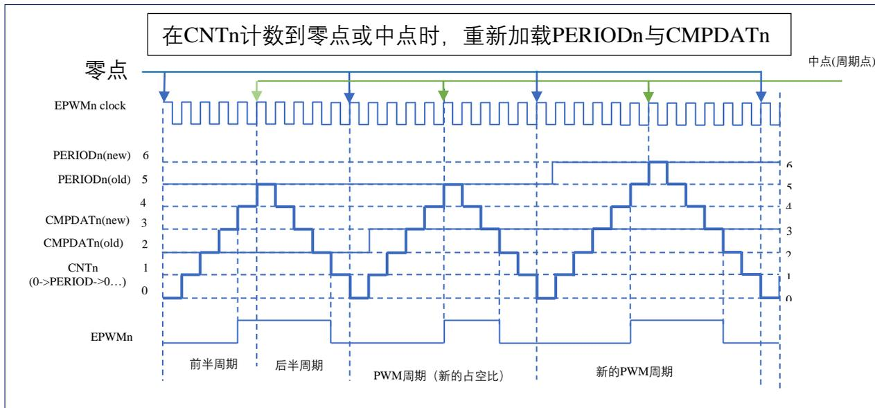
中心对齐非对称计数方式下, 16位PWM计数器CNTn从0开始向上计数, 当CNTn=CMPDATn时, EPWMn输出高电平, 之后CNTn继续向上计数至与PERIODn相等, 然后CNTn开始向下计数, 在向下计数的过程中CNTn=CMPDDATn时, EPWMn输出低电平, 之后继续向下计数至0。开启非对称计数方式需要将ASYMEN置1, 非对称计数方式下可实现精确的中心对齐波形。
