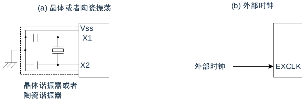
图4-2：X1振荡电路的外接电路例子
