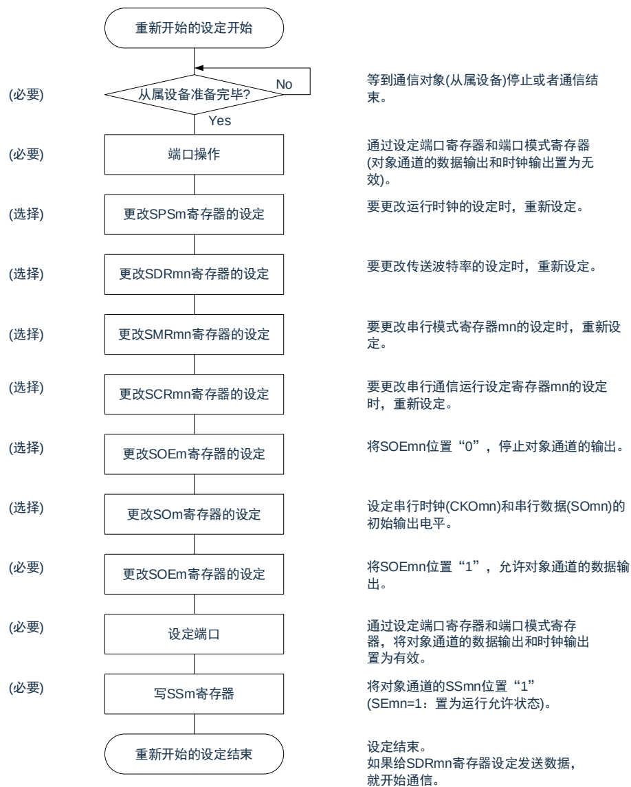
图 15-26：重新开始主控发送的设定步骤
