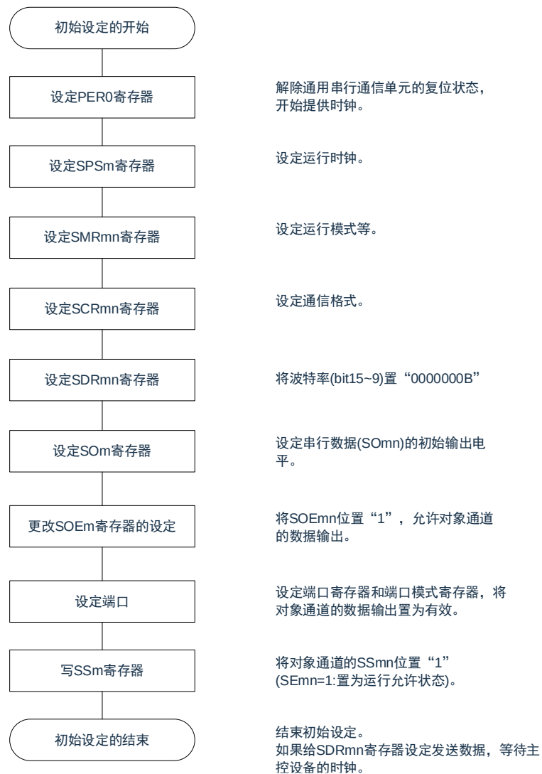
图 15-48：从属发送的初始设定步骤
