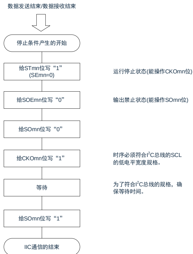
图 15-133：产生停止条件的流程图
