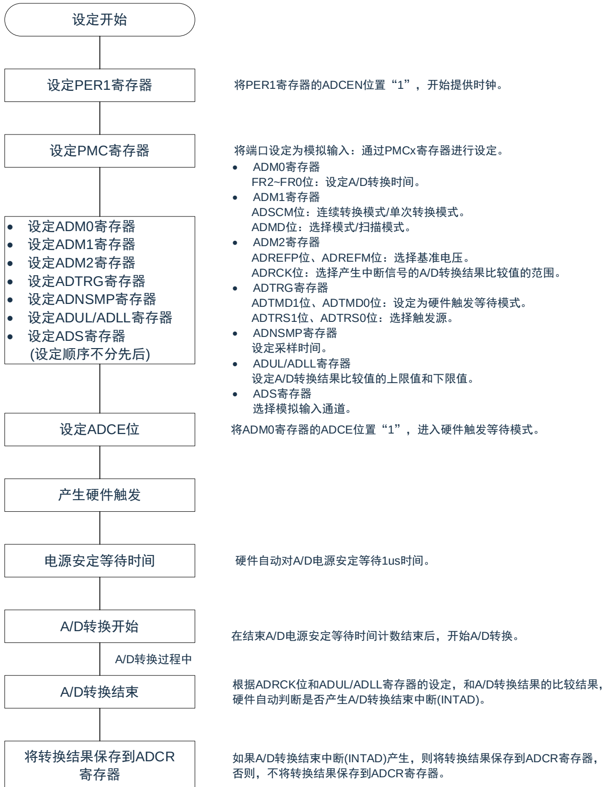
图 11-33：硬件触发等待模式的设定
