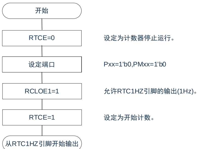
图 7-22：1Hz 输出的设定步骤
