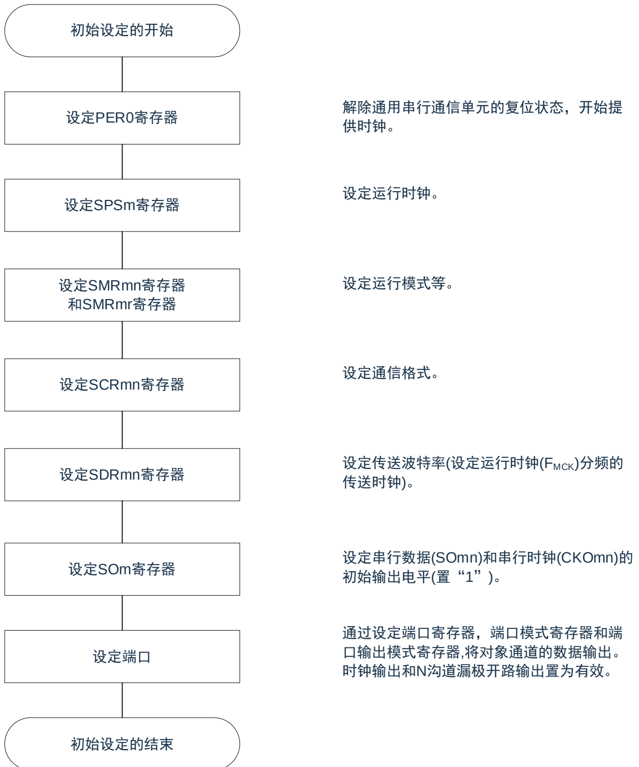
图 15-123: 地址段发送的初始设定步骤
