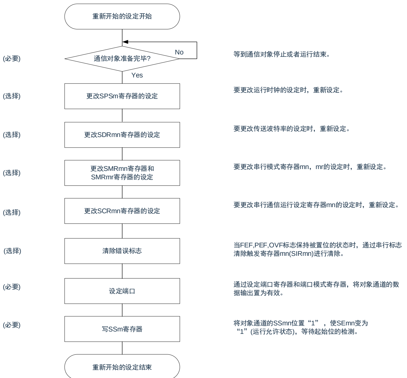
图 15-107：重新开始 UART 接收的设定步骤
