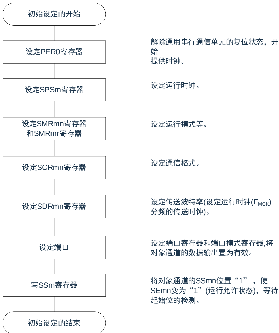
图 15-105: UART 接收的初始设定步骤
