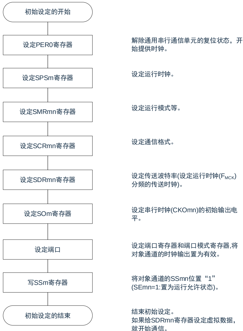
图 15-32：主控接收的初始设定步骤
