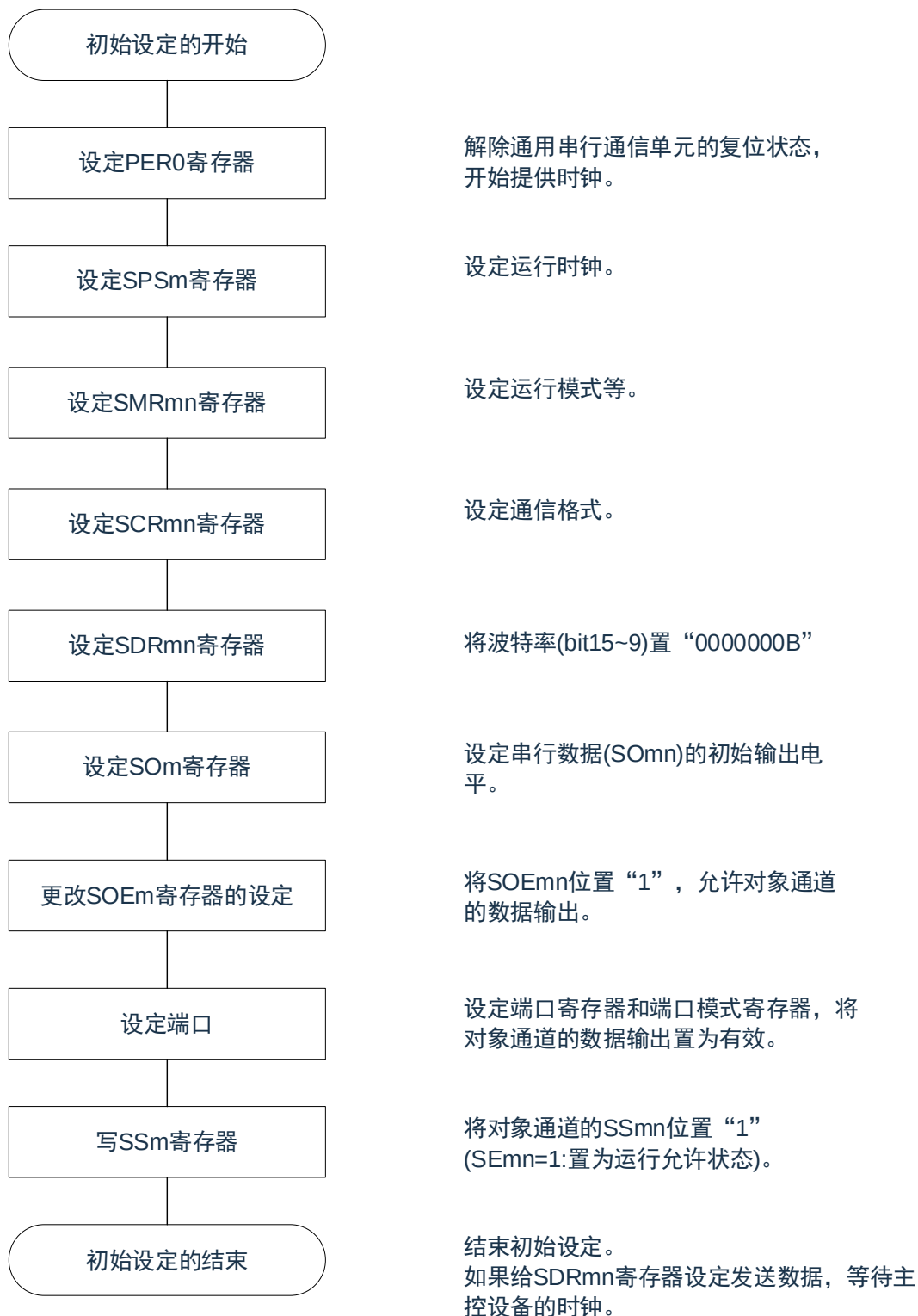
图 15-62：从属发送和接收的初始设定步骤
