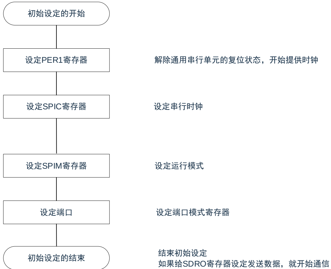
图 16-7：主控发送/接收的初始设置步骤
