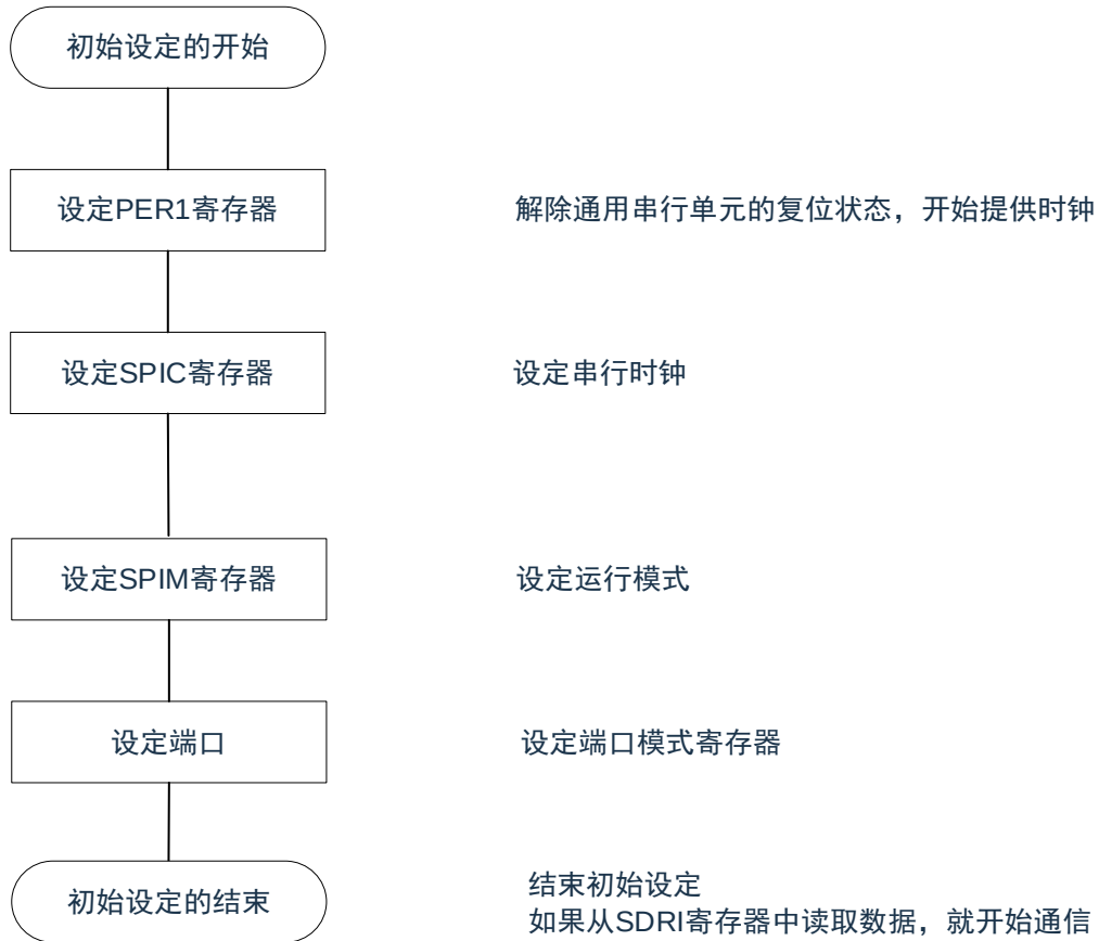
图 16-11：主控接收的初始设置步骤
