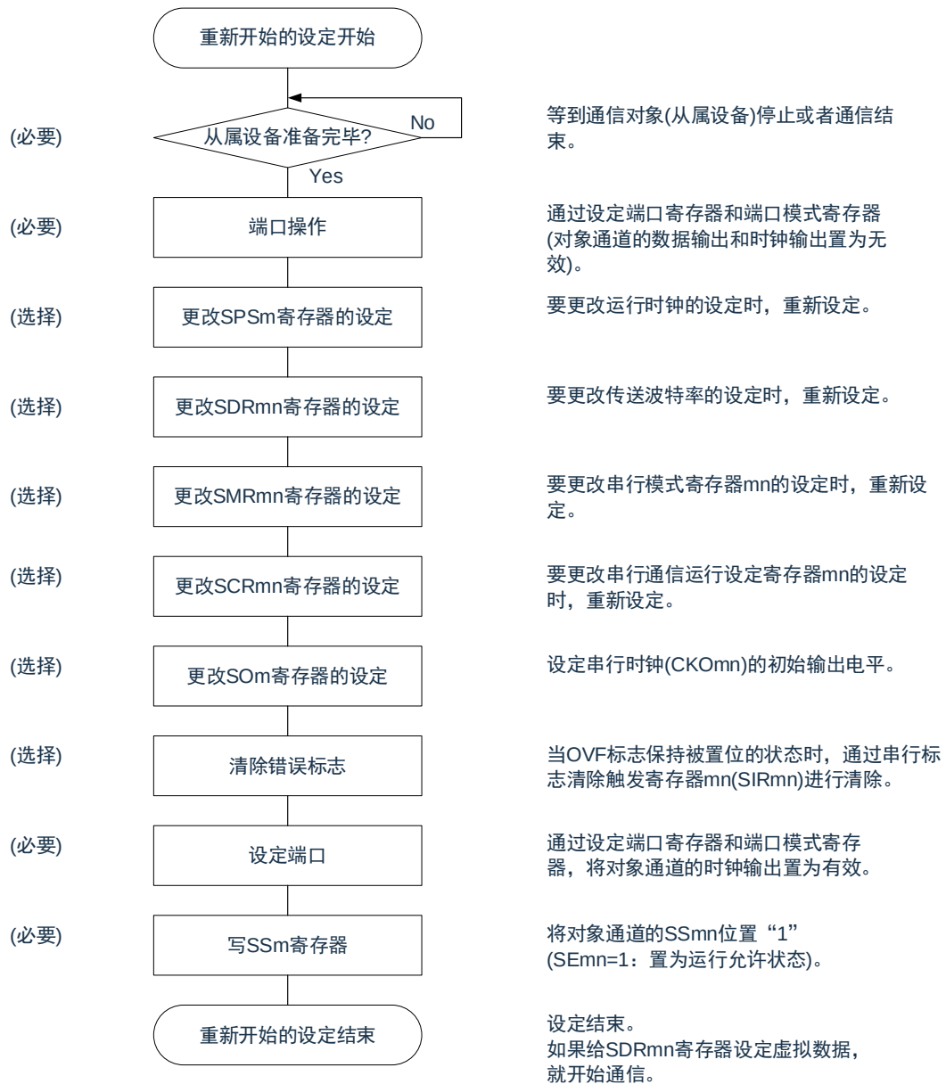
图 15-34：重新开始主控接收的设定步骤
