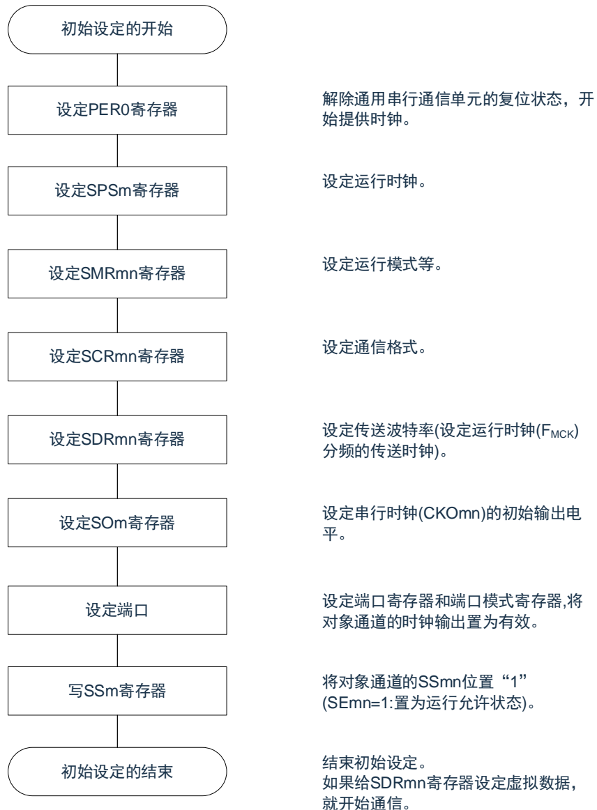
图 15-32: 主控接收的初始设定步骤
