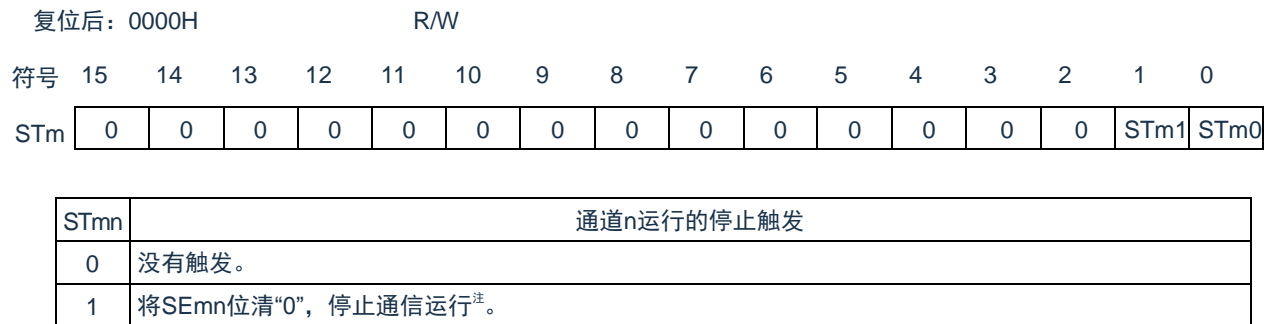
图 15-11：串行通道停止寄存器 m (STm) 的格式
