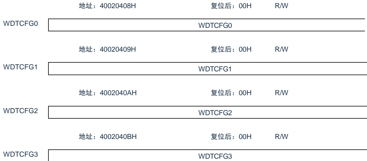
图 10-4: WDTCFG 配置寄存器 (WDTCFG0/1/2/3)
