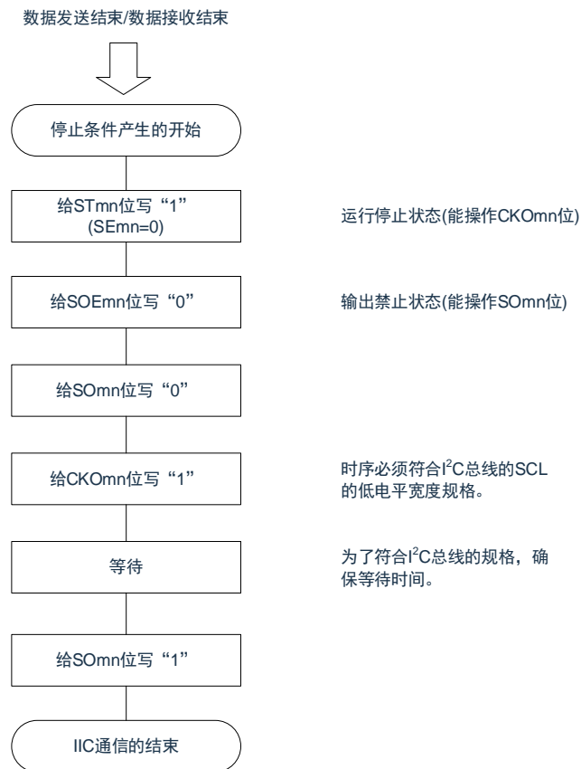
图 15-133：产生停止条件的流程图
