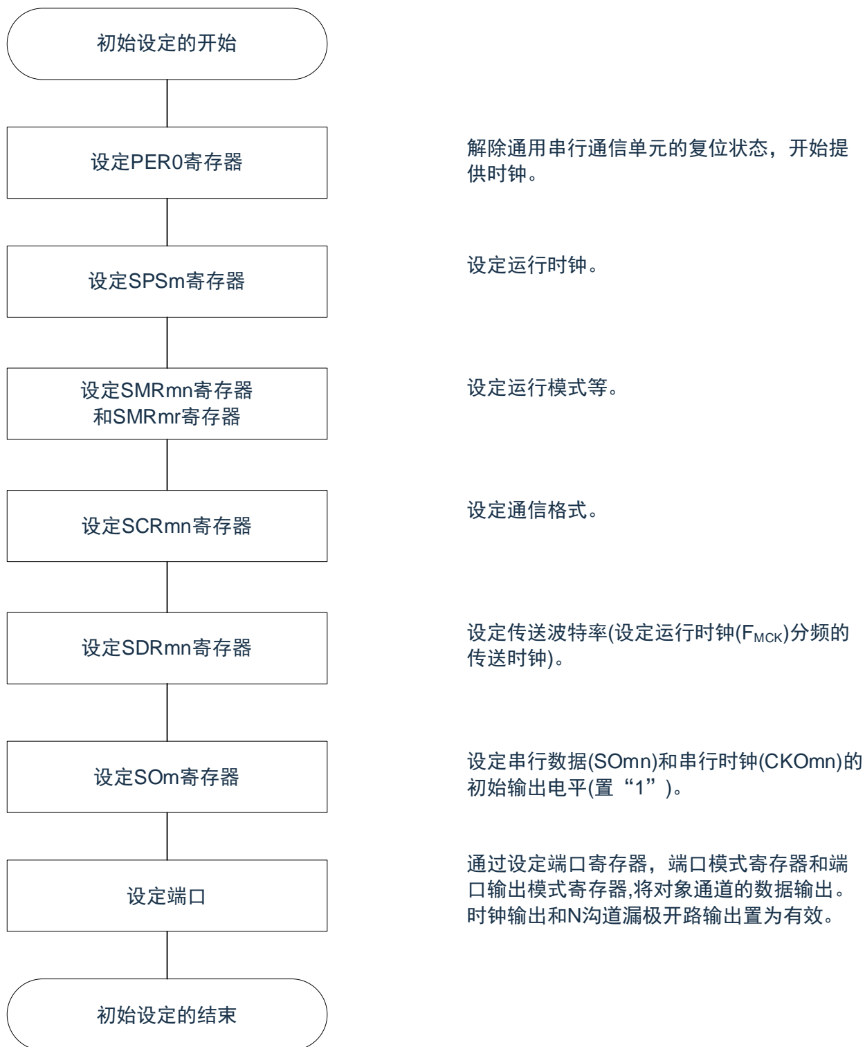
图 15-123: 地址段发送的初始设定步骤
