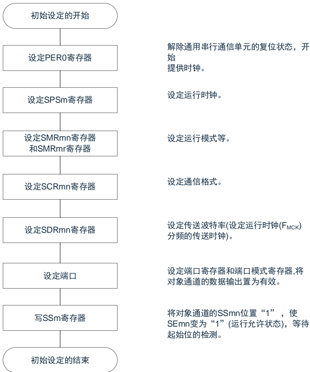
图 15-105: UART 接收的初始设定步骤
