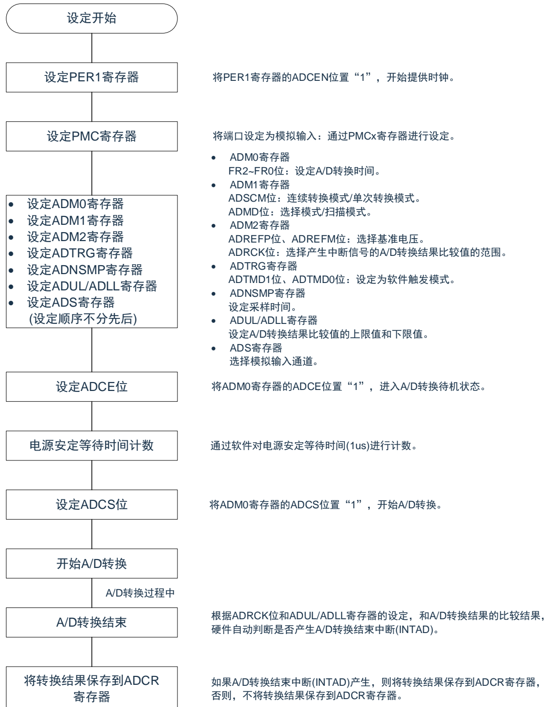
图 11-31：软件触发模式的设定
