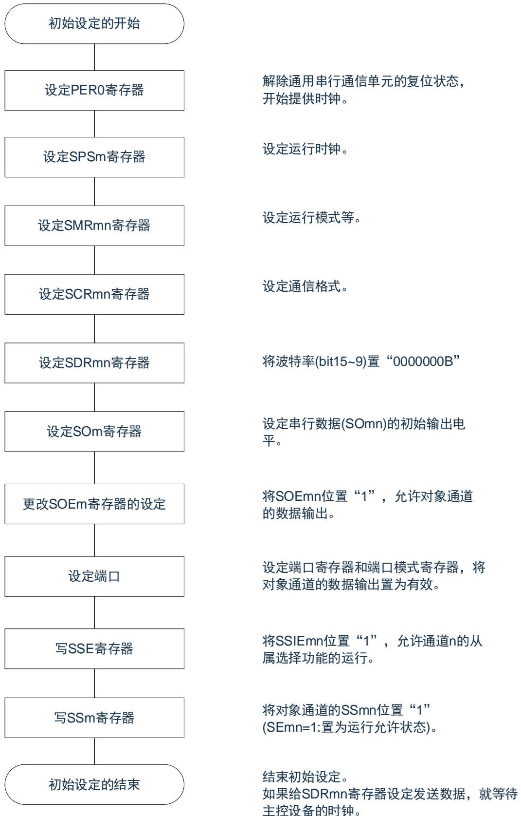
图 15-73: 从属发送的初始设定步骤
