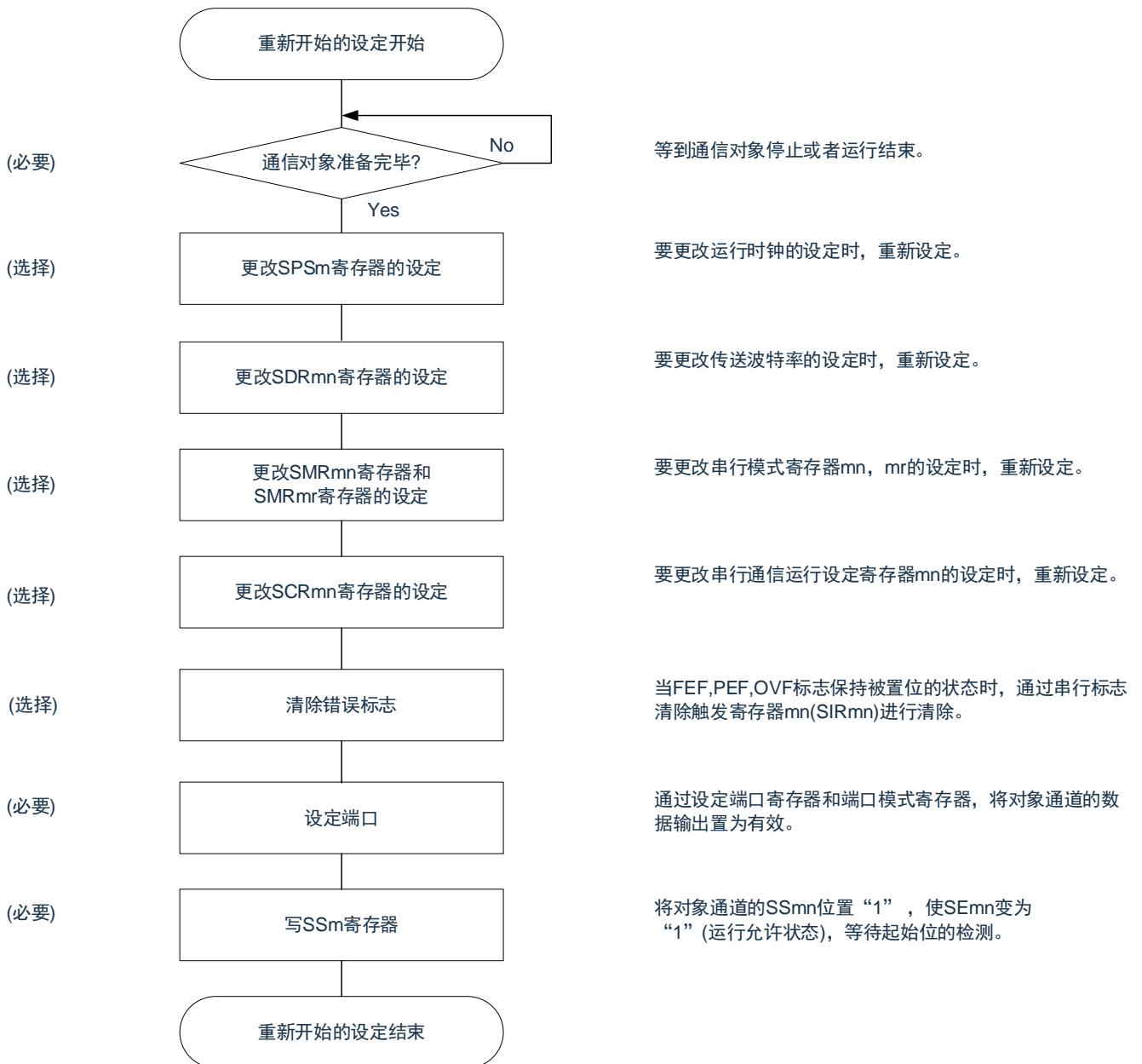
图 15-107: 重新开始 UART 接收的设定步骤
