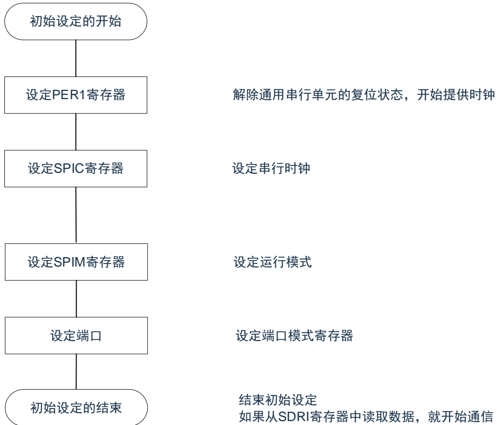
图 16-11：主控接收的初始设置步骤
