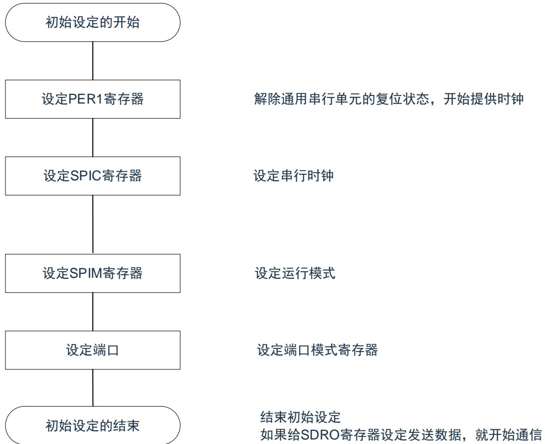
图 16-7: 主控发送/接收的初始设置步骤
