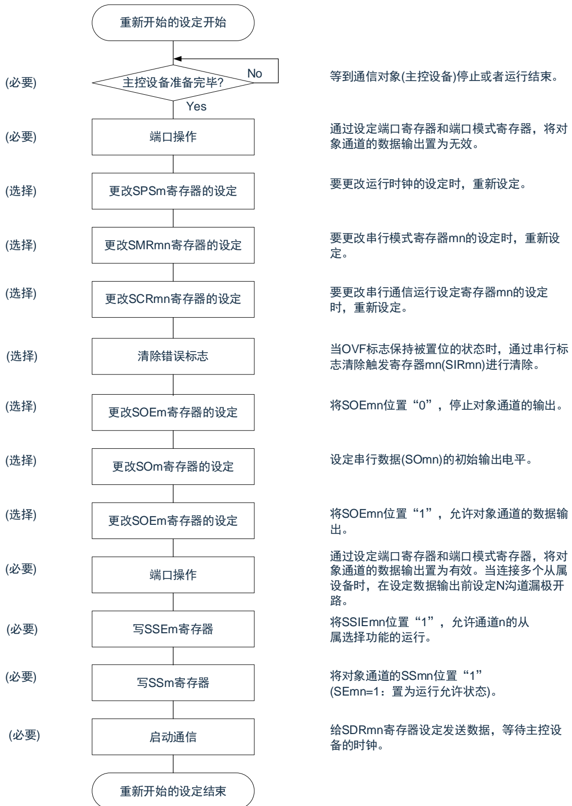
图 15-90: 重新开始从属发送和接收的设定步骤
