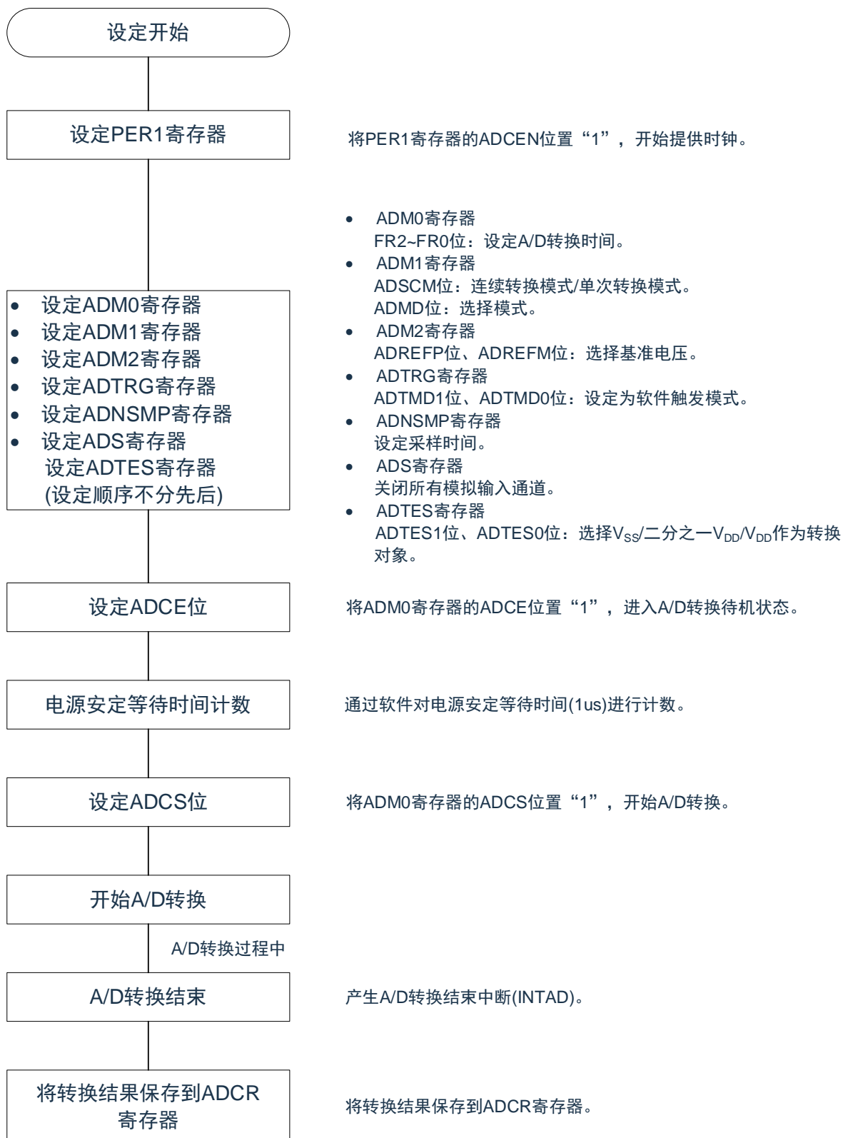
图 11-35: 测试模式的设定( V_{SS}/half\_V_{DD}/V_{DD} 作为转换对象)
