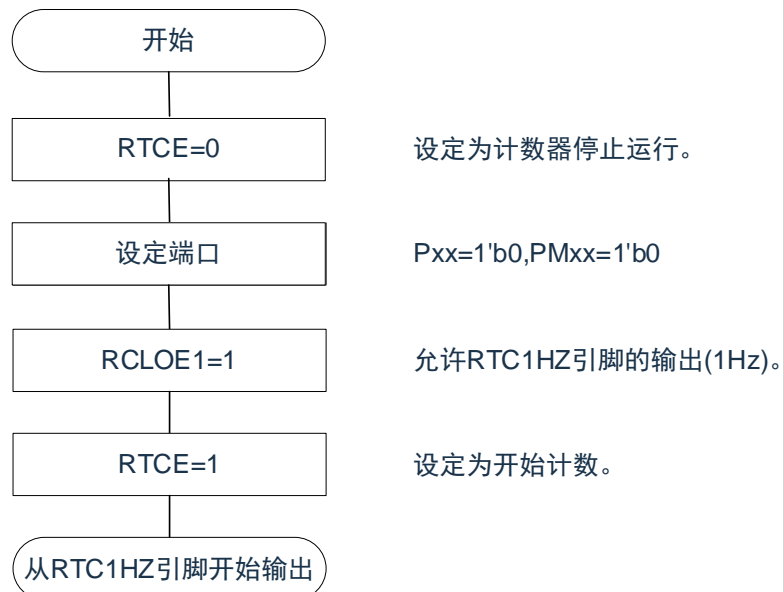
图 7-22: 1Hz 输出的设定步骤
