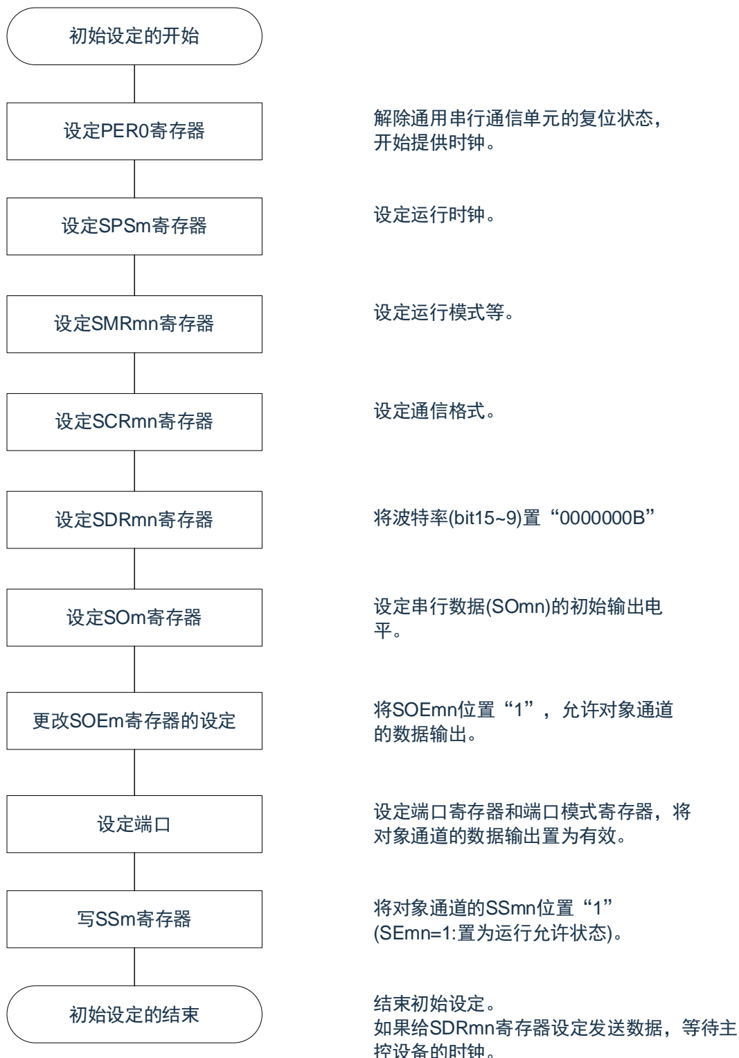
图 15-62: 从属发送和接收的初始设定步骤
