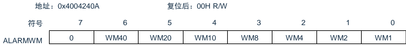
图 7-14：闹钟分钟寄存器 (ALARMWMM) 的格式
