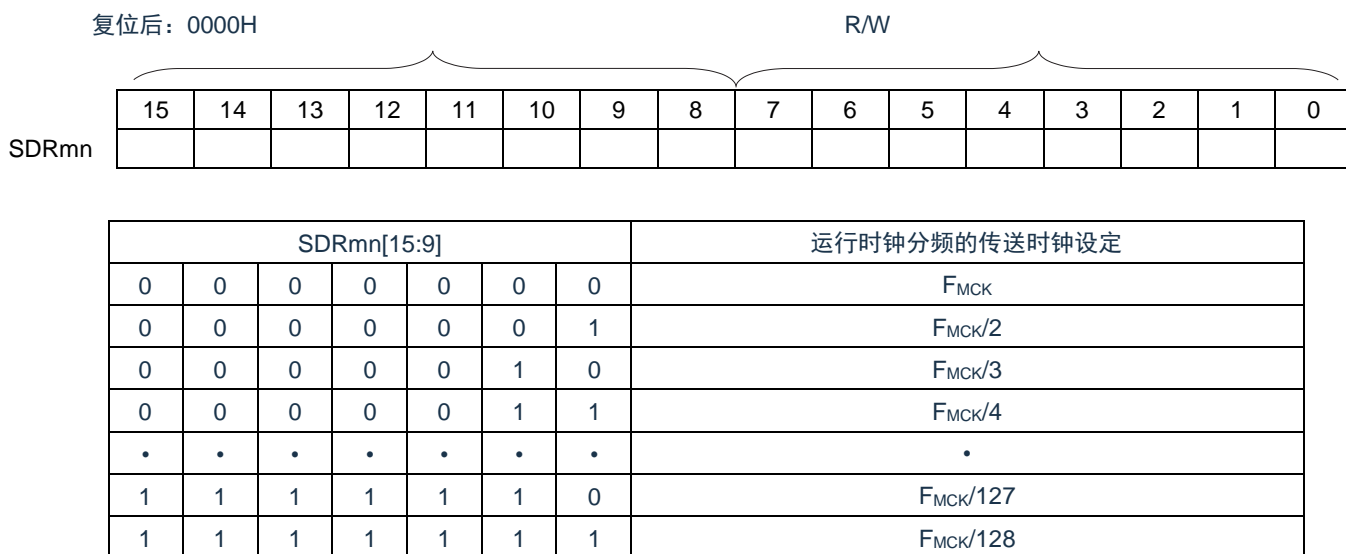
图 15-7: 串行数据寄存器 mn (SDRmn) 的格式
