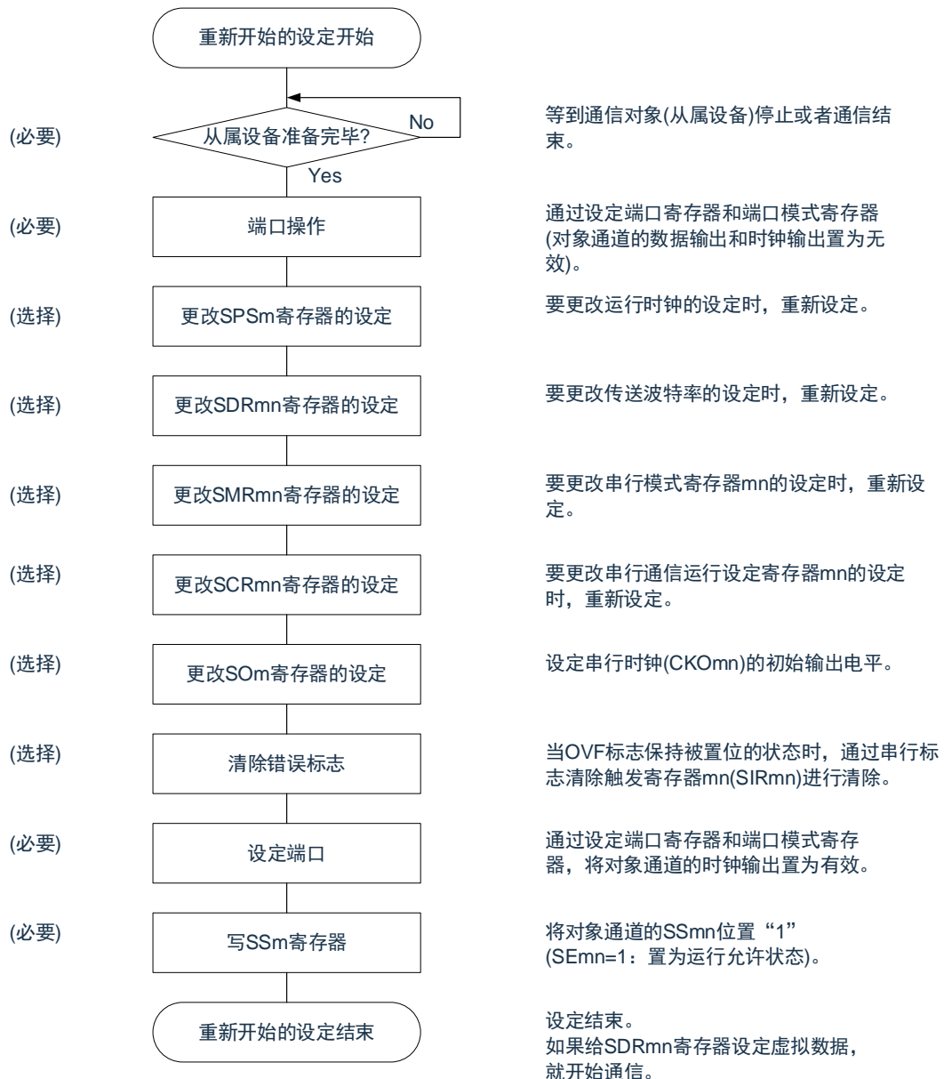
图 15-34：重新开始主控接收的设定步骤
