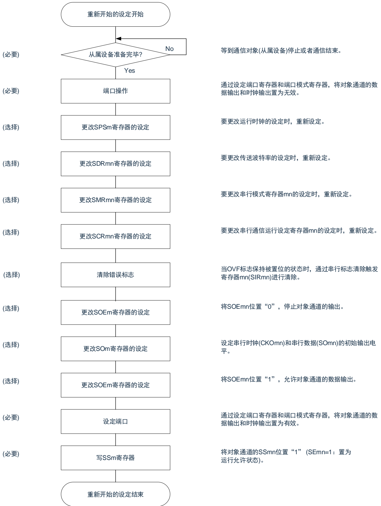
图 15-42: 重新开始主控发送和接收的设定步骤
