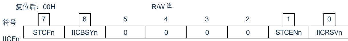
图 17-8: IICA 标志寄存器 n (IICFn) 的格式
