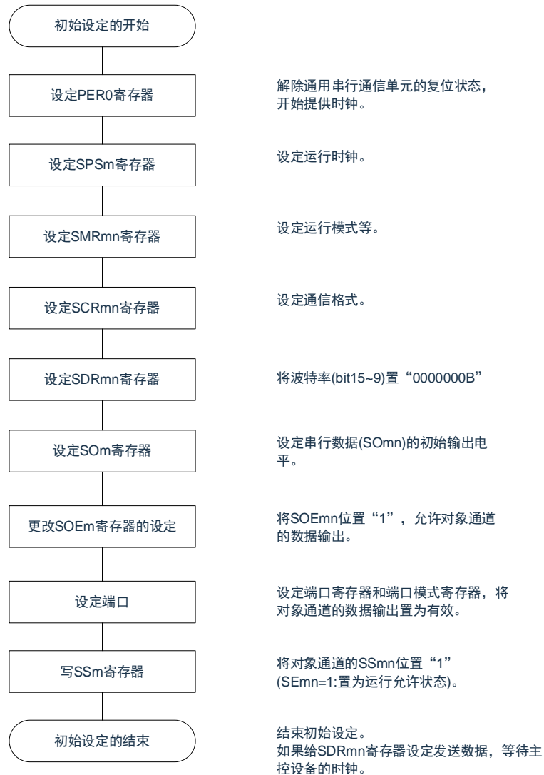
图 15-48: 从属发送的初始设定步骤
