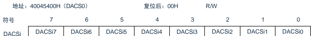
图 12-4: D/A 转换值设置寄存器 i（DACSi）（i=0）的格式
