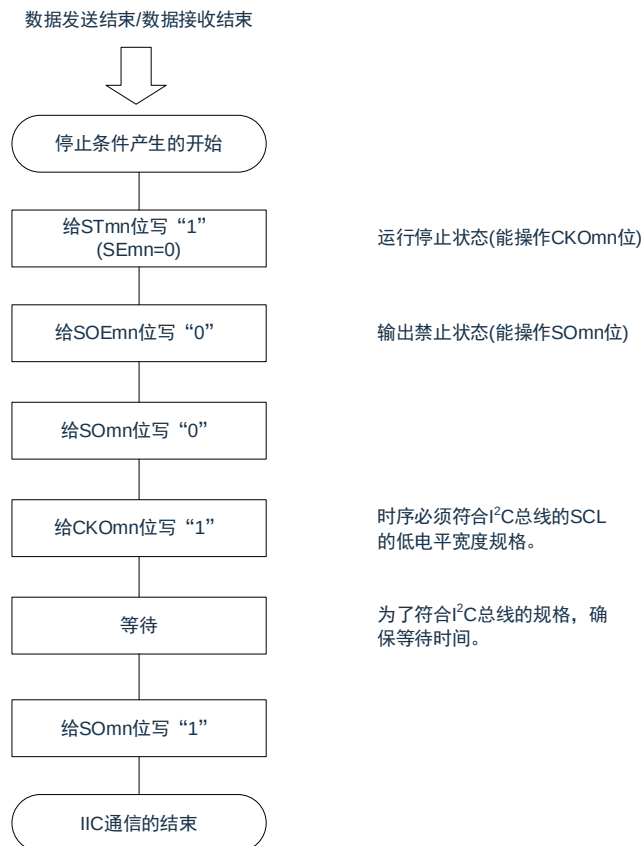
图 15-133：产生停止条件的流程图
