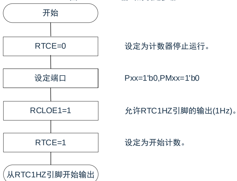
图 7-22: 1Hz 输出的设定步骤
