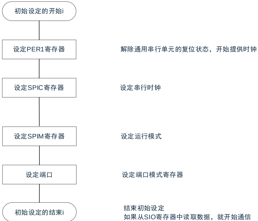
图 16-11：主控接收的初始设置步骤
