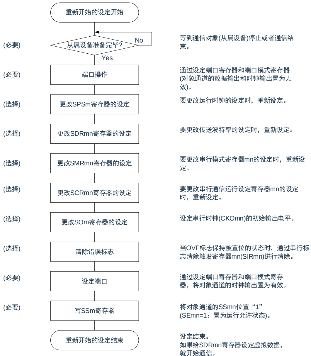
图 15-34：重新开始主控接收的设定步骤
