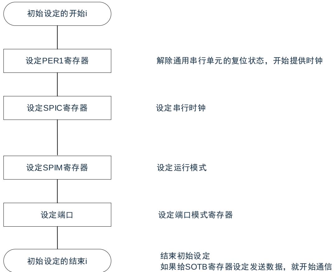
图 16-7：主控发送/接收的初始设置步骤
