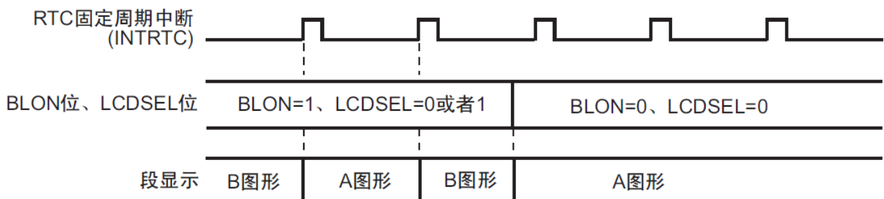
图 19-10：从闪烁显示到 A 图形显示的切换运行
