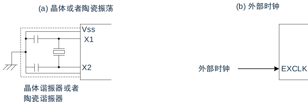
图 4-13：X1 振荡电路的外接电路例子
