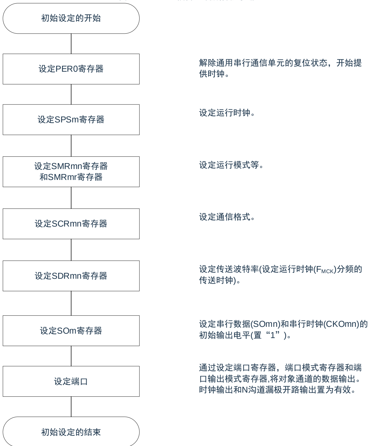
图 15-123: 地址段发送的初始设定步骤
