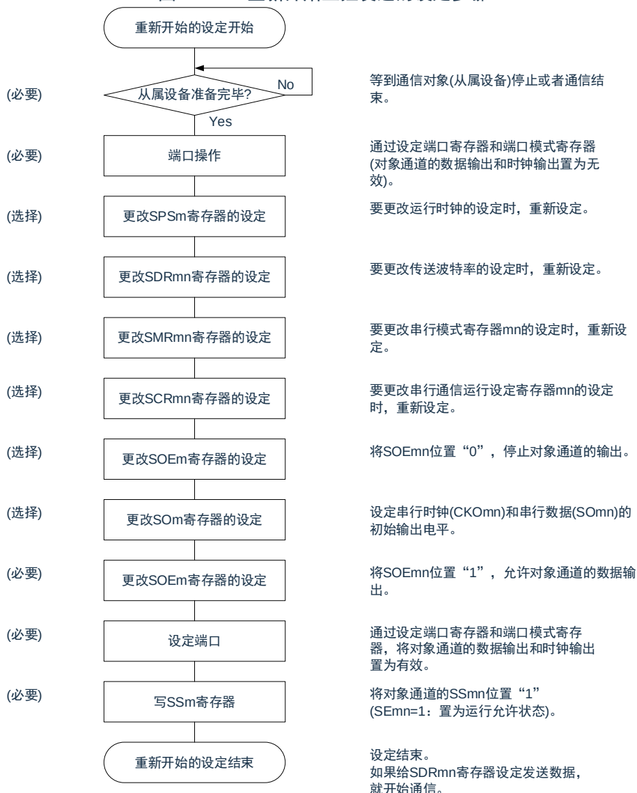
图 15-26：重新开始主控发送的设定步骤
