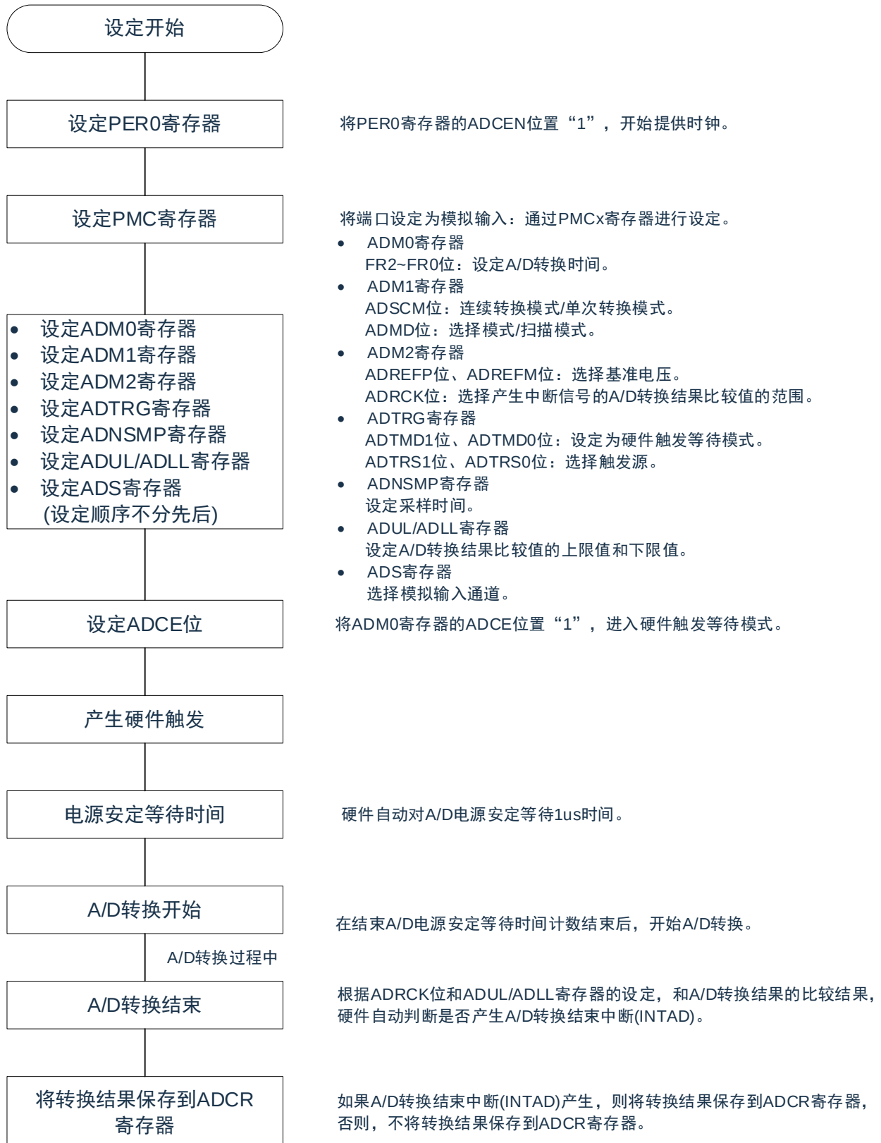
图 11-32：硬件触发等待模式的设定
