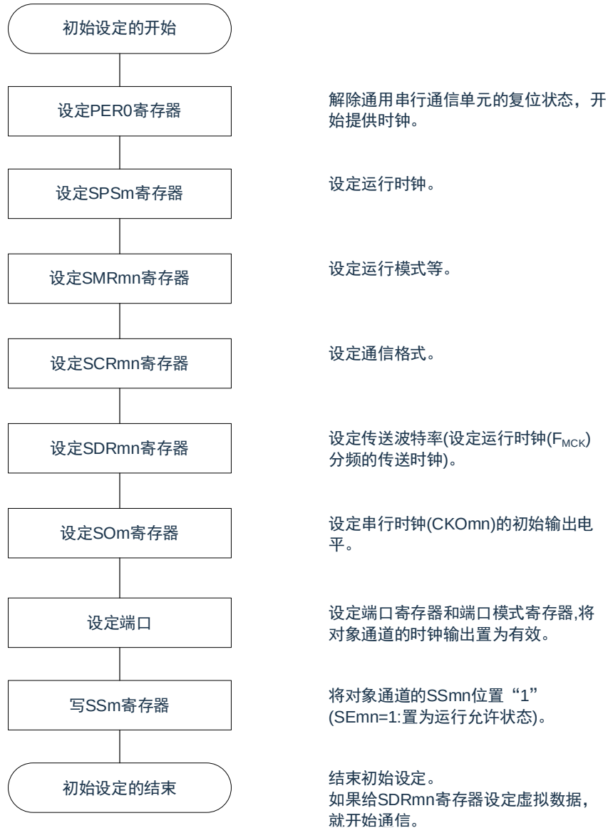
图 15-32：主控接收的初始设定步骤
