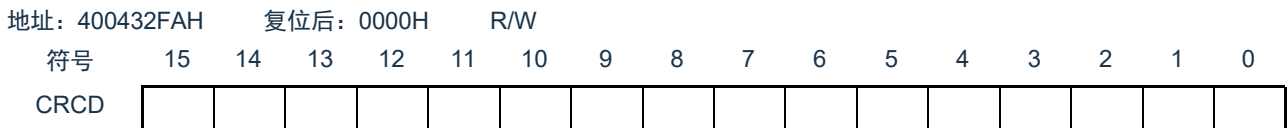
图24-5 CRC数据寄存器 (CRCD) 的格式
