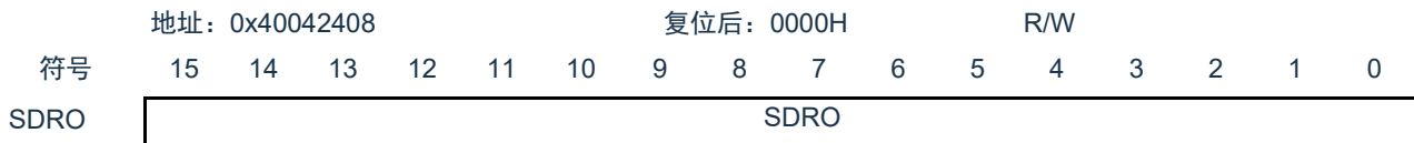
图 13-4 发送缓冲寄存器（SDRO）的格式
