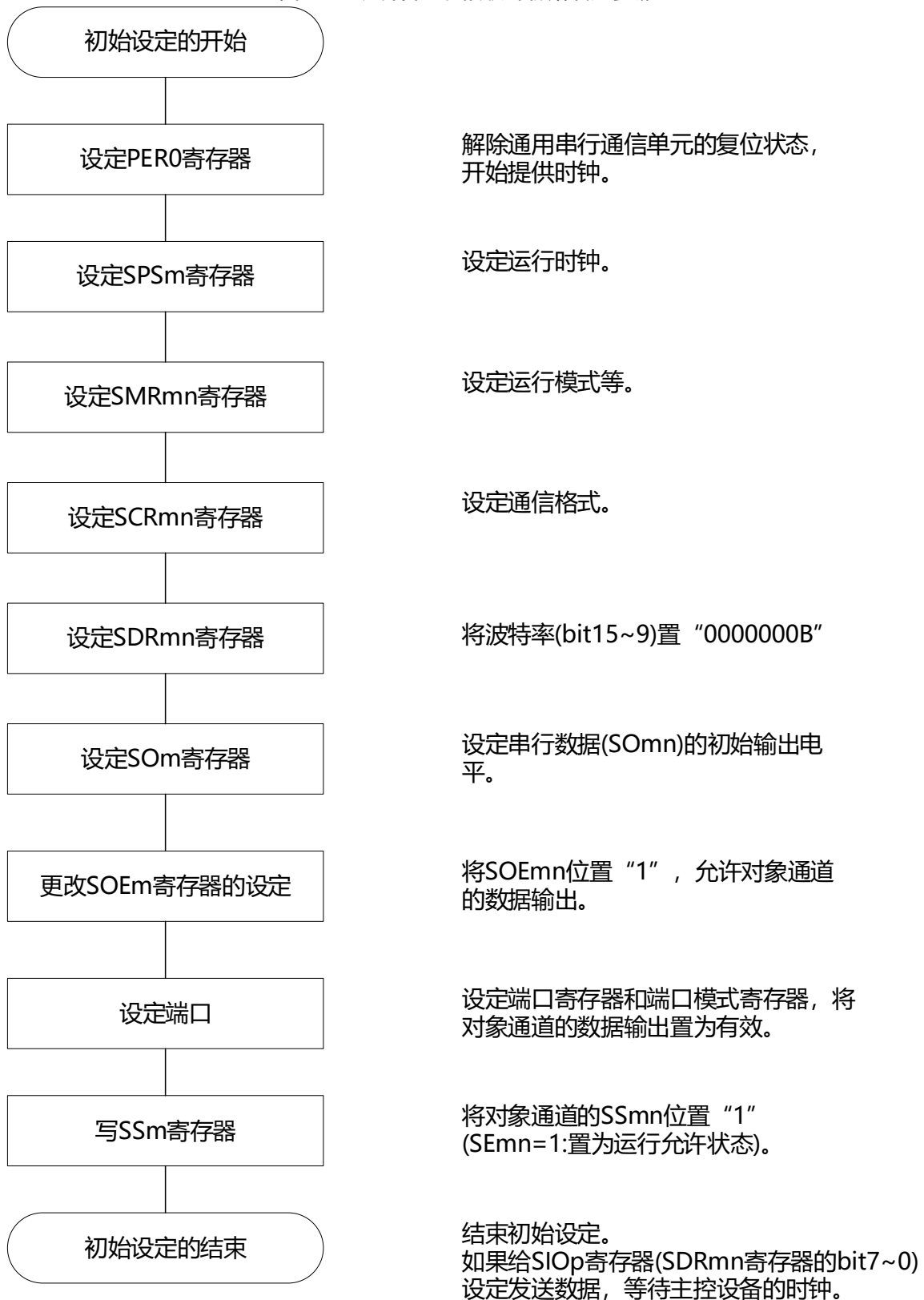
图12-62从属发送和接收的初始设定步骤
