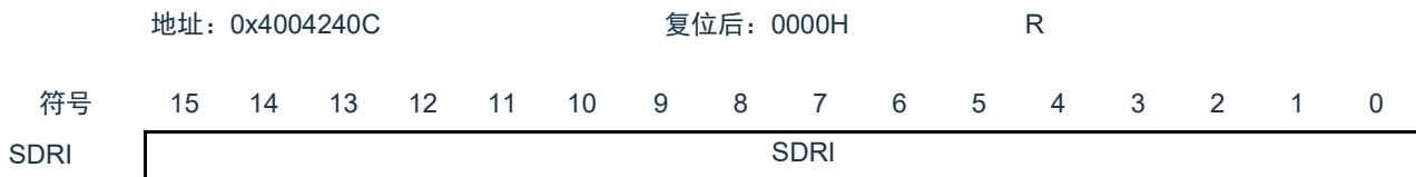
图 13-5 接收缓冲寄存器（SDRI）的格式
