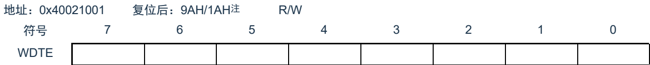
图10-2 看门狗定时器的允许寄存器（WDTE）的格式
