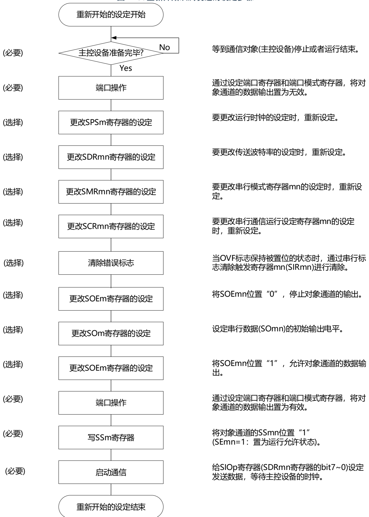
图12-50重新开始从属发送的设定步骤
