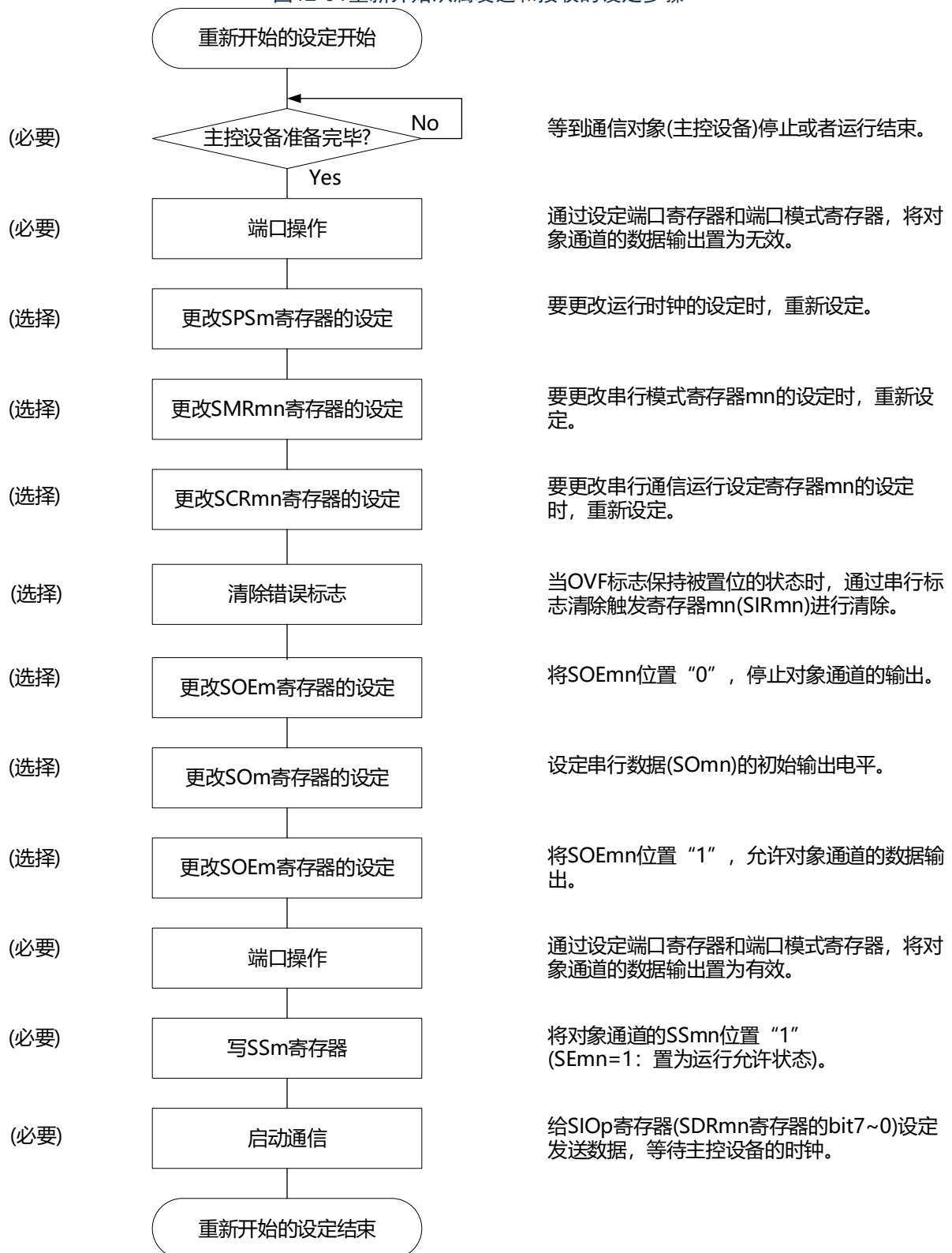
图12-64 重新开始从属发送和接收的设定步骤
