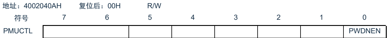
图4-14 副系统时钟选择寄存器 (PMUCTL) 的格式
