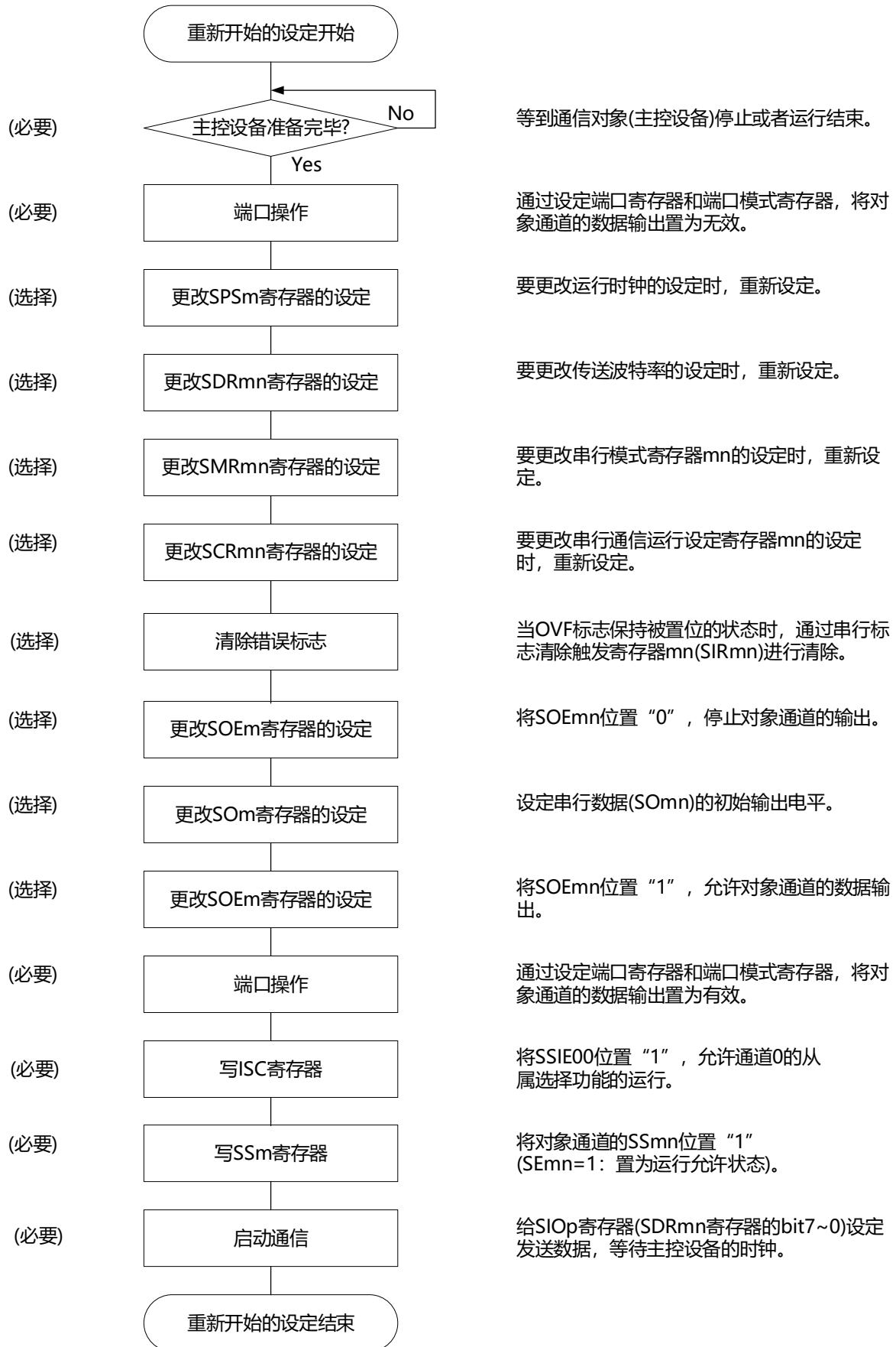
图12-75重新开始从属发送的设定步骤
