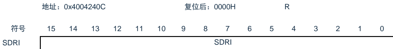
图 13-5 接收缓冲寄存器（SDRI）的格式
