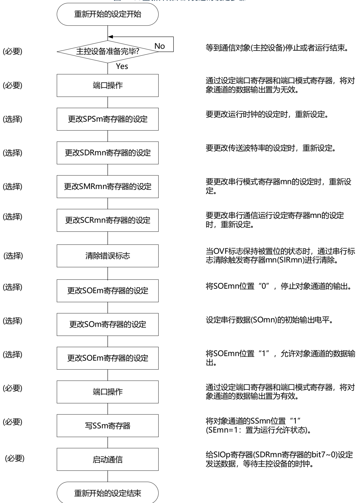
图12-50重新开始从属发送的设定步骤
