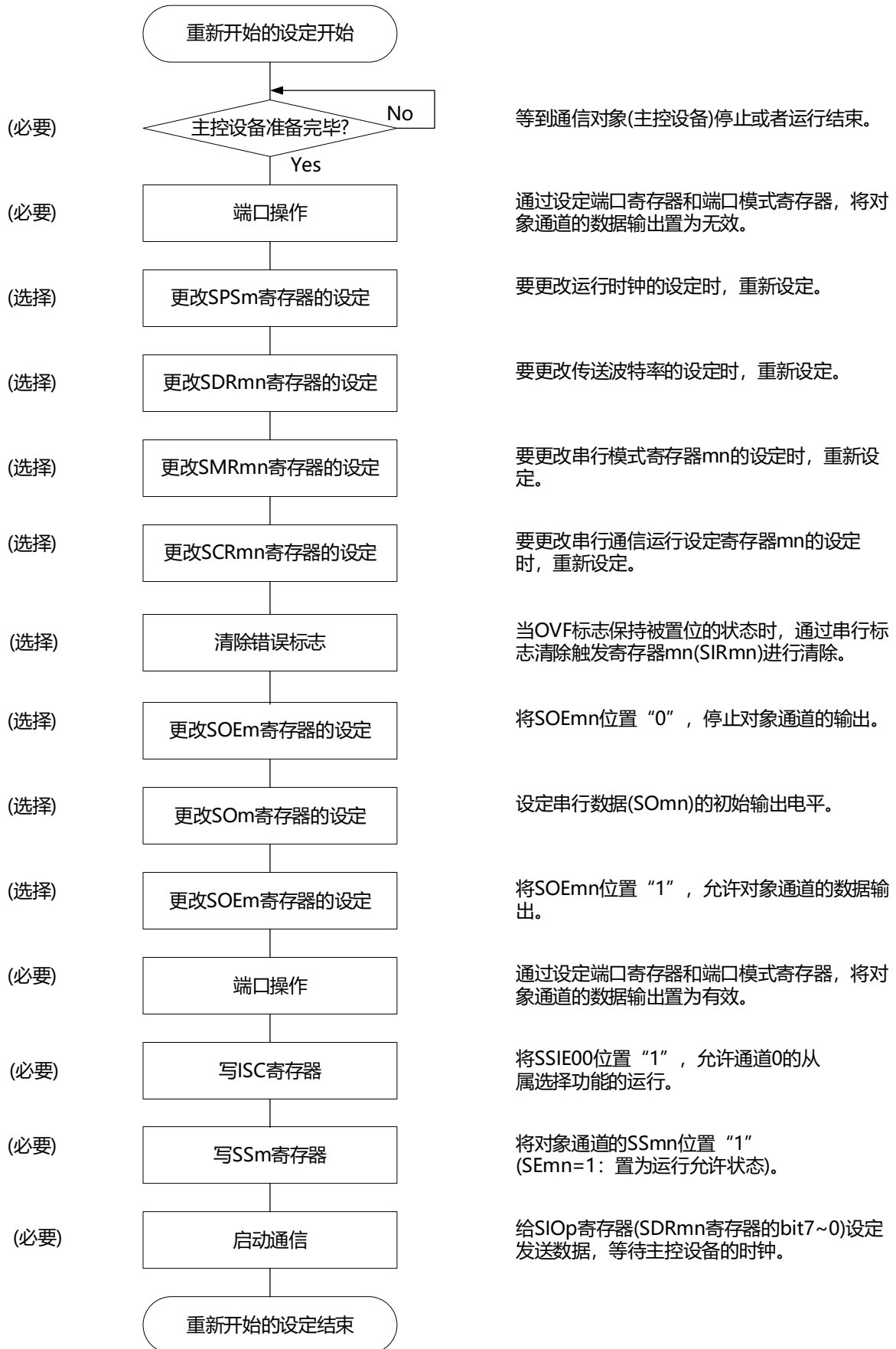
图12-75重新开始从属发送的设定步骤
