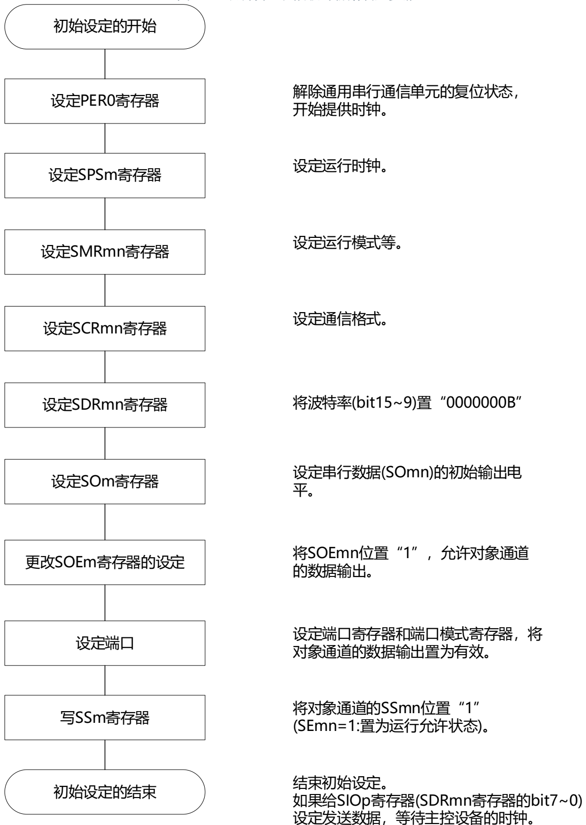
图12-62从属发送和接收的初始设定步骤
