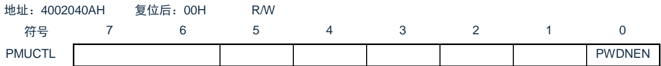
图4-14 副系统时钟选择寄存器 (PMUCTL) 的格式
