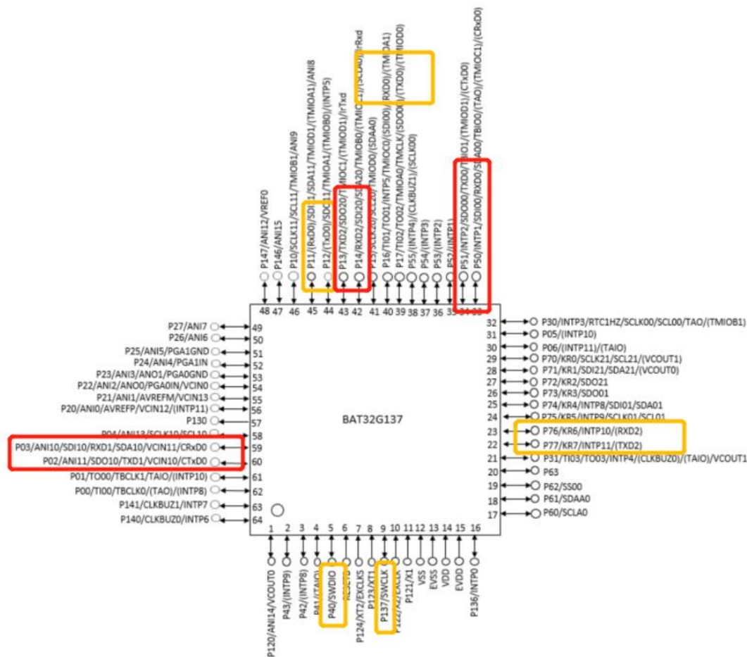
图 1 BAT32G137 64PIN 串口引脚分配
