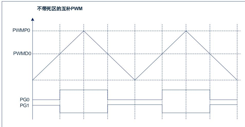
在电机控制应用当中，理想的 PWM 信号是在同一时刻发生电平的翻转，由于 MOS 管的开通和关断存在着延时，这样就容易造成电源对地直通，从而损坏功率管。为了避免这种现象，带死区时间的 PWM 就显得尤为重要。在互补模式下，每组互补 PWM 对均支持插入死区时间，插入的死区时间如下：
