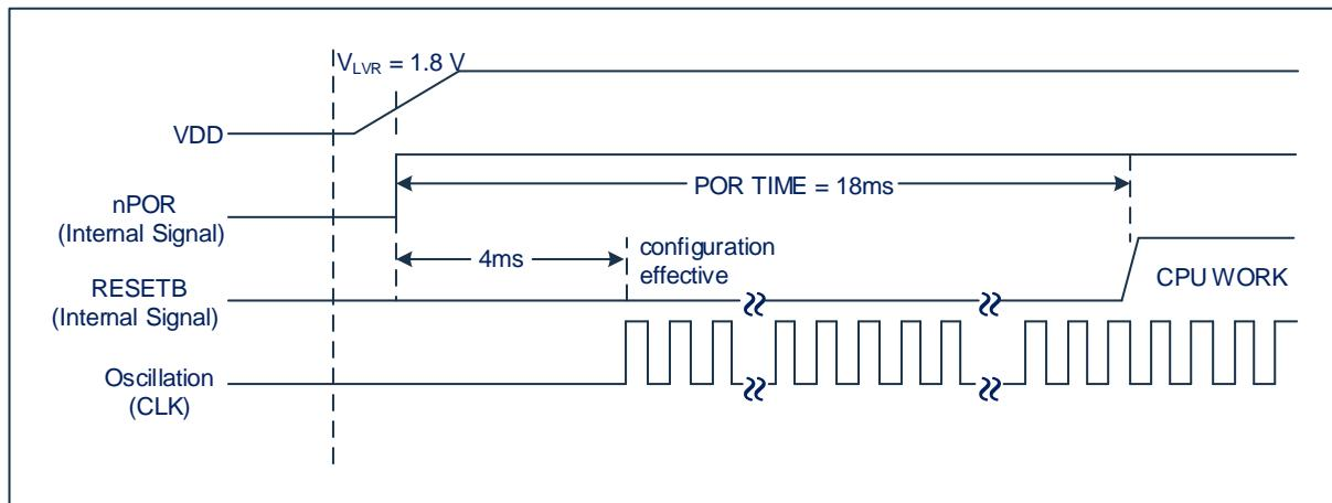
系统是否为上电复位可通过 PORF (WDCON.6) 标志位来判断。可置 PORF 标志位为 1 的复位类型有：上电复位、LVR 复位、外部复位、CONFIG 保护复位。
