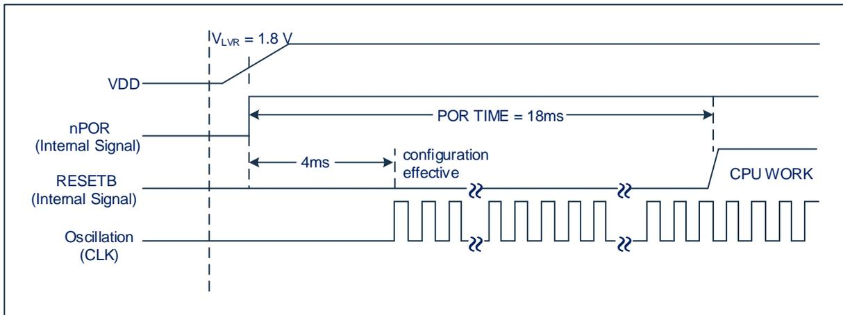
系统是否为上电复位可通过 PORF (WDCON.6) 标志位来判断。可置 PORF 标志位为 1 的复位类型有：上电复位、LVR 复位、上电监控复位、CONFIG 保护复位、外部复位、窗口看门狗复位。
