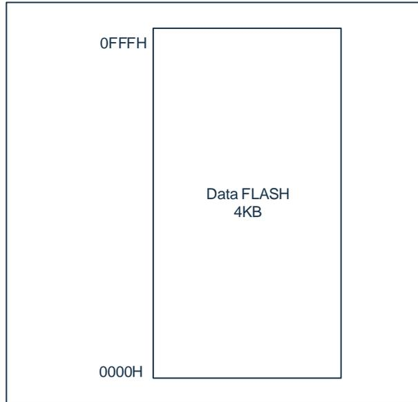
Data FLASH 存储器的读、写、擦除操作通过 FLASH 控制接口实现。
