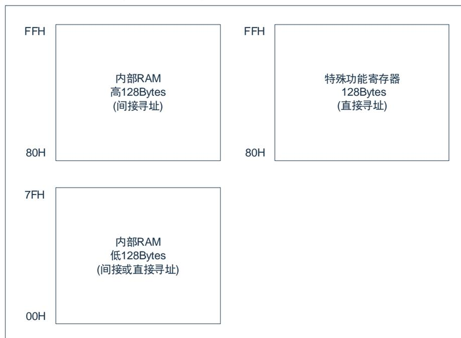
上图所示的高 128Bytes 和 SFR 占用相同的区域(80H~FFH),但它们本身却是独立的。直接寻址高于 7FH 的存储空间(SFR)和间接寻址高于 7FH (高 128Bytes) 的存储空间进入到不同的存储空间。
