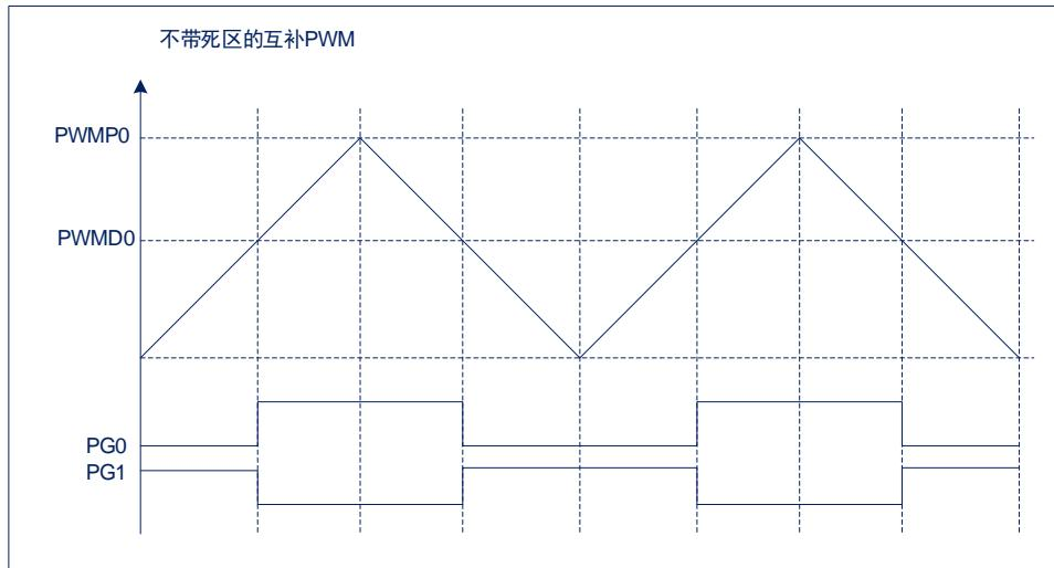
在电机控制应用当中，理想的 PWM 信号是在同一时刻发生电平的翻转，由于 MOS 管的开通和关断存在着延时，这样就容易造成电源对地直通，从而损坏功率管。为了避免这种现象，带死区时间的 PWM 就显得尤为重要。在互补模式下，每组互补 PWM 对均支持插入死区时间，插入的死区时间如下：
