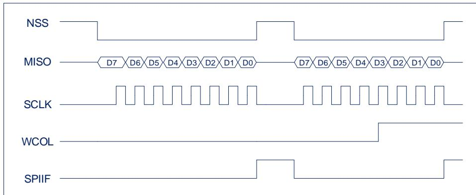
以防 CPHA 被清除，WCOL 生成也可由任一 NSS 线清零时 SPDR 寄存器写入引起，此时 SPI 主机没有生成串行时钟 SCLK 也可以完成。这是因为没有明确指定传输开始，并且在全字节传输后 NSS 被驱动为低电平可能指示下一个字节传输的开始。当 NSS 传输线为低电平、时钟相位 CPHA = 0 时，写 SPDR 导致写冲突错误如下图所示：
