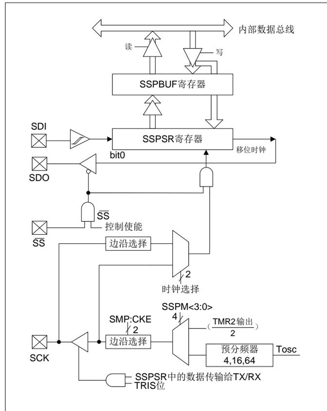
图 14-1：在 SPI 模式下 MSSP 模块的框图
