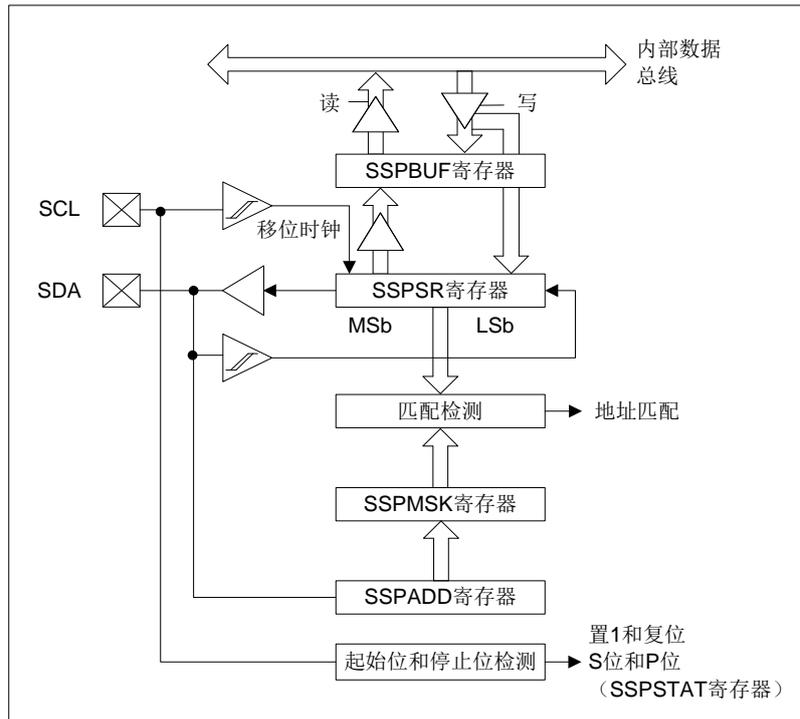
图 14-6: MSSP 框图 (I<sup>2</sup>C 模式)
