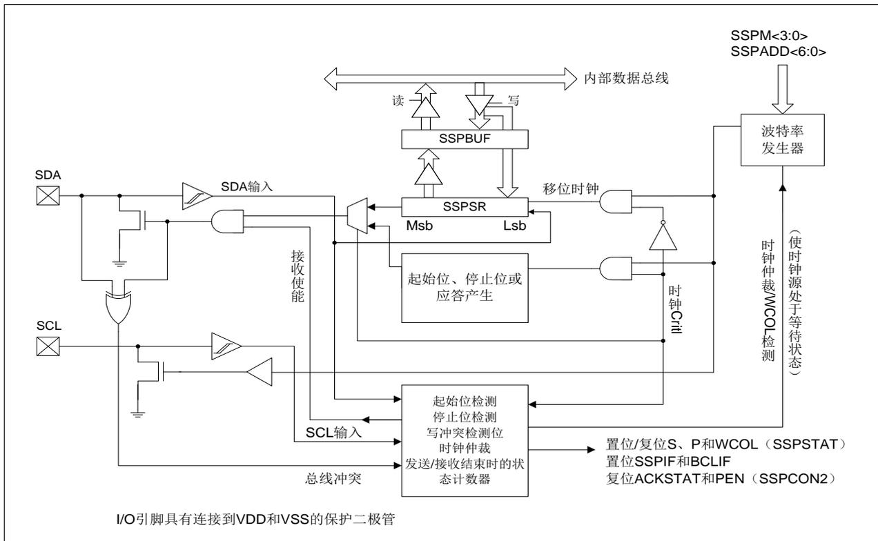
图14-7: MSSP框图（I<sup>2</sup>C™主控模式）
