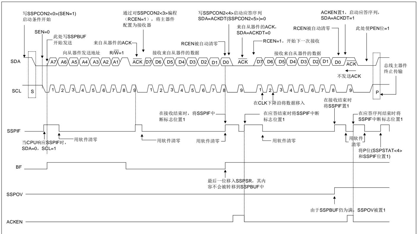
图14-11: I<sup>2</sup>C™主控模式接收时序 (7位地址)
