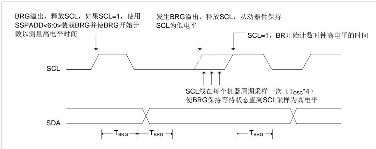
图 14-16: 主控发送模式下的时钟仲裁时序
