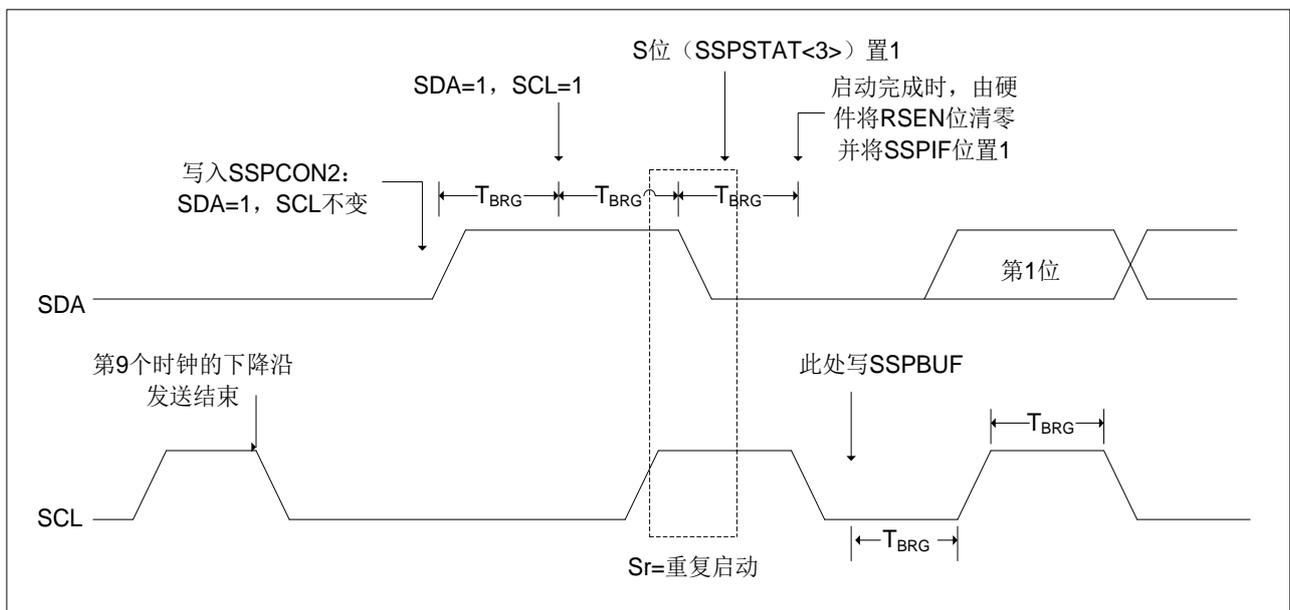
图14-13: 重复启动条件时序波形
