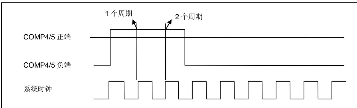
图 15-5: 输出低电平有效的示意图
