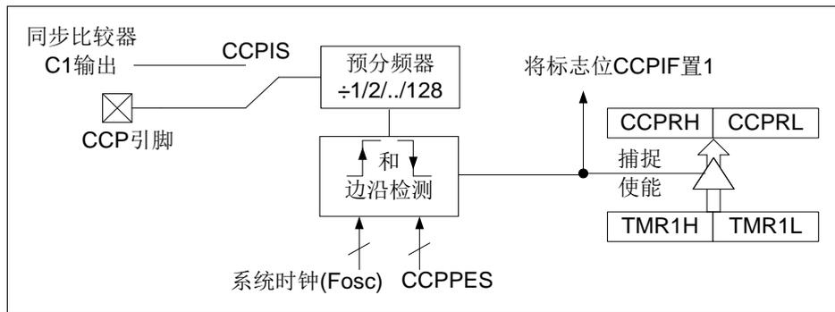
图 13-1: 捕捉模式工作框图
