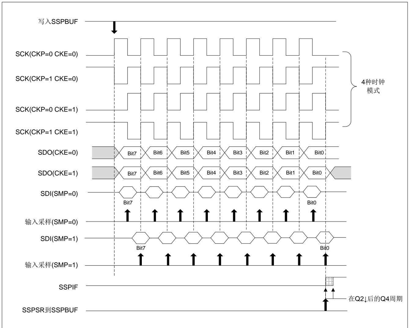
图 14-2: SPI 模式的波形 (主控模式)
