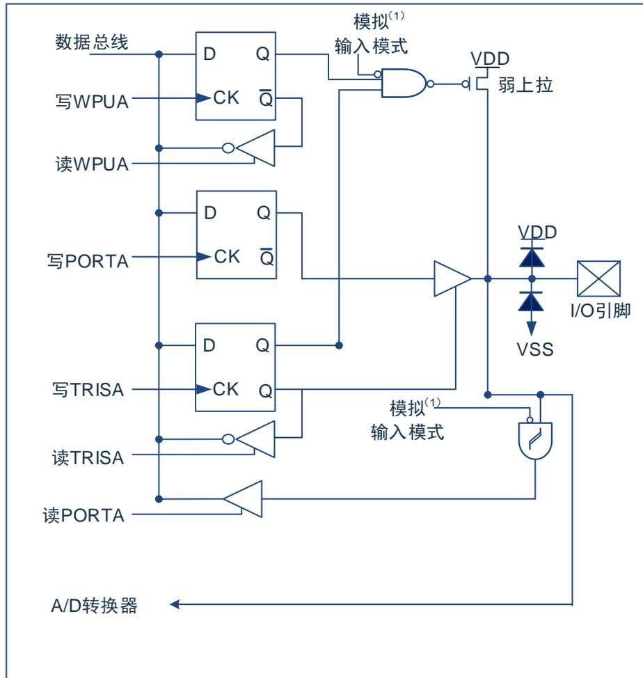
图 6-1: I/O 口结构图
