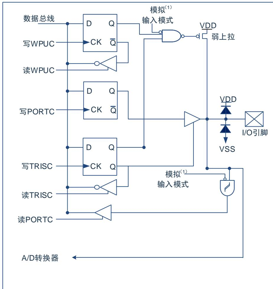
图 6-3: I/O 口结构图
