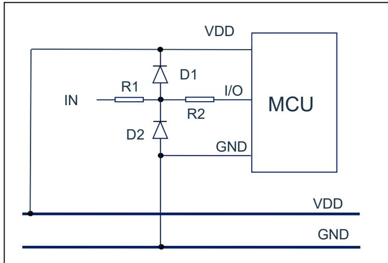
图 6-3：输入电压不在规定范围内采用电路
