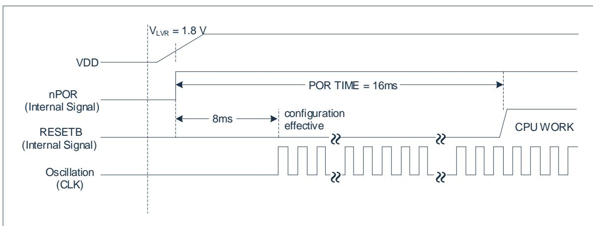
系统是否为上电复位可通过 PORF (WDCON.6) 标志位来判断。可置 PORF 标志位为 1 的复位类型有：上电复位、LVR 复位、上电监控复位、CONFIG 保护复位、外部复位、窗口看门狗复位。
