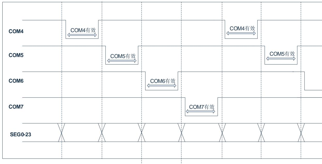
3) LED 配置 1/4DUTY、共阳驱动模式、COM\_SEL= 0、MODE1 模式，波形如下图所示：
