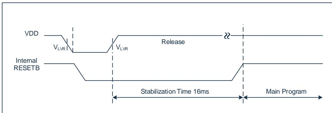
稳定时间（Stabilization Time）内芯片重新进行配置过程，与上电复位配置过程相同。
