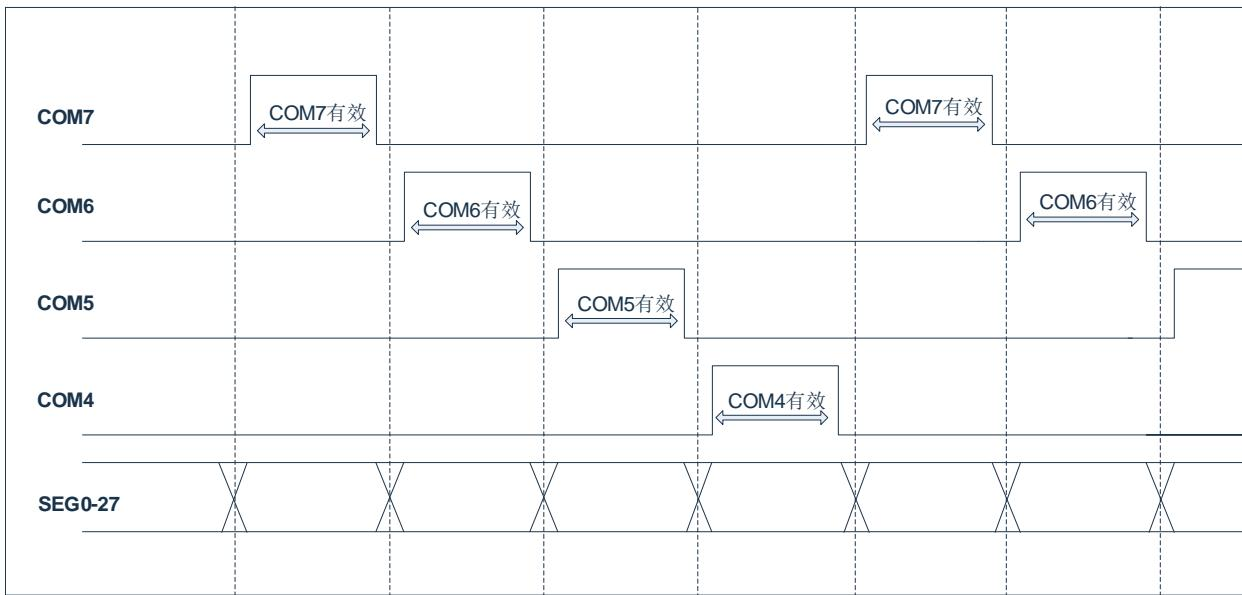
4) LED 配置 1/4DUTY、共阳驱动模式、COM\_SEL= 1、MODE1 模式，波形如下图所示：
