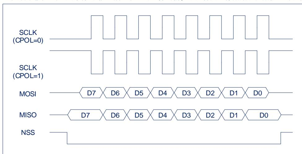
当 CPHA=0 时，NSS 线必须在每个连续的串行字节之间解除置 1 并重新置 1。此外，如果当 NSS 处于低电平，从机将数据写入 SPI 数据寄存器 (SPDR)，则会产生写冲突错误。当 CPHA = 1 时，NSS 线可能在连续传输之间保持低电平（可以始终保持低电平）。在具有单个固定主机和驱动 MISO 数据线的单个从机的系统中，这种格式有时是优先选择的。
