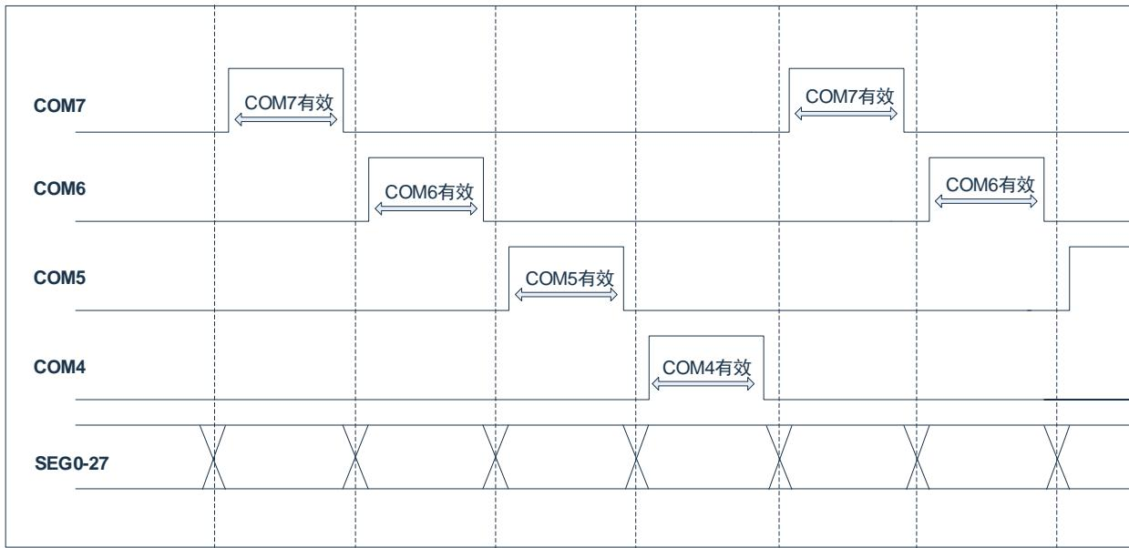
4) LED 配置 1/4DUTY、共阳驱动模式、COM\_SEL= 1、MODE1 模式，波形如下图所示：
