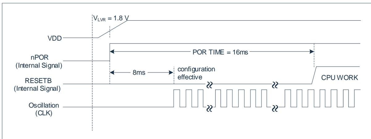
系统是否为上电复位可通过 PORF (WDCON.6) 标志位来判断。可置 PORF 标志位为 1 的复位类型有：上电复位、LVR 复位、外部复位、CONFIG 保护复位。
