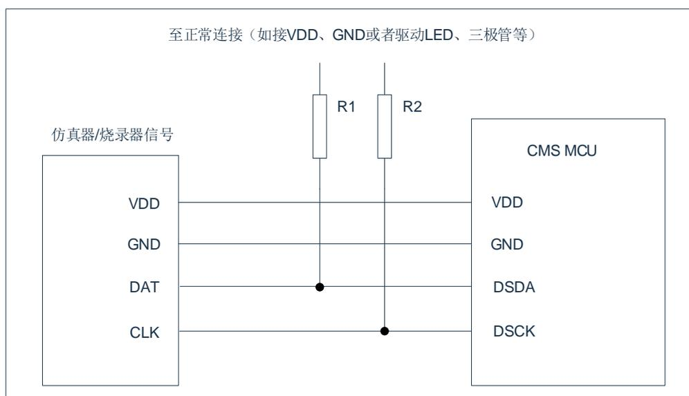
上图中，R1、R2 为电气隔离器件，常以电阻代替，其阻值如下：R1 $\geq$ 4.7K、R2 $\geq$ 4.7K。
