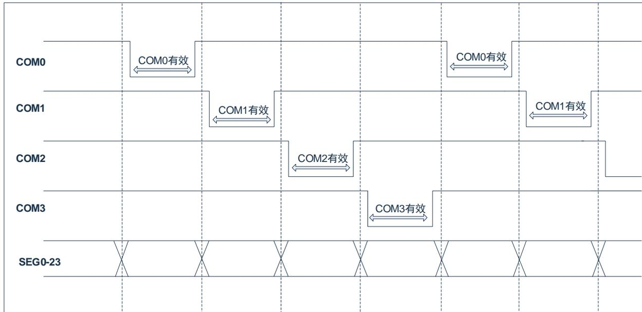
2) LED 配置 1/4DUTY、共阴驱动模式、COM\_SEL= 1、MODE0 模式，波形如下图所示：
