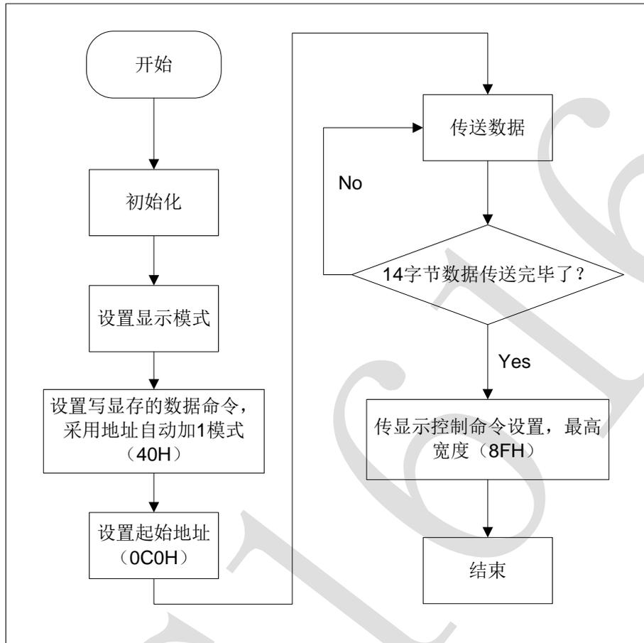
2) 采用固定地址的程序设计流程图:
