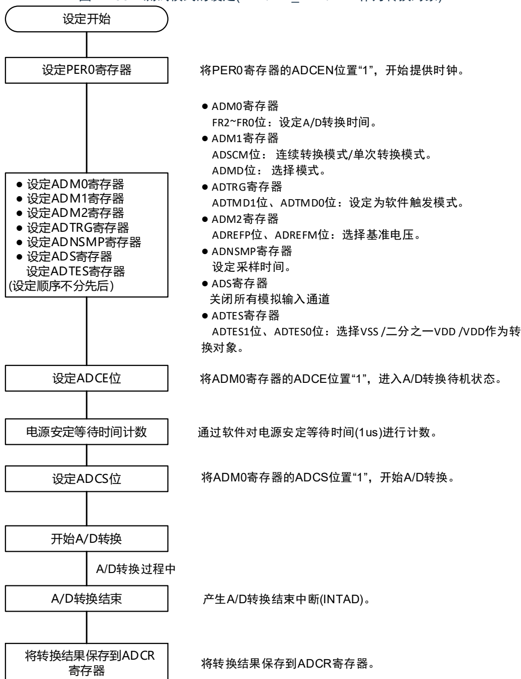
图 11-36 测试模式的设定(VSS/half_VDD/VDD作为转换对象)
