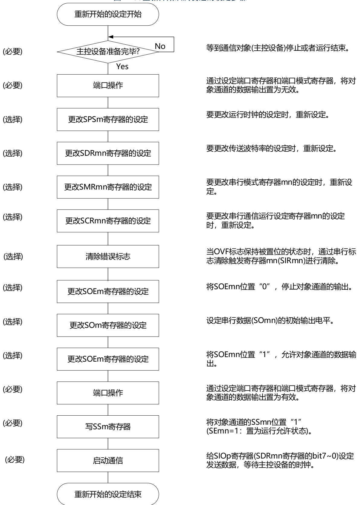
图14-50重新开始从属发送的设定步骤
