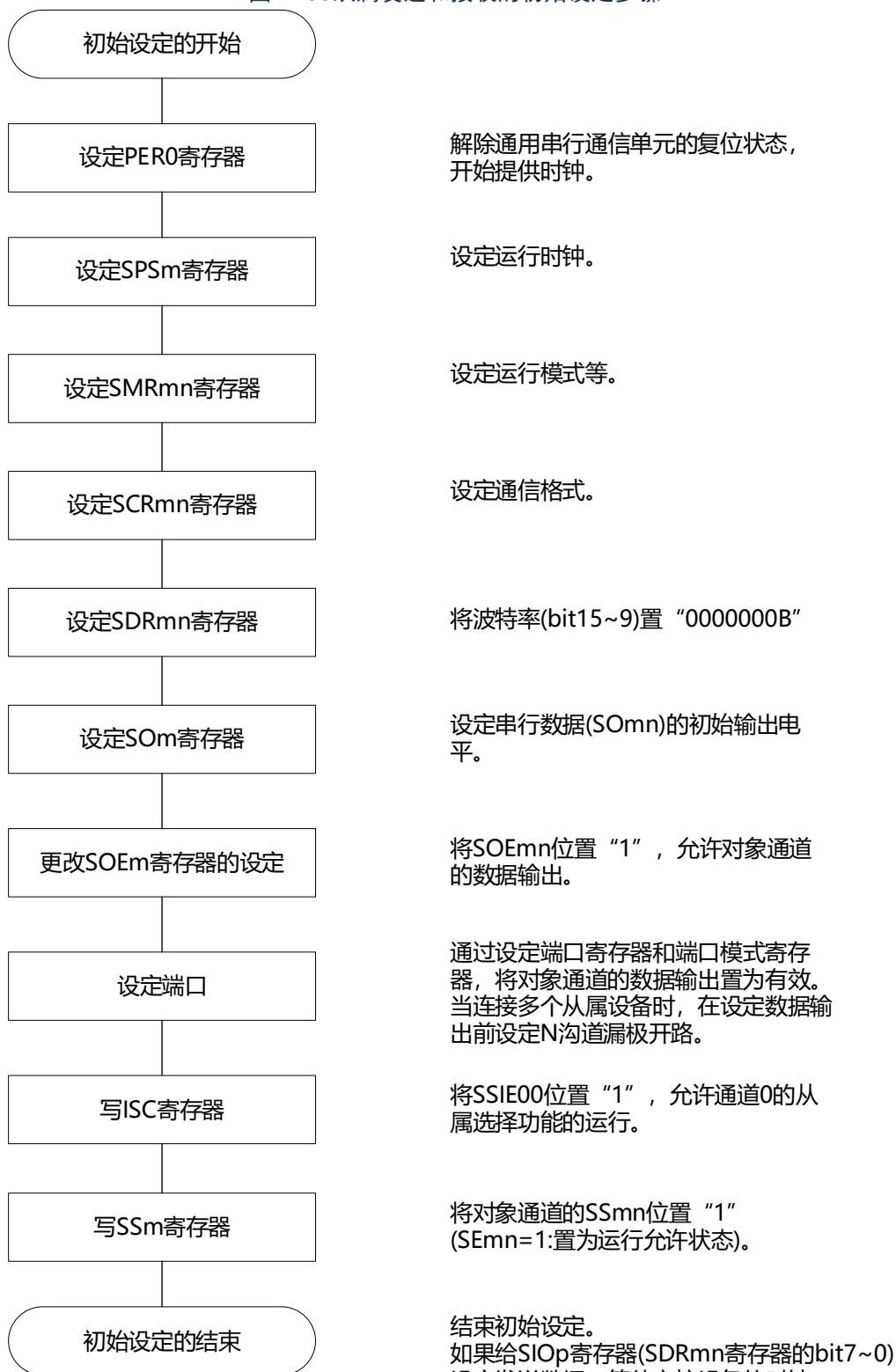
图14-88从属发送和接收的初始设定步骤
