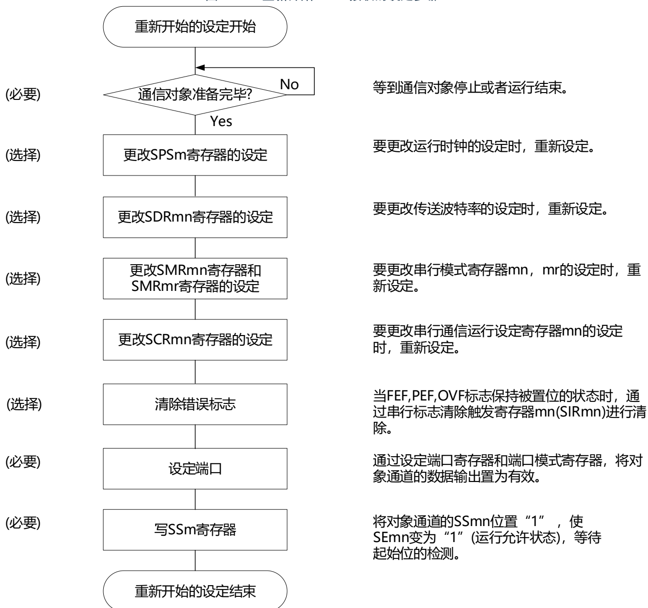
图14-107 重新开始UART接收的设定步骤
