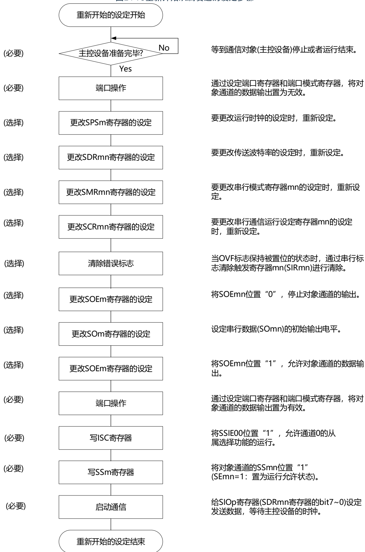
图14-75重新开始从属发送的设定步骤
