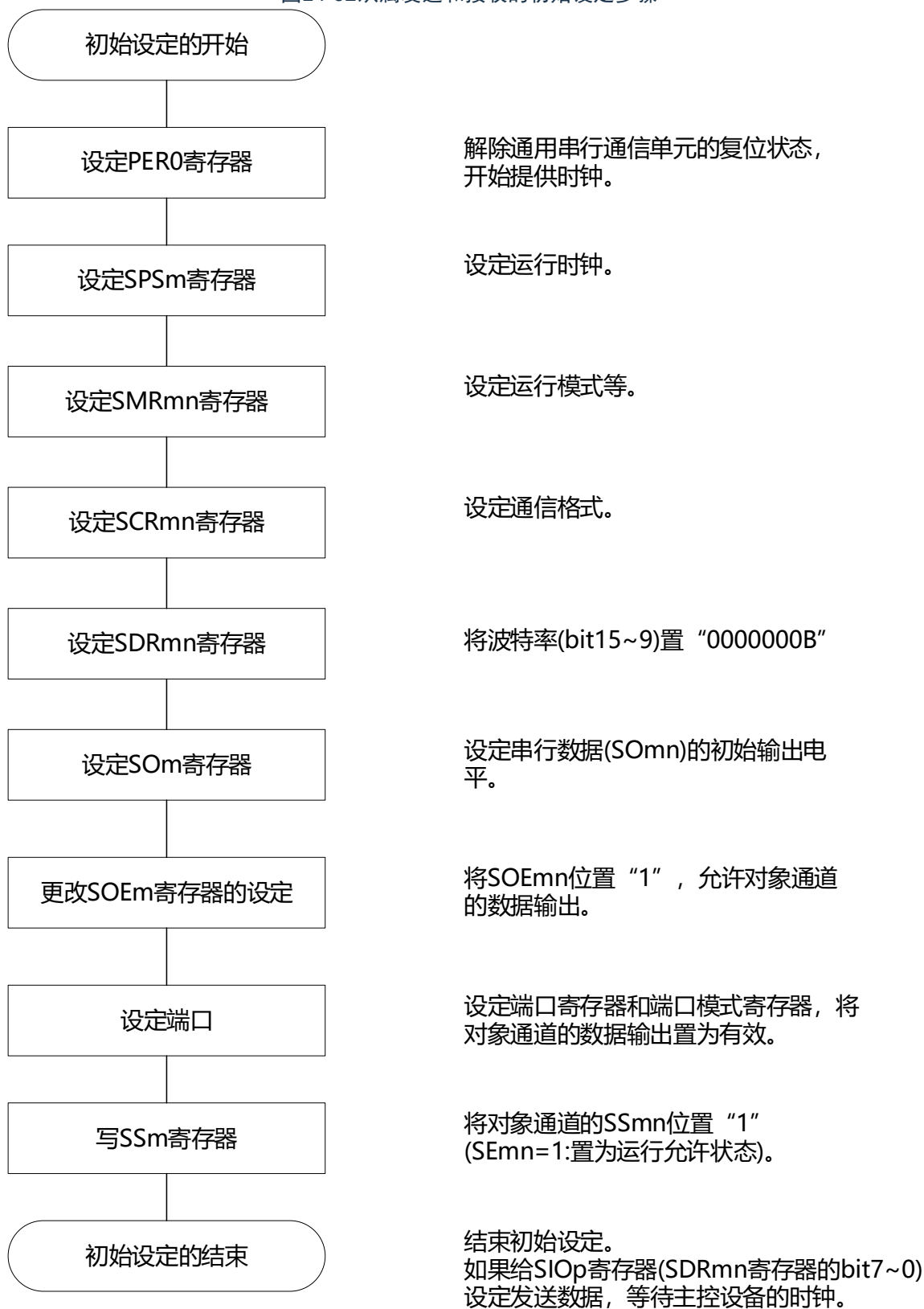
图14-62从属发送和接收的初始设定步骤
