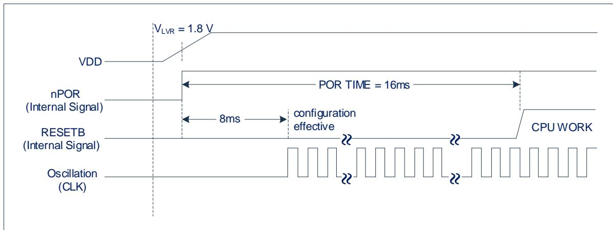
系统是否为上电复位可通过 PORF (WDCON.6) 标志位来判断。可置 PORF 标志位为 1 的复位类型有：上电复位、LVR 复位、上电监控复位、CONFIG 保护复位、外部复位。
