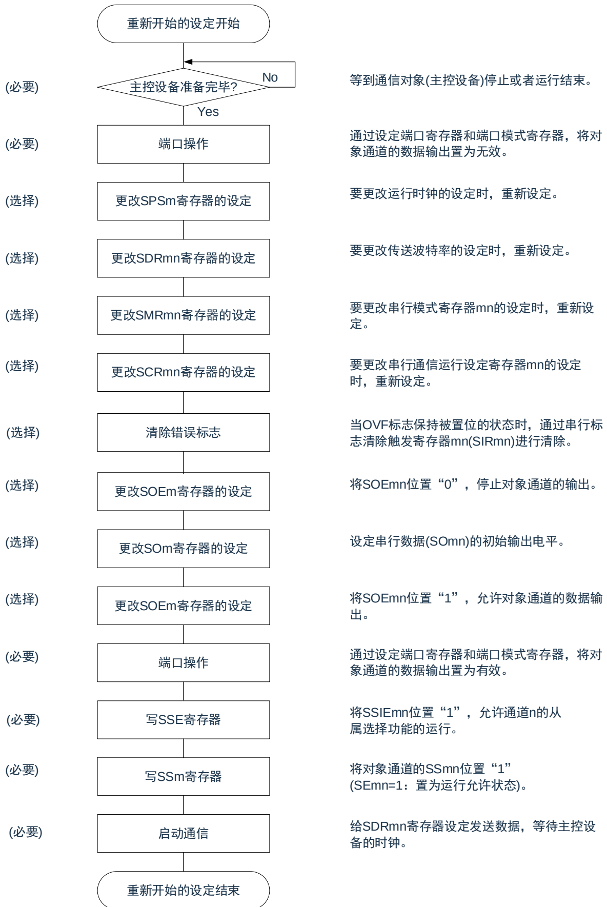
图 16-75：重新开始从属发送的设定步骤
