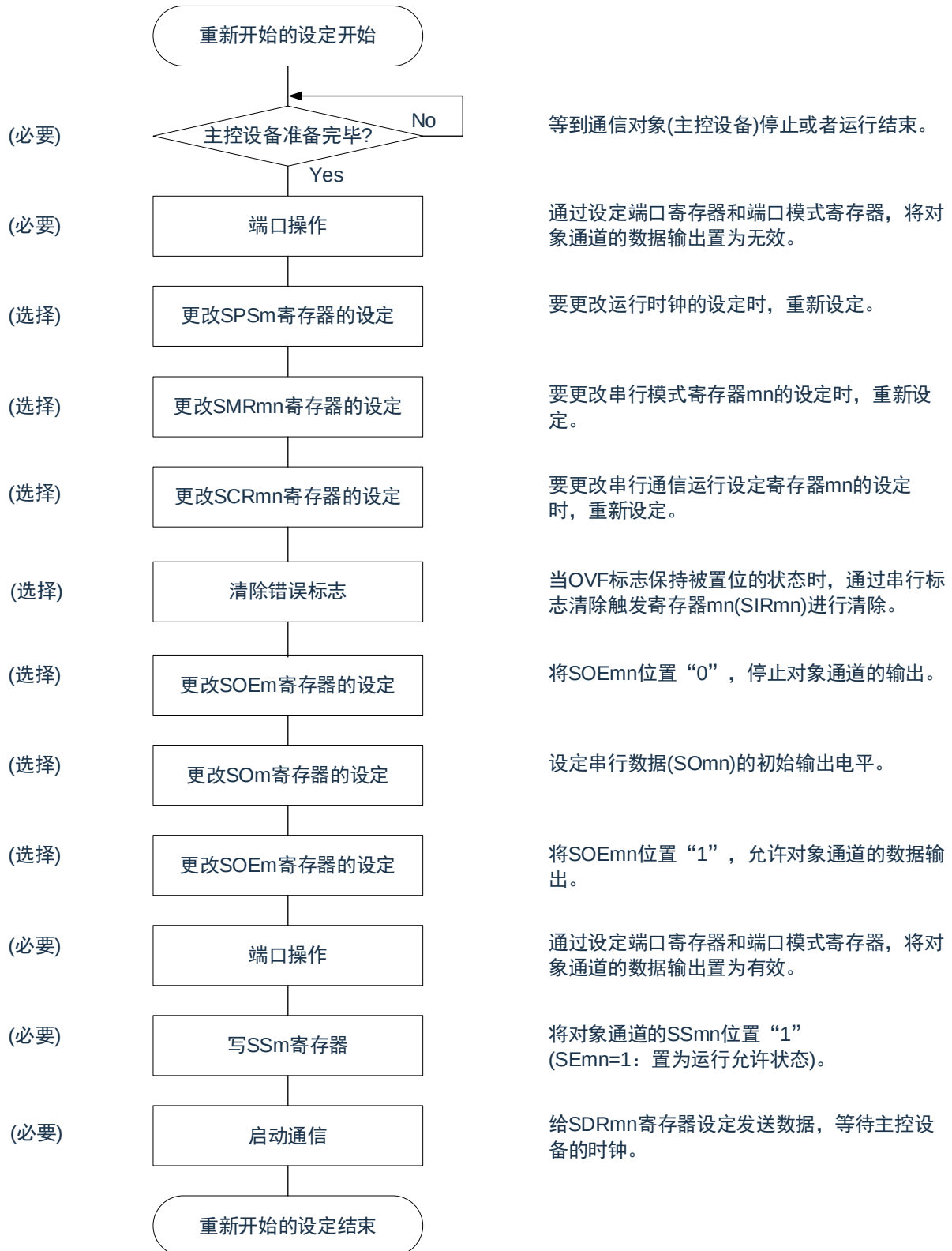
图 16-64：重新开始从属发送和接收的设定步骤
