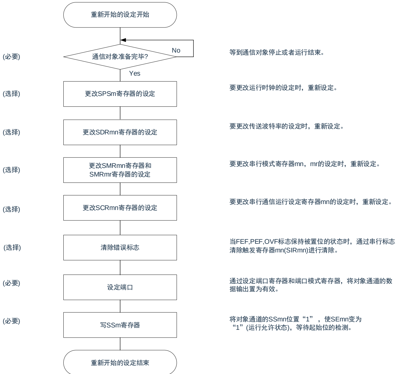
图 16-107: 重新开始 UART 接收的设定步骤
