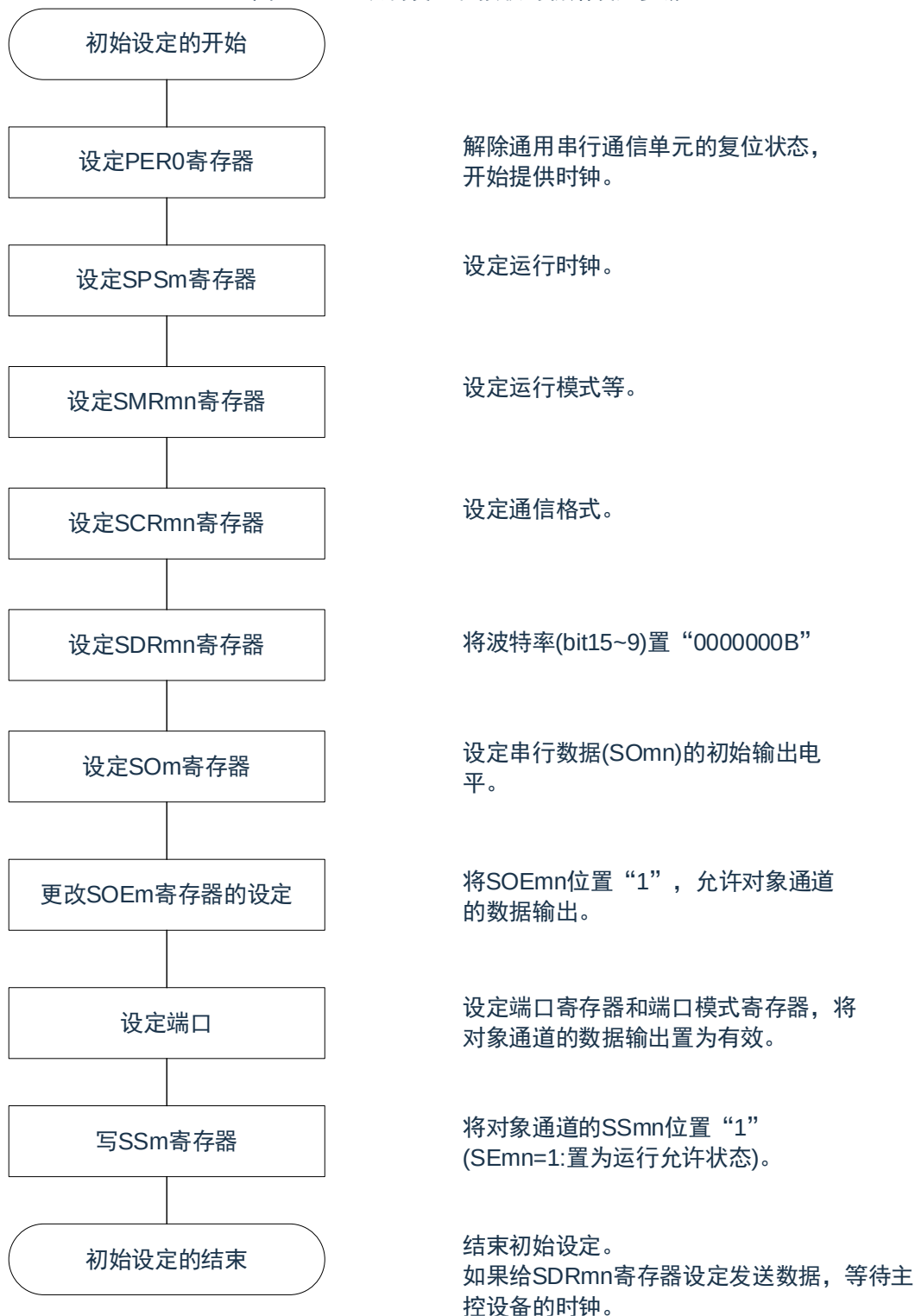
图 16-62：从属发送和接收的初始设定步骤
