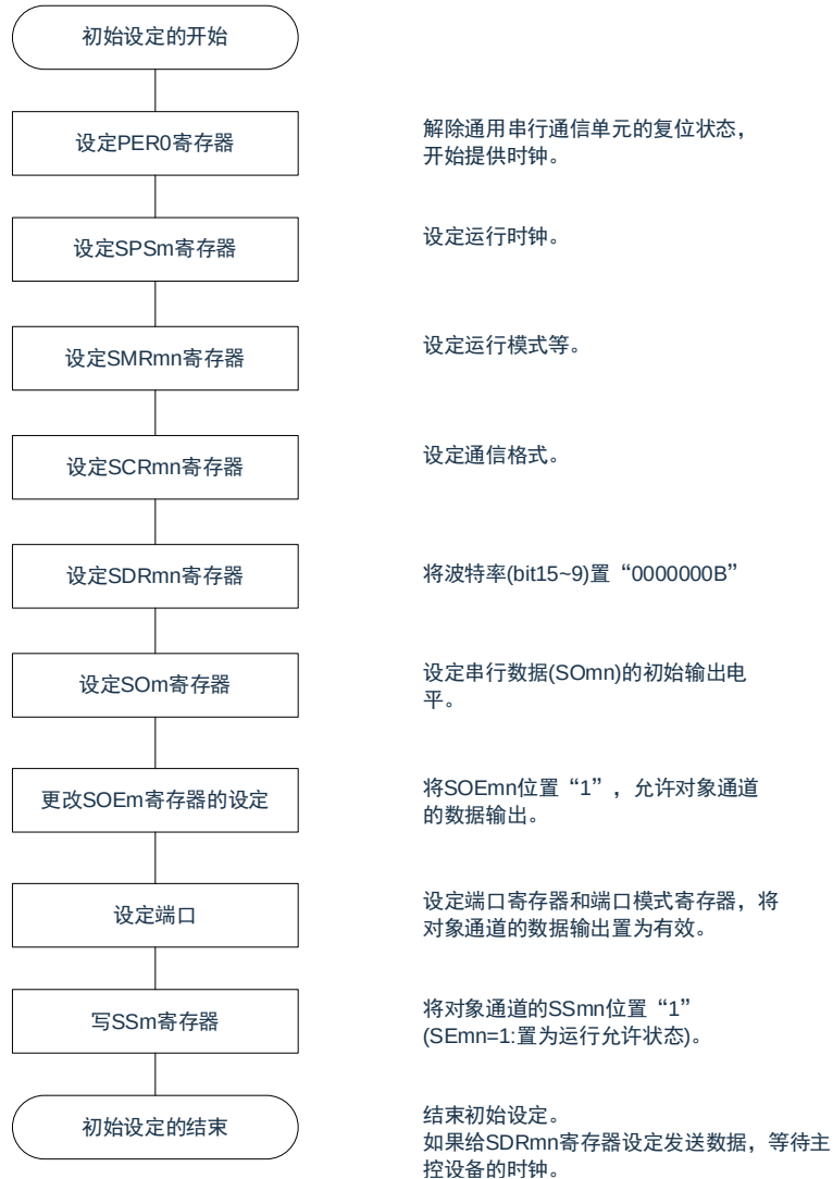
图 16-48：从属发送的初始设定步骤
