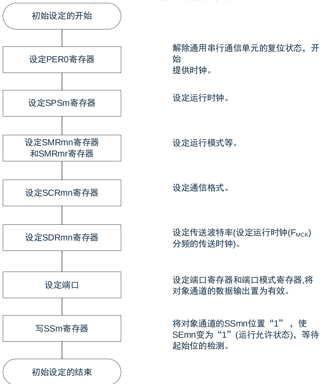
图 16-105: UART 接收的初始设定步骤
