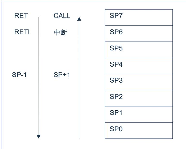
图 2-2: 堆栈缓存器工作原理
