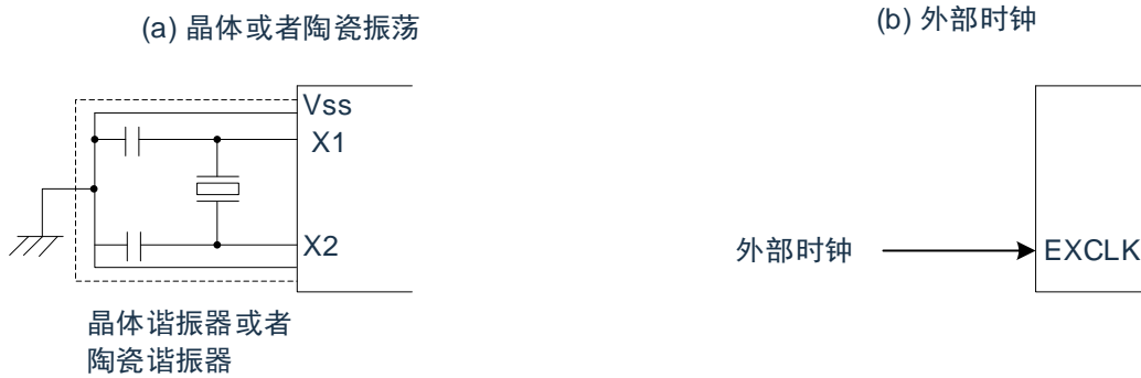
图4-2：X1振荡电路的外接电路例子
