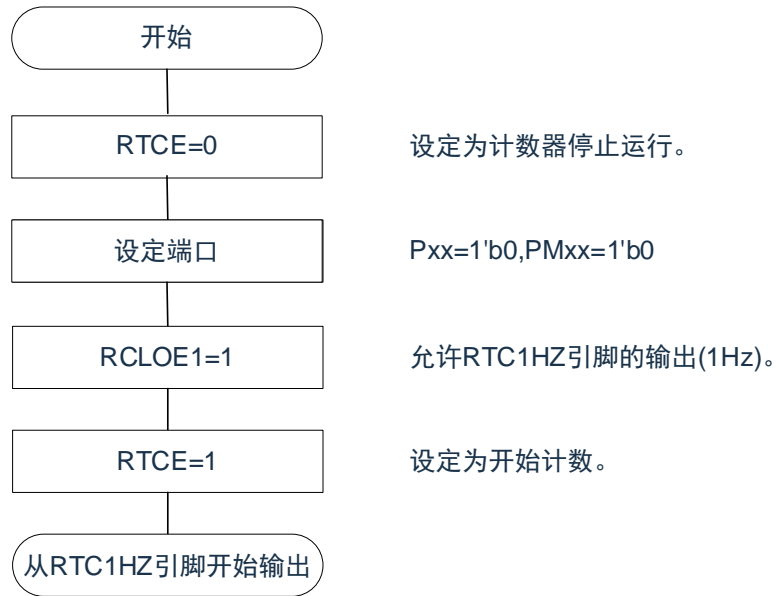
图7-7: 1Hz输出的设定步骤
