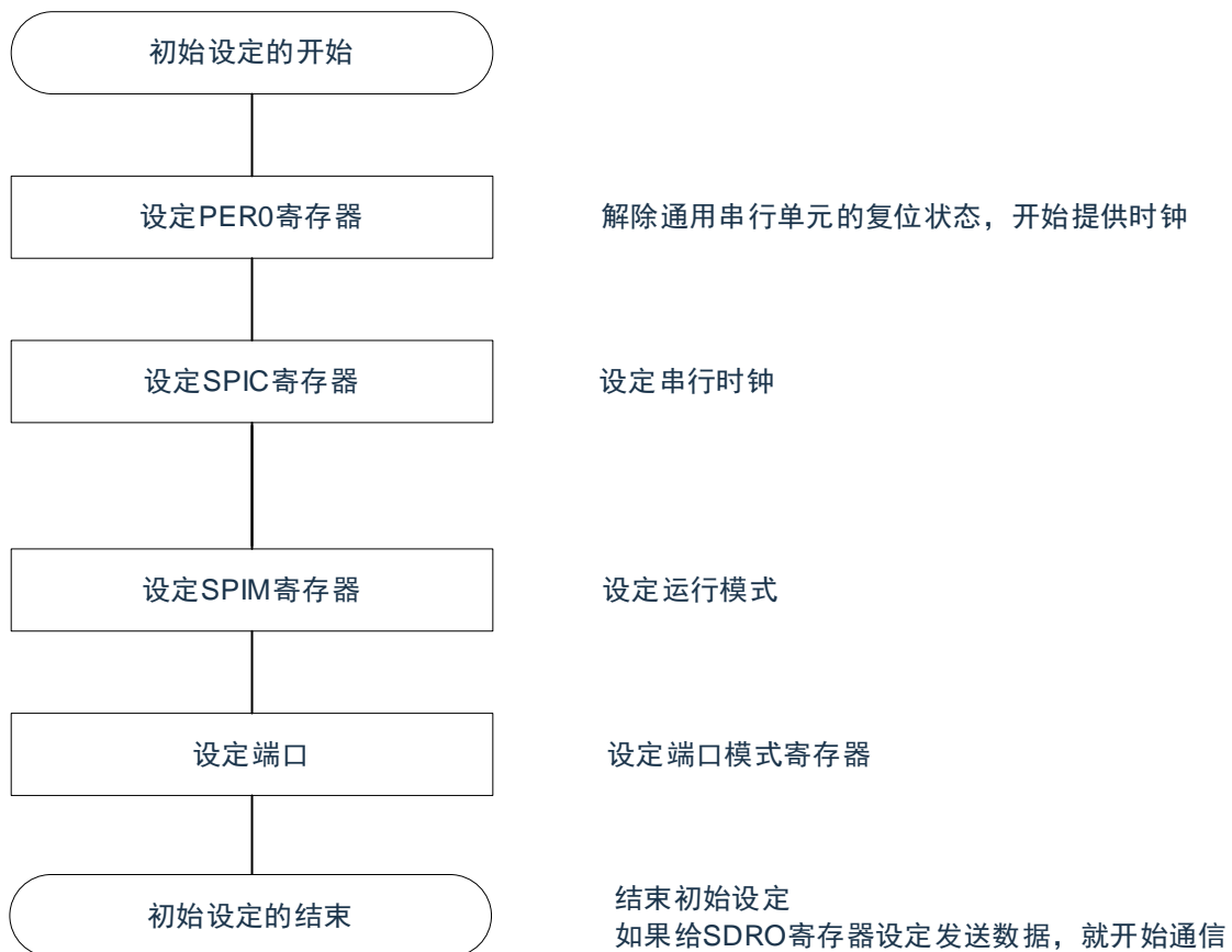
图 13-2: 主控发送/接收的初始设置步骤
