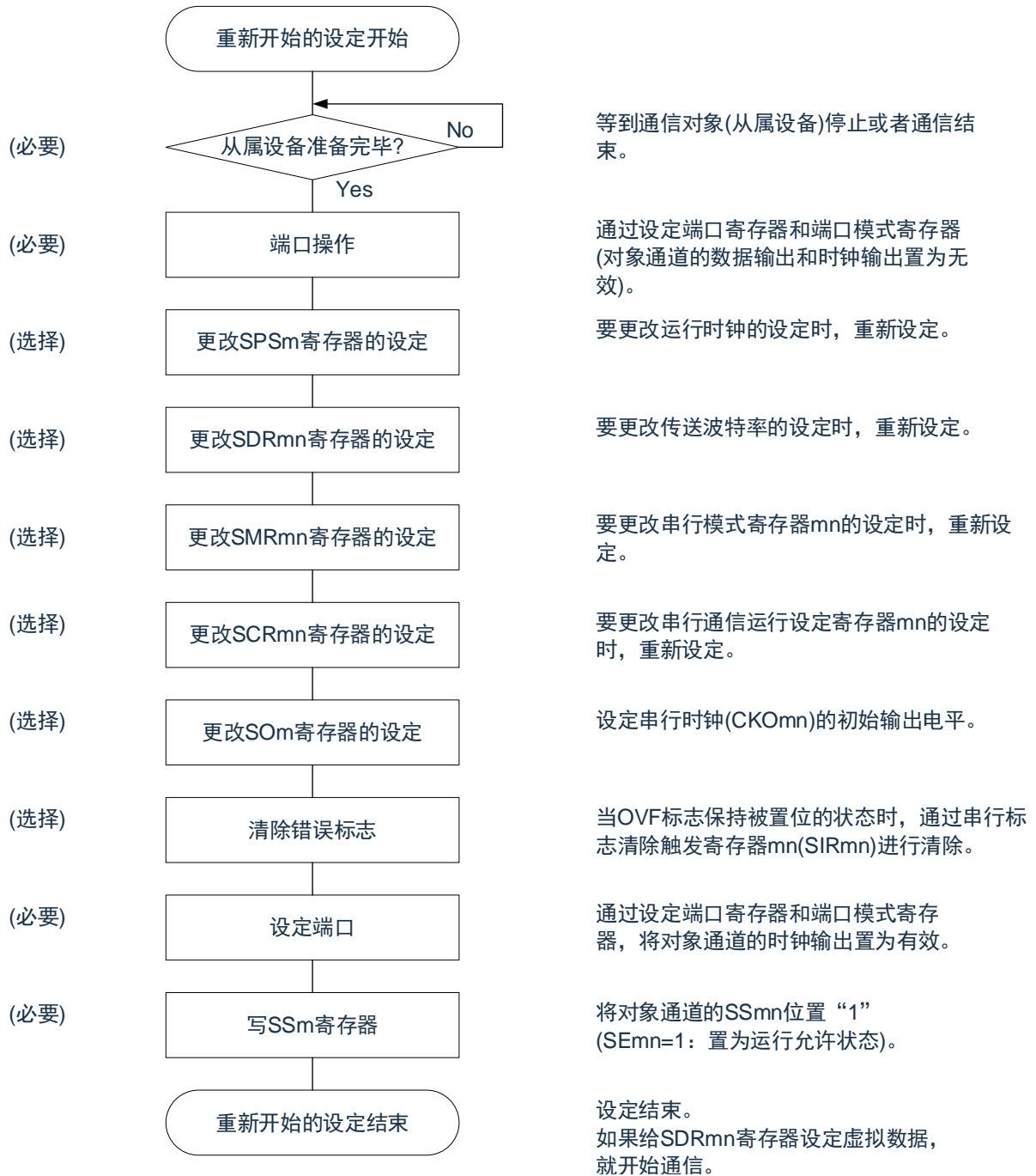
图 12-14: 重新开始主控接收的设定步骤
