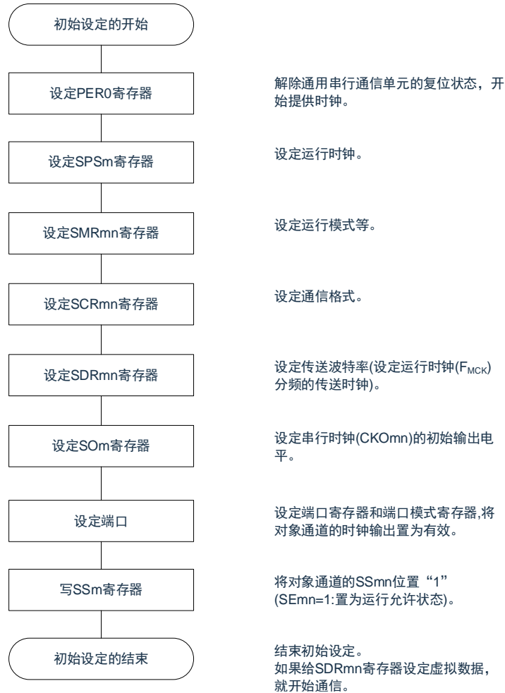
图 12-12: 主控接收的初始设定步骤
