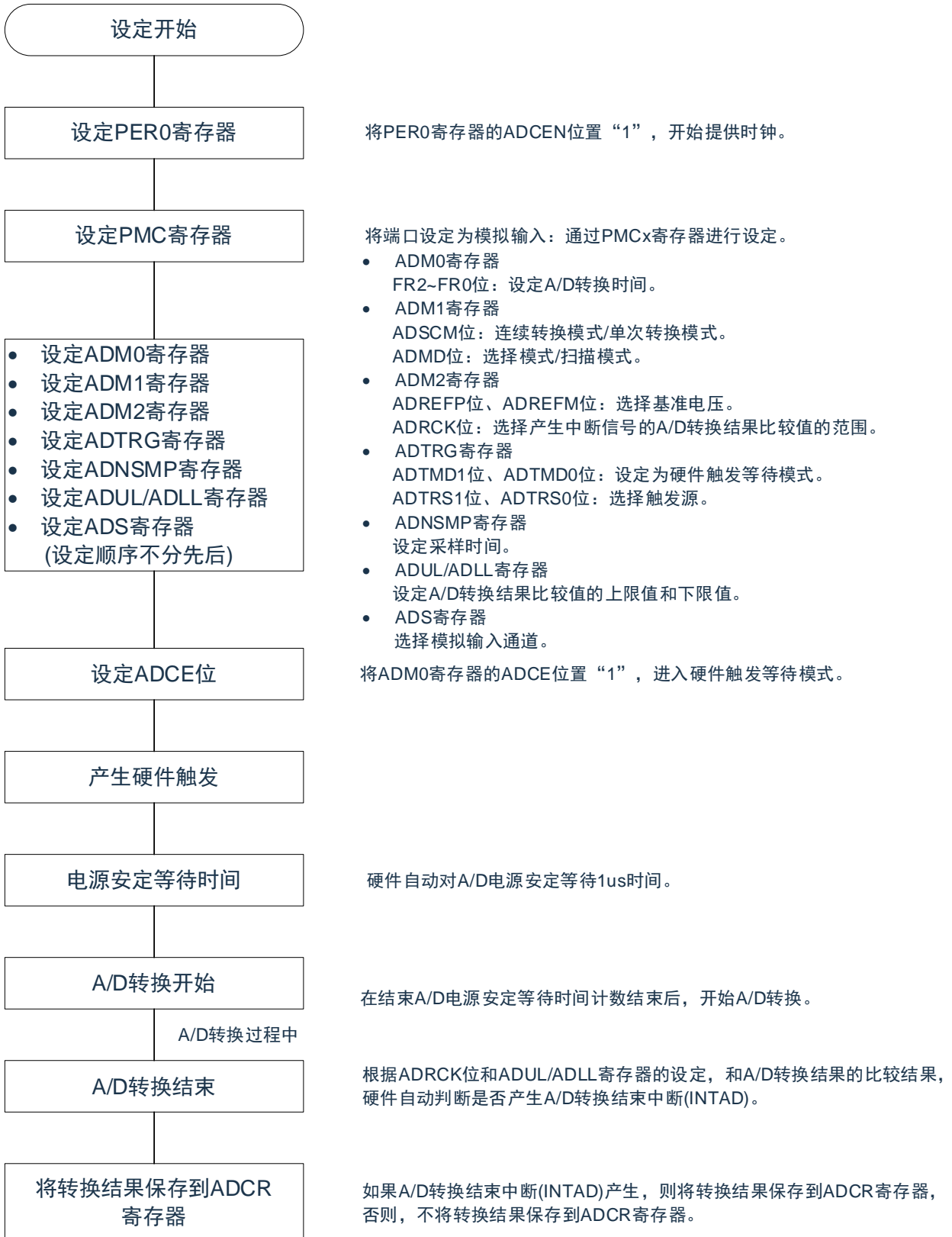
图11-19：硬件触发等待模式的设定
