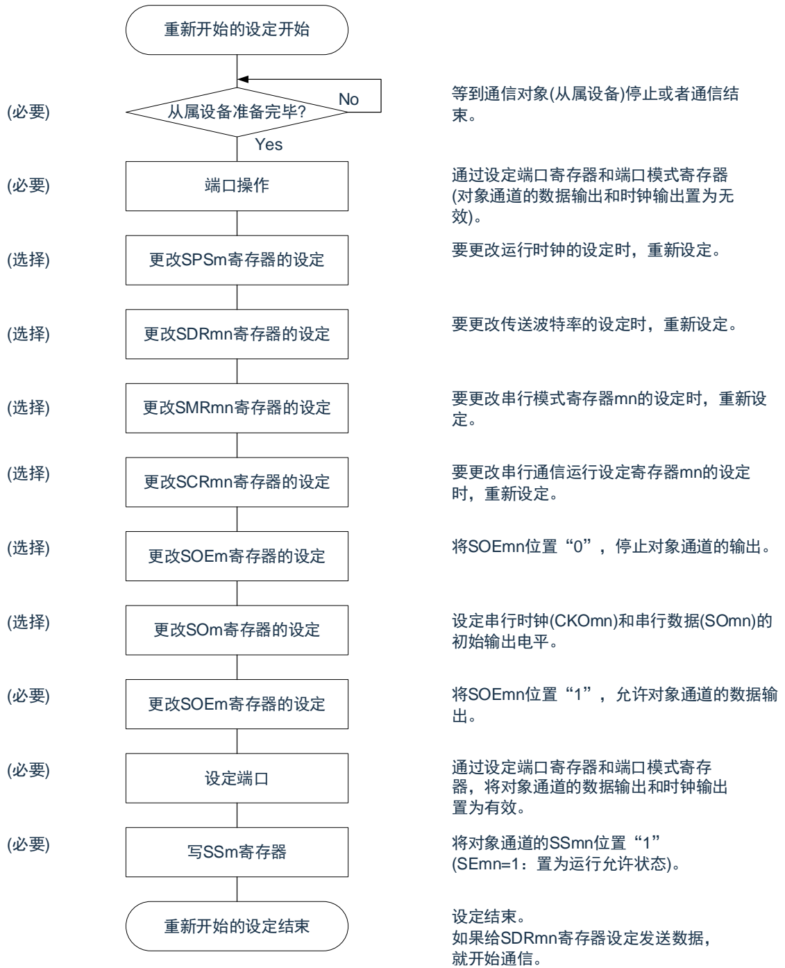
图 12-6: 重新开始主控发送的设定步骤
