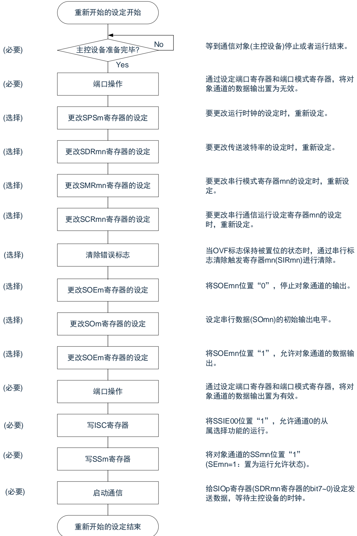
图12-75 重新开始从属发送的设定步骤
