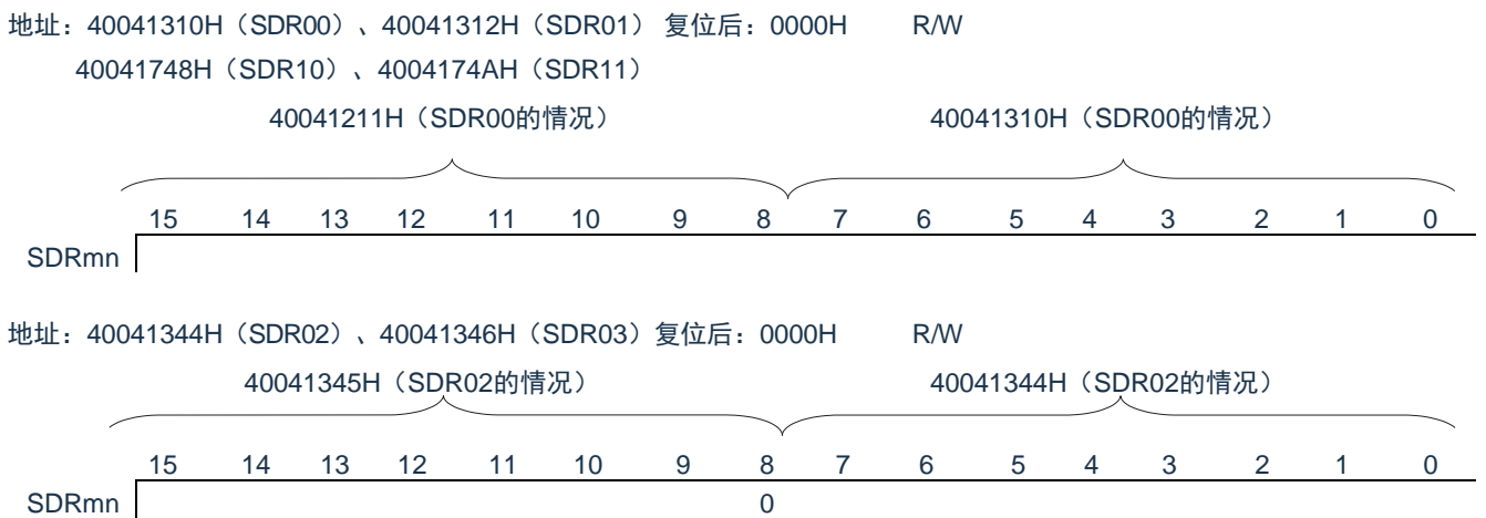
图12-9 串行数据寄存器mn (SDRmn) 的格式
