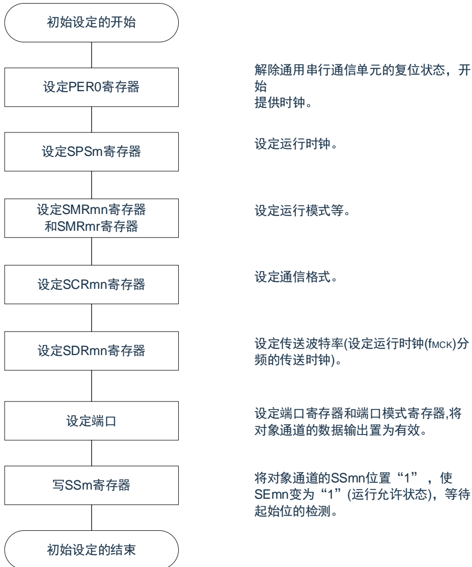
图12-105 UART接收的初始设定步骤
