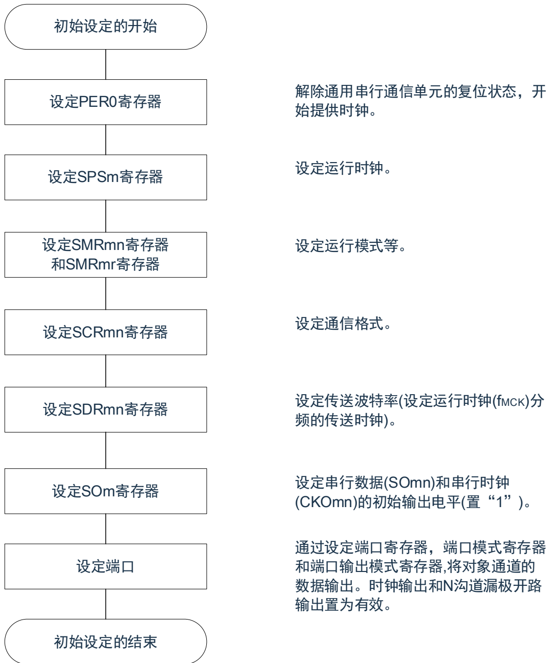
图12-119 地址段发送的初始设定步骤
