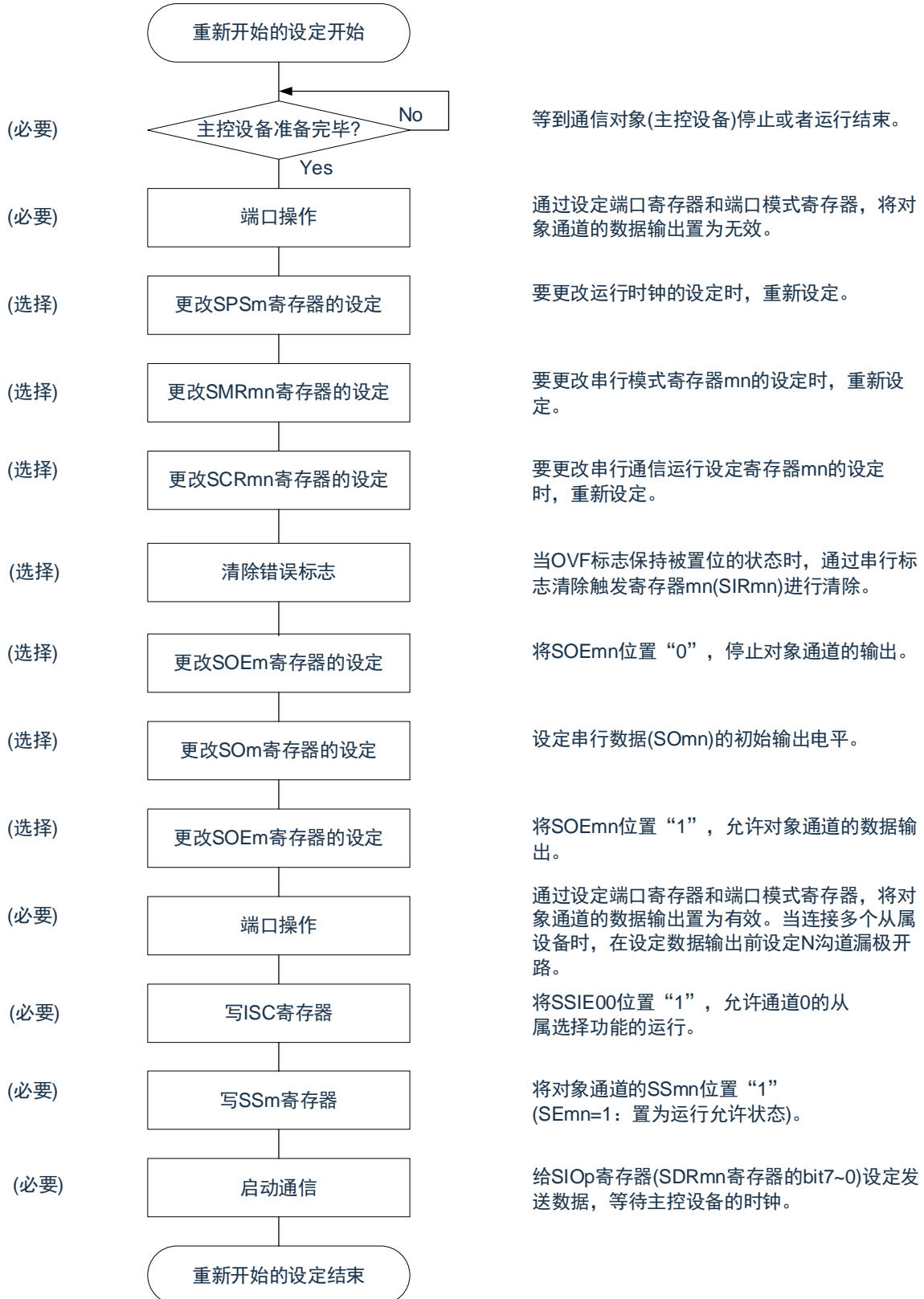
图12-90 重新开始从属发送和接收的设定步骤
