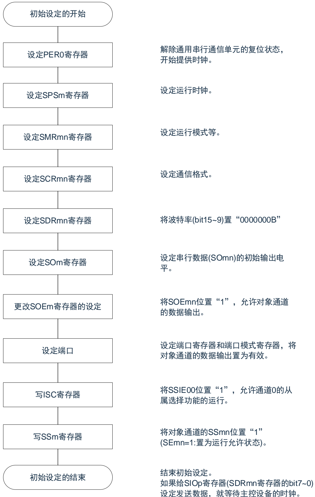
图12-73 从属发送的初始设定步骤
