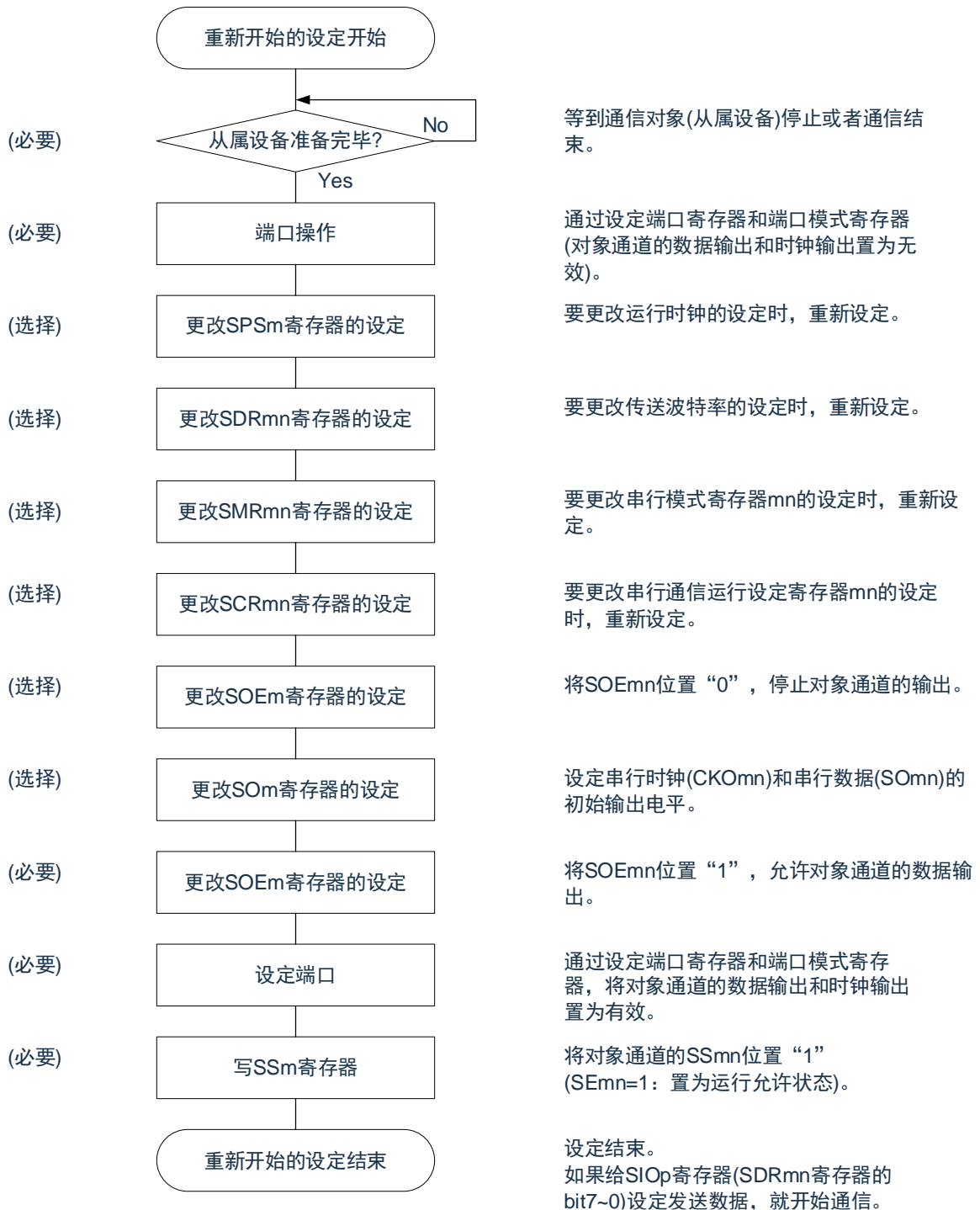
图12-26 重新开始主控发送的设定步骤
