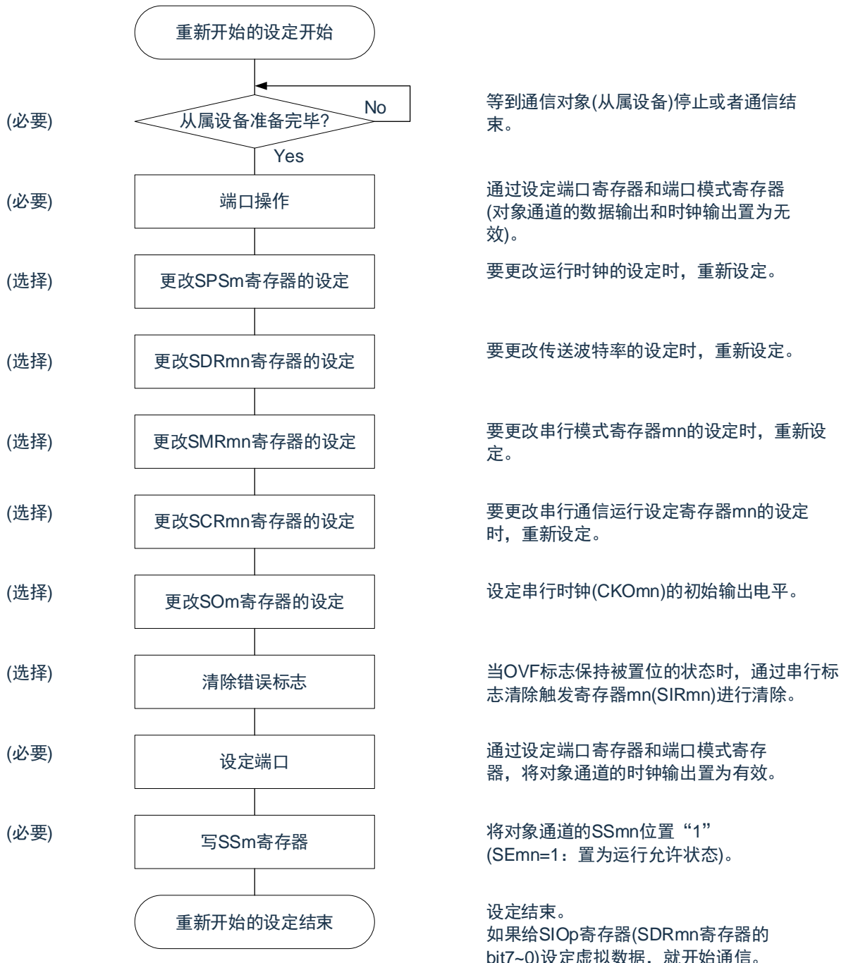
图12-34 重新开始主控接收的设定步骤
