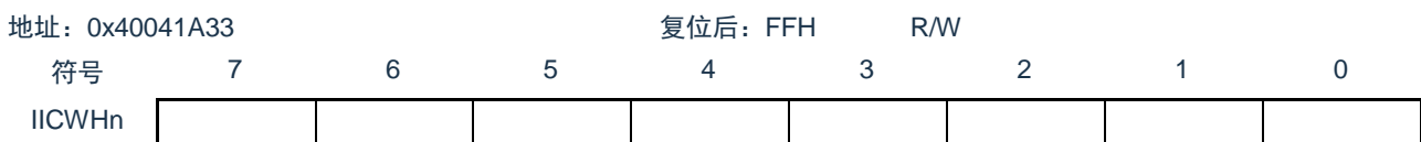
图14-11 IICA高电平宽度设定寄存器n (IICWHn) 的格式
