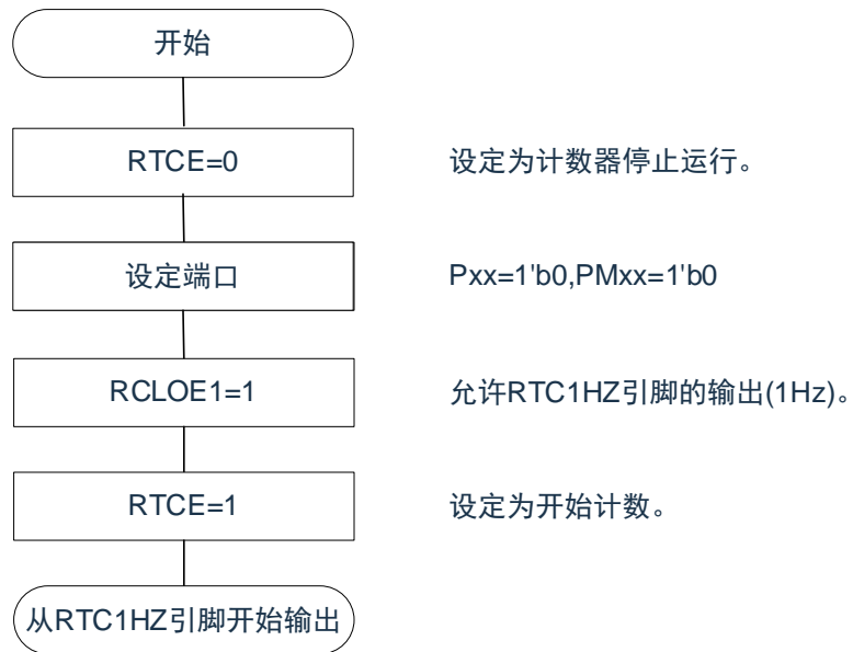
图7-22 1Hz输出的设定步骤
