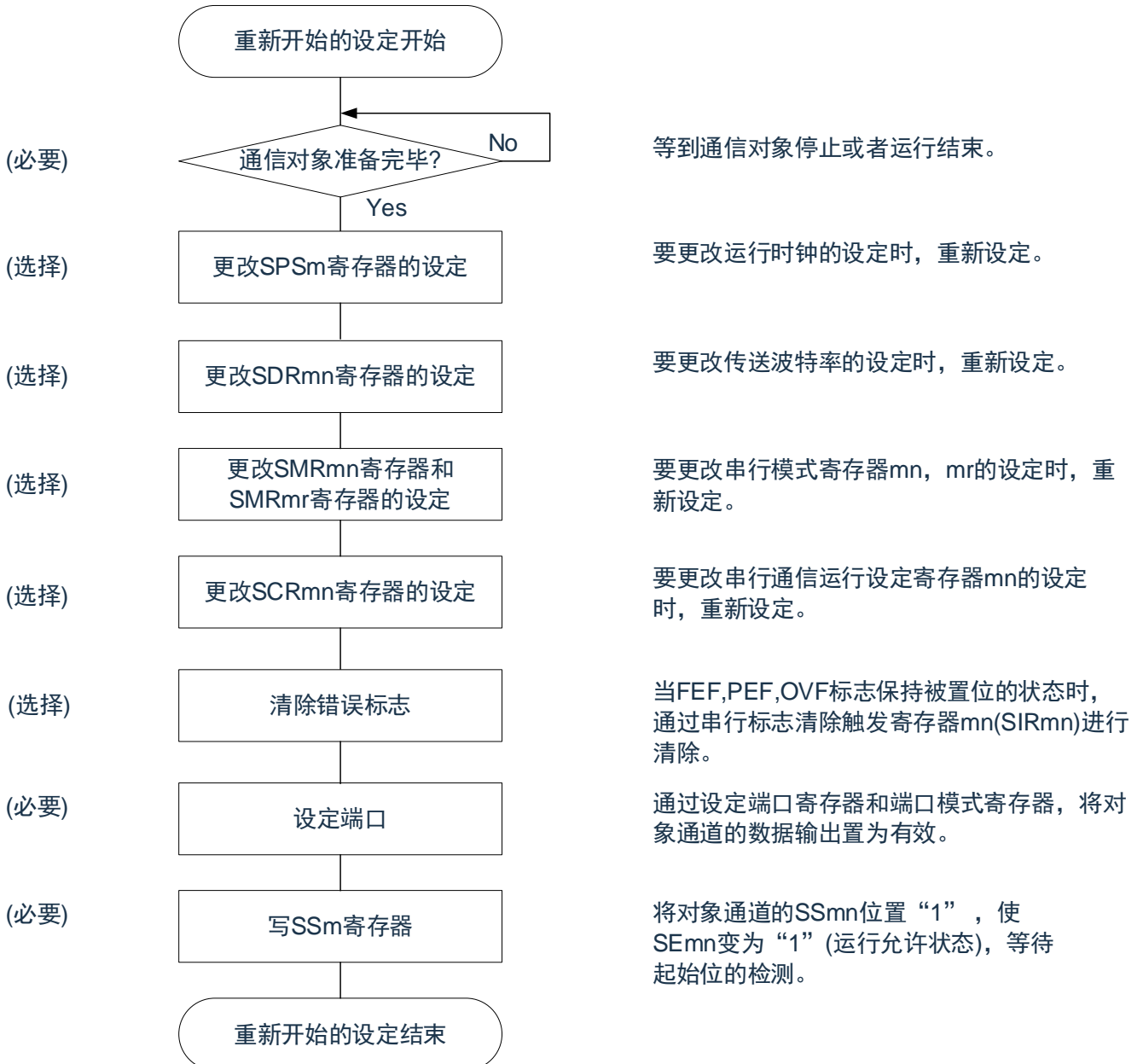
图12-107 重新开始UART接收的设定步骤
