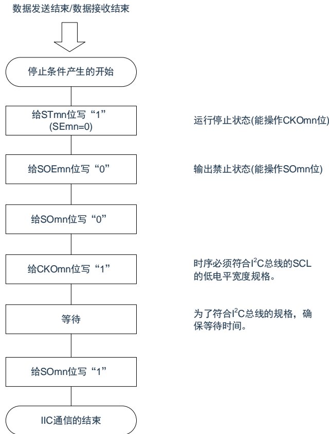
图12-129 产生停止条件的流程图
