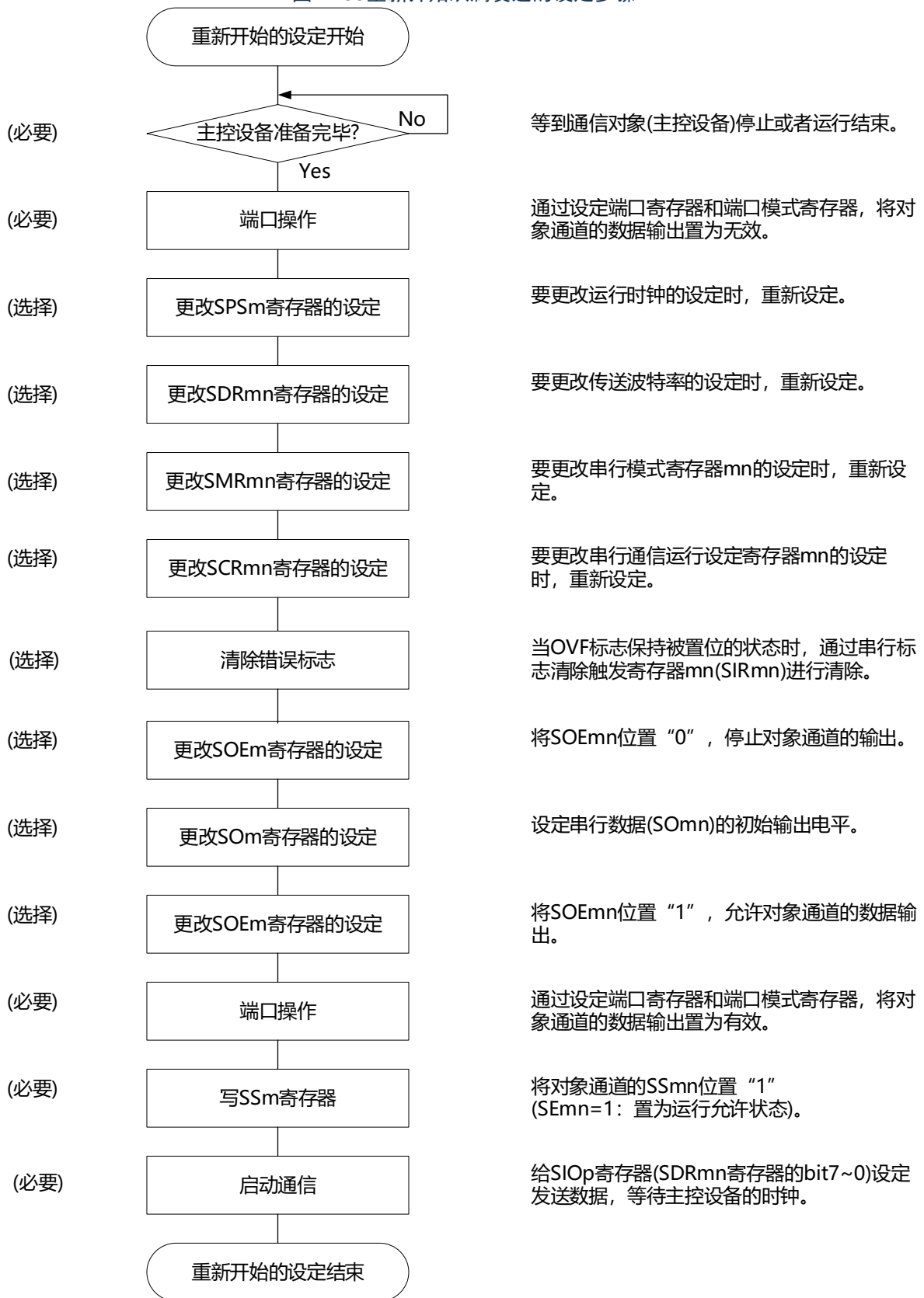
图14-50重新开始从属发送的设定步骤
