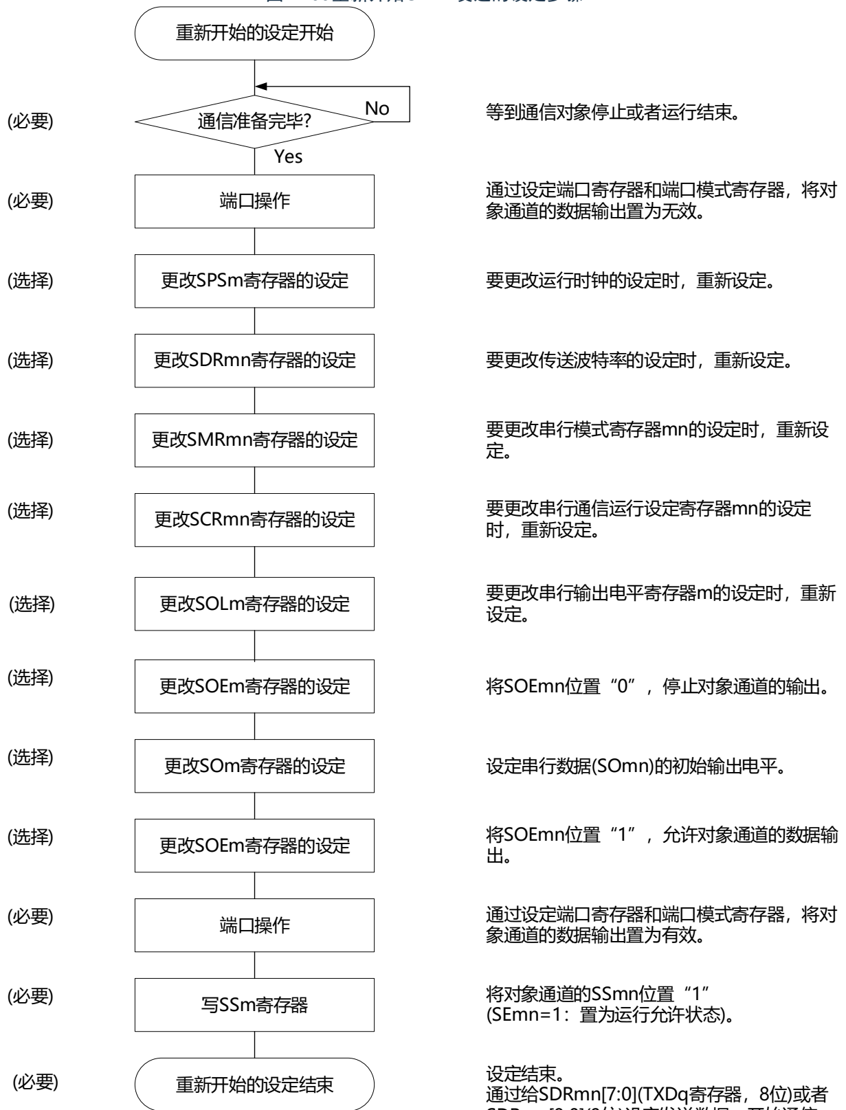
图14-99重新开始UART发送的设定步骤
