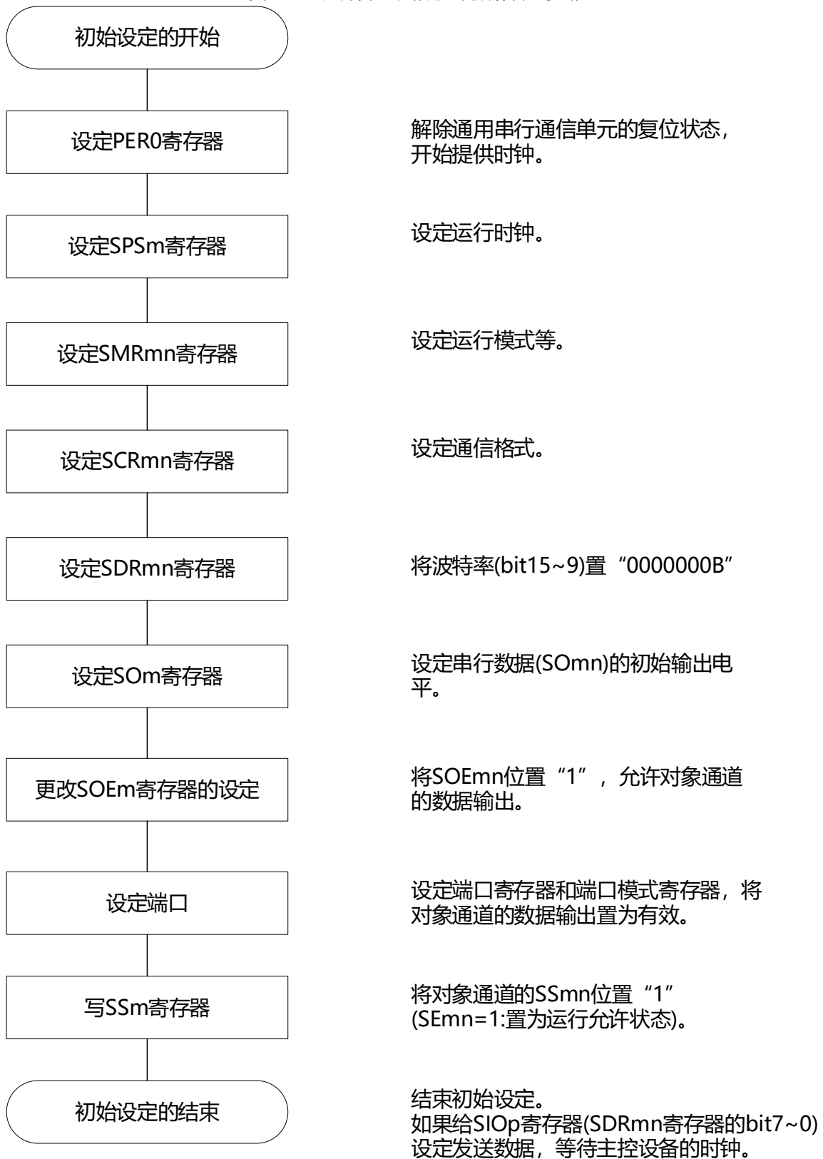
图14-62从属发送和接收的初始设定步骤
