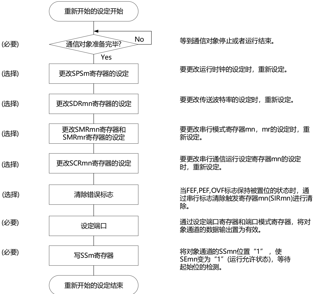
图14-107 重新开始UART接收的设定步骤
