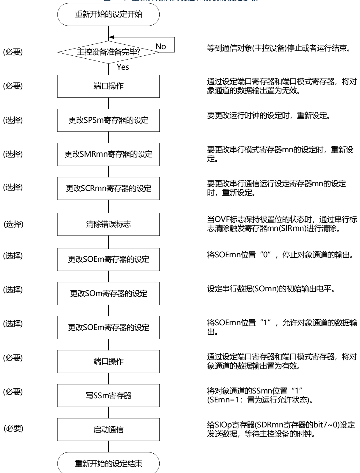
图14-64重新开始从属发送和接收的设定步骤
